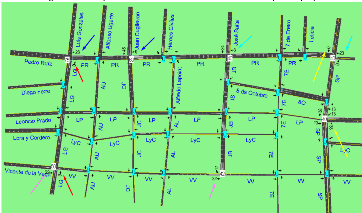
Figura 37. Tiempo de desfase entre semáforos de la red vial para la propuesta
