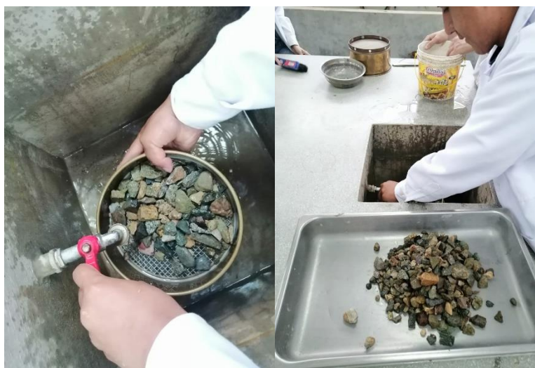
Figura N°13: Lavado del agregado grueso para ensayo de peso específico
