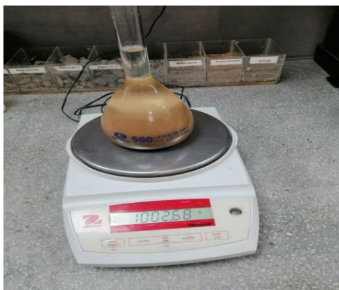
Figura N°8: Picnómetro con agregado fino
