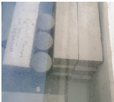
Figura N°30: Vigas de concreto en agua hasta el día de su ensayo
