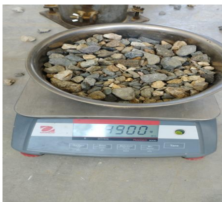
Figura N°14: Peso de agregado grueso seco
