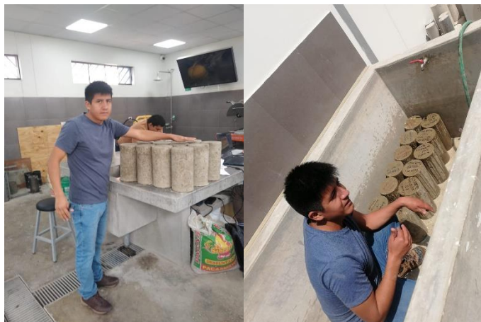
Figura N°25: Curado de probetas de concreto
