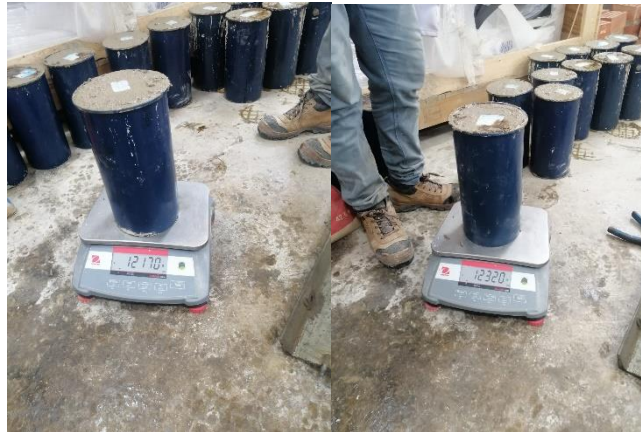
Figura N°23: Peso unitario del concreto fresco
