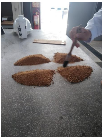
Figura N°35: Cuarteo de la muestra de agregado fino
