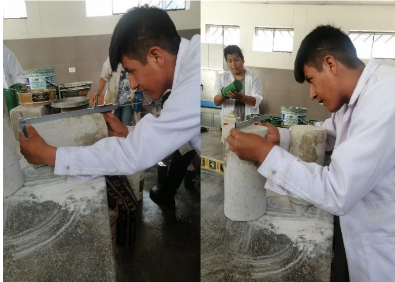
Figura N°27: Toma de medidas de testigos cilíndricos de concreto
