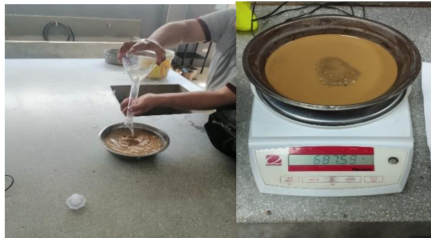
Figura N°10: Peso de la muestra de agregado fino retirada del picnómetro
