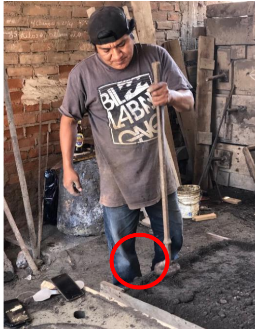
Figura 57. Operario alisando arena del molde
