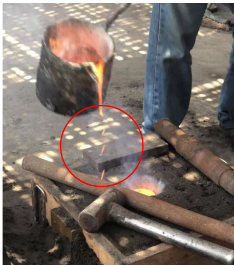
Figura 42. Derrames de bronce fundido por cansancio del operario
