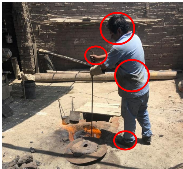
Figura 100. Operario 1 sin EPP'S expuestos a factores de riesgo Fuente: San Simón S. A. C.
