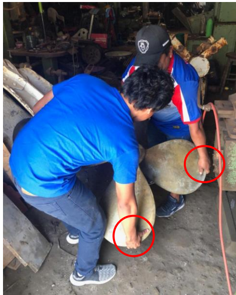
Figura 87. Operario cargando molde de arena Fuente: San Simón S. A. C.
