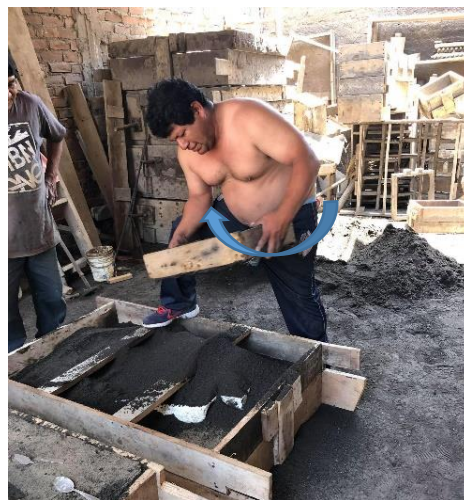
Figura 51. Operario tamizando arena
