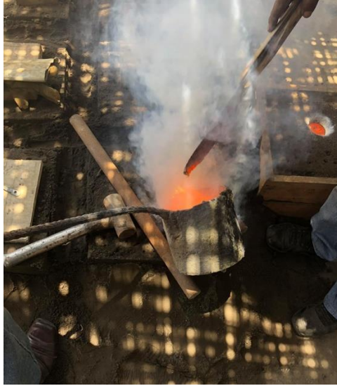
Figura 142. Proceso de vaciado actual
