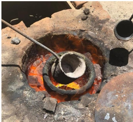
Figura 92. Recogido del bronce fundido con una cuchara
