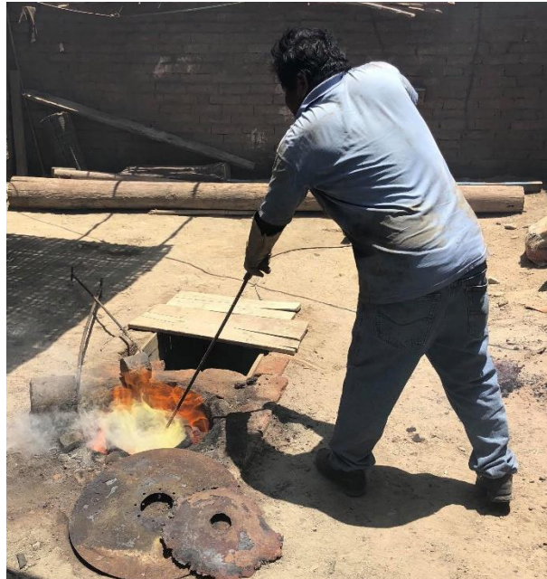
Figura 90. Operario removiendo el bronce Fuente: San Simón S. A. C.
