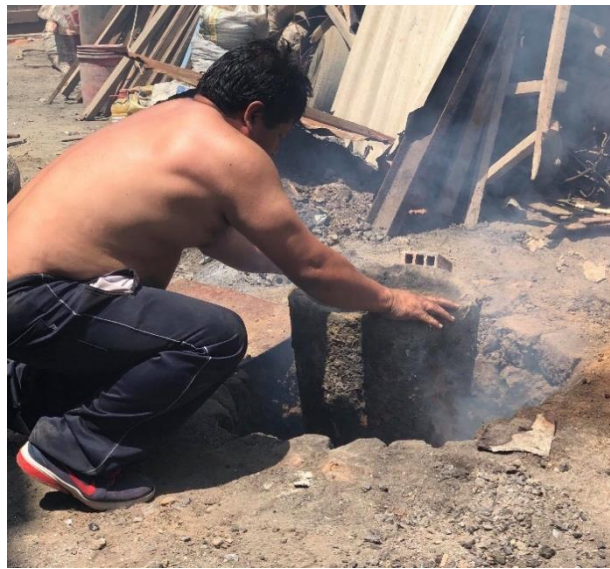
Figura 89. Operario colocando el horno de crisol
