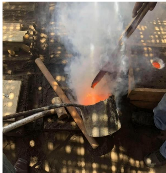
Figura 94. Traslado del bronce fundido Fuente: San Simón S. A. C.
