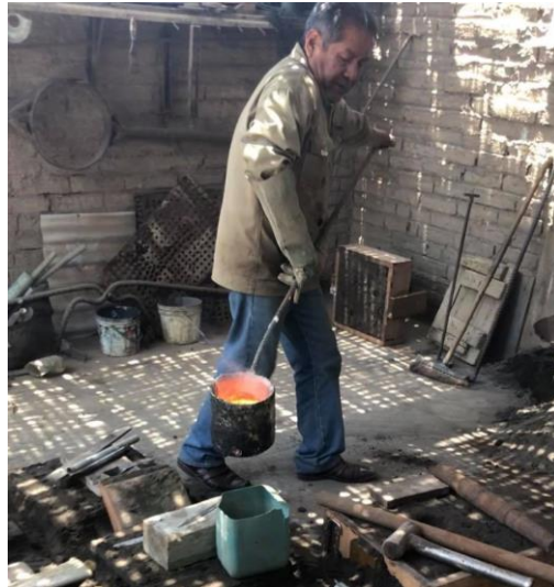
Figura 93. Traslado del bronce fundido Fuente: San Simón S. A. C.
