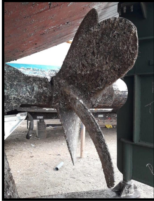
Figura 11. Efecto de la corrosión galvánica
