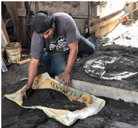
Figura 55. Operario alisando arena de molde
