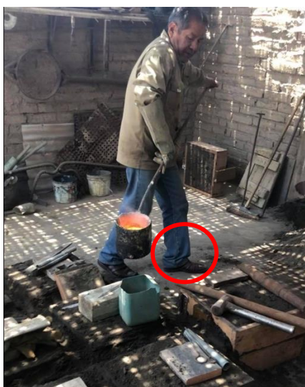
Figura 101. Operario 1 sin EPP'S expuestos a factores de riesgo Fuente: San Simón S. A. C.
