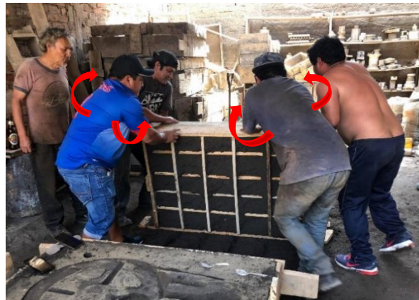
Figura 63. Operarios volteando el molde
