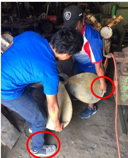
Figura 102. Operarios sin EPP'S expuestos a factores de riesgo
