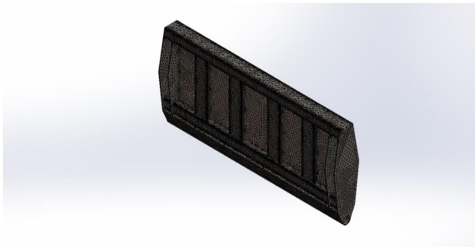
Ilustración 63: Mallado a la plataforma inferior modificada
