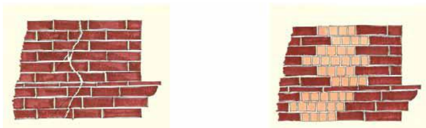
Figura 31. Albañilería de ladrillos agrietada y albañilería intervenida
