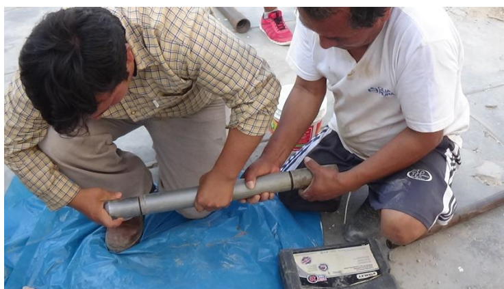
Figura 60. Obtención de muestras del sondeo N°02
