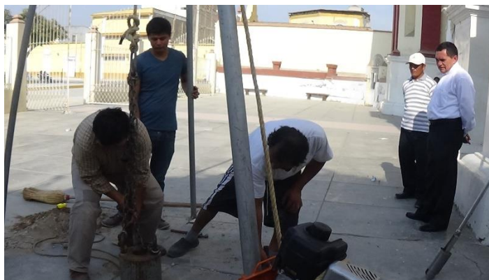
Figura 59. Ensayo SPT en presencia del párroco Mauro.
