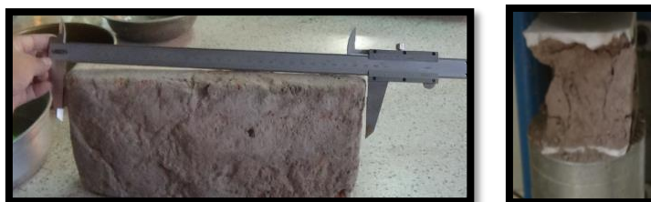
Figura 27. Unidad de adobe de la iglesia Santa Lucia y su ensayo de rotura
