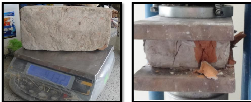
Figura 28. Unidad de ladrillo de la iglesia Santa Lucia y su ensayo de rotura
