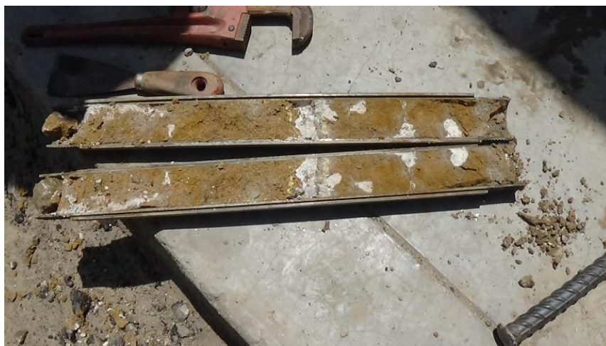
Figura 56. Retiro de la muestra obtenida en la caña partida.
