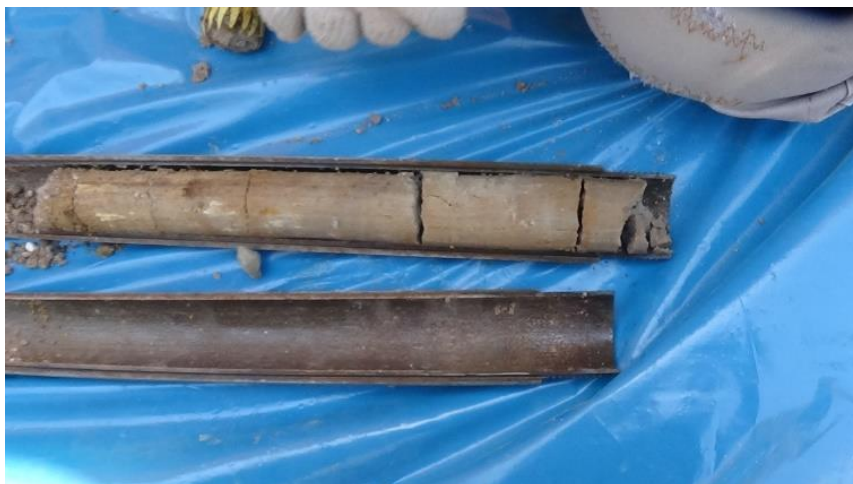
Figura 55. Obtención de muestras para los ensayos en laboratorio.
