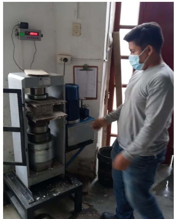
Ensayos de resistencia a la compresión
