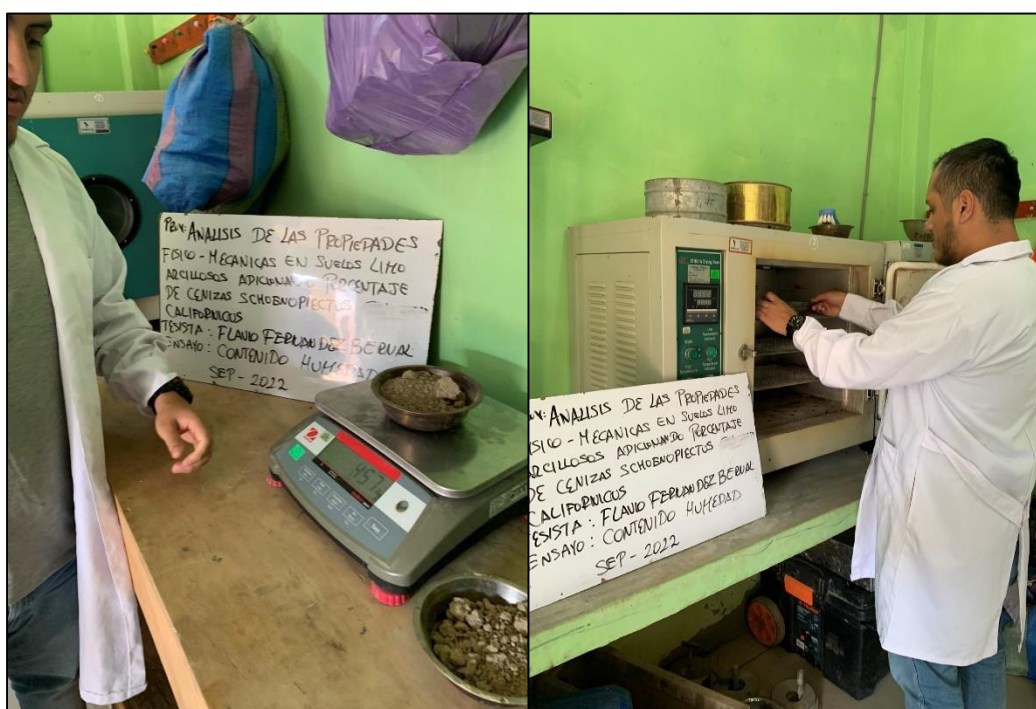
Figura N° 15: Ensayo de Contenido de Humedad. Fuente: Propia.
