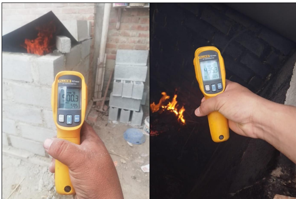
Figura N° 25: Medición de temperatura en horno. Fuente: Propia
