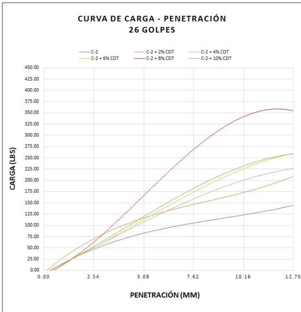
Gráfica N° 18: Curvas de carga – penetración de muestras experimentales a 26 golpes. Fuente: Propia
