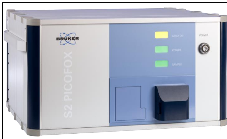
Figura N° 22: Espectrómetro de rayos X. Fuente: Propia.
