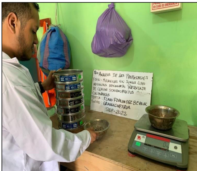
Figura N° 16: Ensayo de Granulometría, tamizado. Fuente: Propia.
