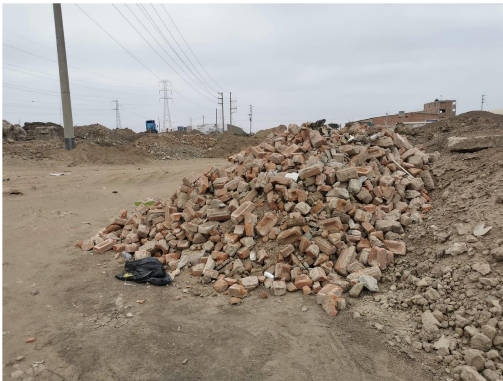
Imagen 33: Imagen de residuos de ladrillo proveniente de demoliciones.
