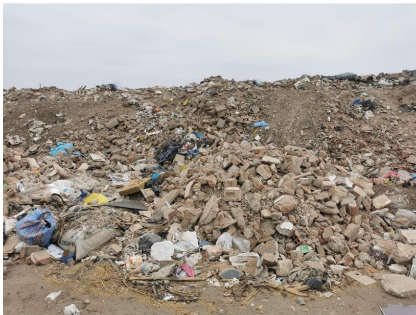
Imagen 36: Imagen de residuos de ladrillo proveniente de demoliciones.
