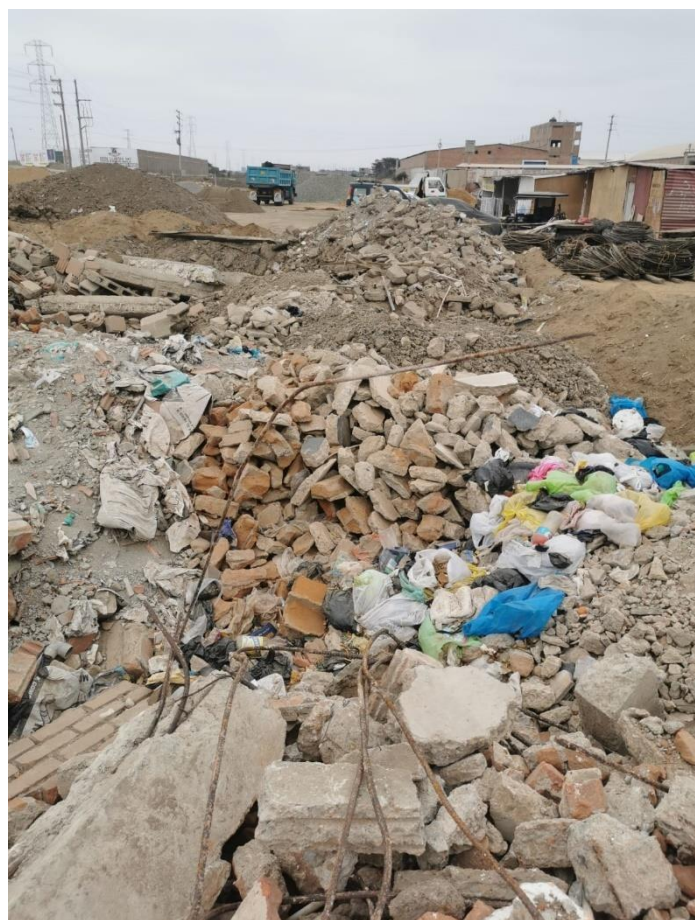
Imagen 32: Imagen de residuos de ladrillo proveniente de demoliciones.
