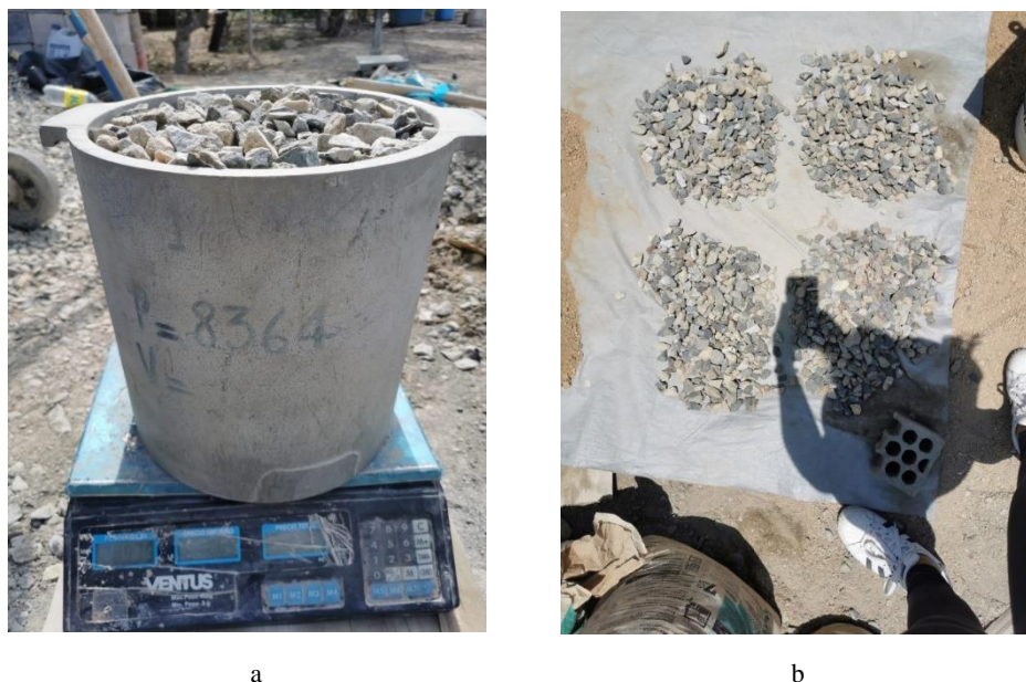
Imagen 4: Peso unitario suelto – compactado: a) peso de la muestra PUS b) cuarteo del agregado grueso.
