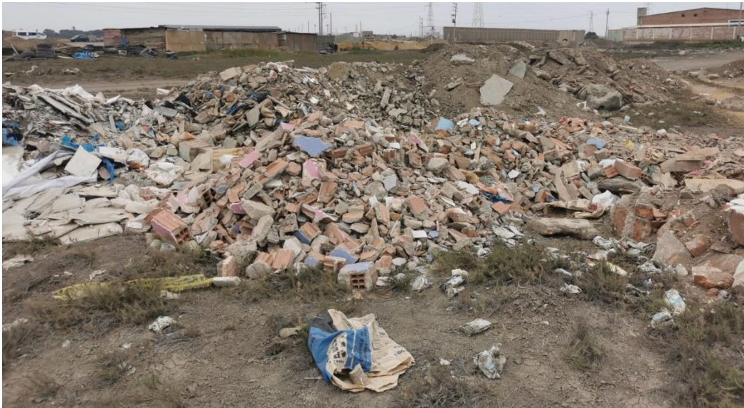
Imagen 30: Imagen de residuos de ladrillo proveniente de demoliciones.
