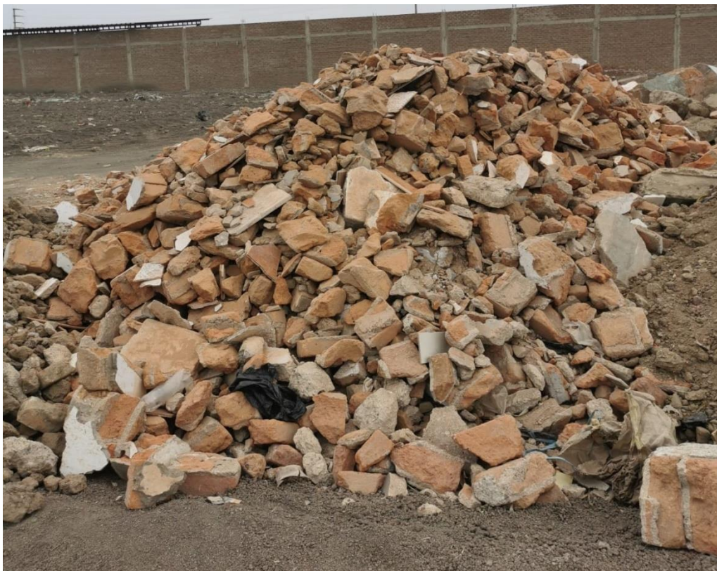
Imagen 31: Imagen de residuos de ladrillo proveniente de demoliciones.
