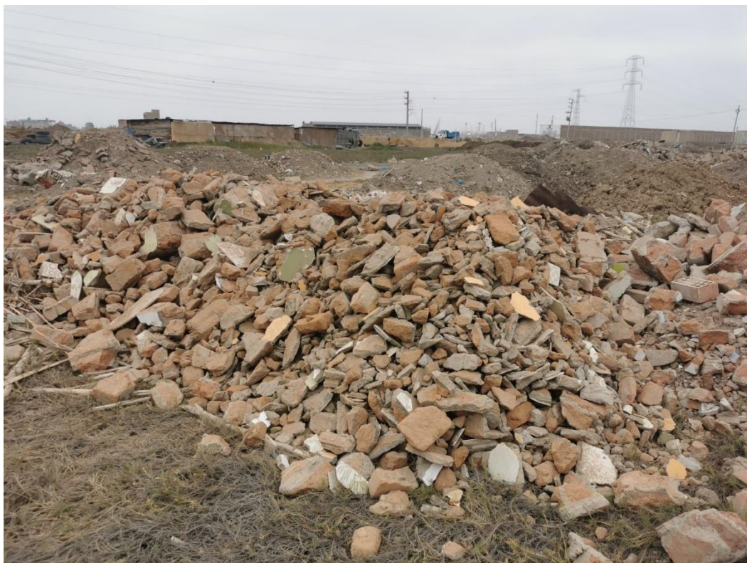
Imagen 34: Imagen de residuos de ladrillo proveniente de demoliciones.
