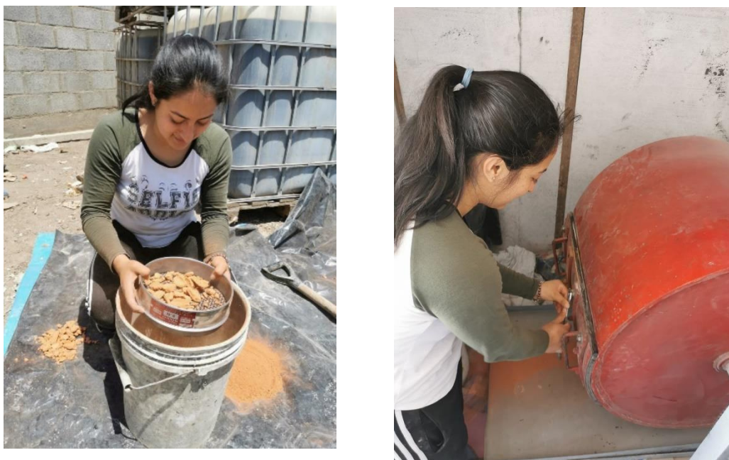
Imagen 12: Reducción del tamaño muestra: a) tamizado por la malla 3/8" b) Máquina de los ángeles que se utilizo para triturar el agregado.
