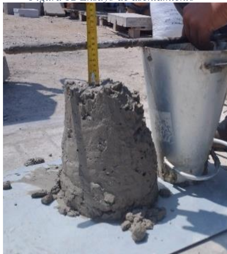
Figura 12 Ensayo de asentamiento
