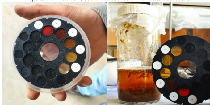
Figura 16 Prueba Colorimétrica con hidróxido de sodio
