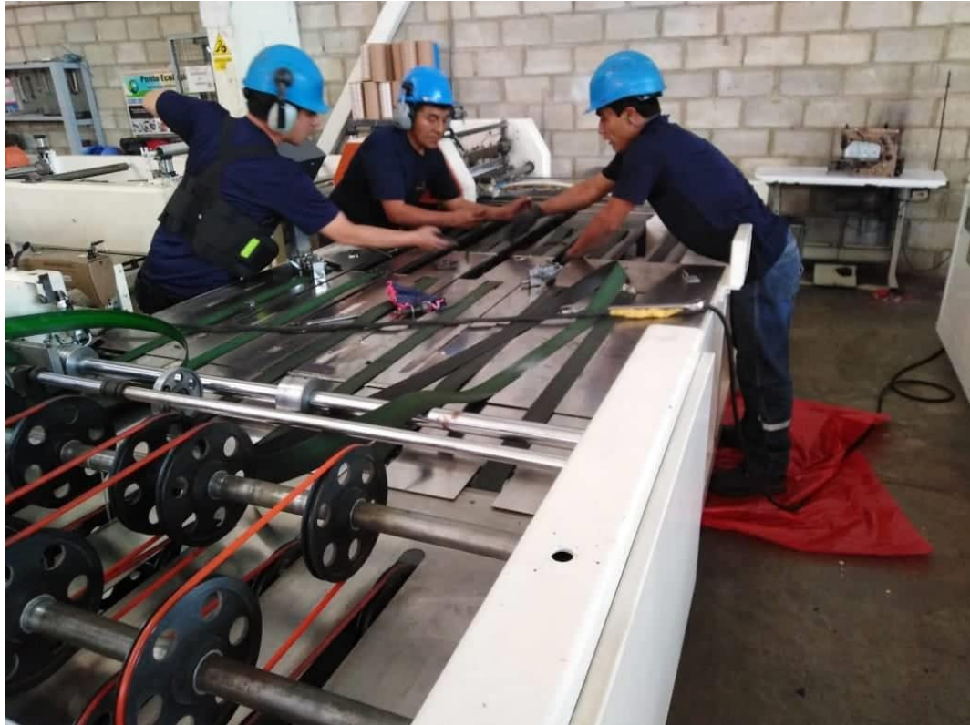
Figura 10. Mantenimiento preventivo a la convertidora 1
