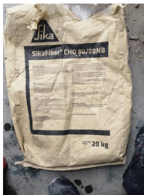
Figura 16: Saco de 20 kg de Fibra de acero entrefilado Sika Fiber CHO 80/60 NB. Fuente: Elaboración Propia.
