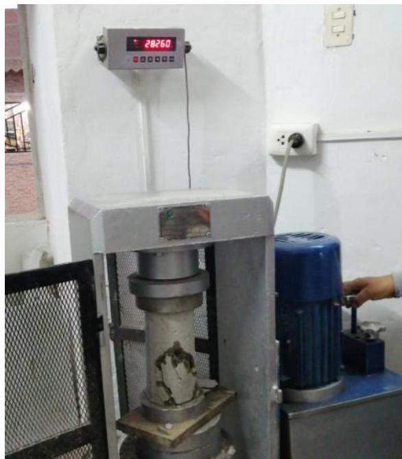
Figura 152: Rotura de una probeta a 21 días para el ensayo de Resistencia a la Compresión (1% de adición). Fuente: Elaboración Propia.
