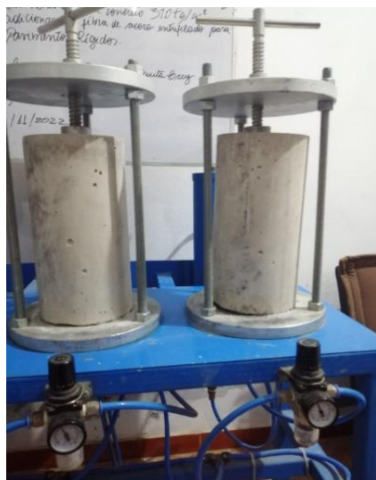
Figura 64: Maquinaria para utilizada para el ensayo de permeabilidad. Fuente: Elaboración Propia.
