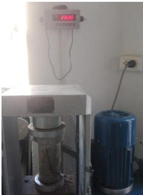
Figura 148: Rotura de un tercer testigo de concreto patrón a 7 días para el ensayo de Resistencia a la Compresión. Fuente: Elaboración Propia.
