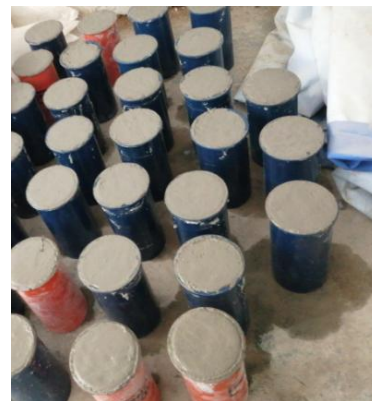
Figura 55: Testigos de concreto realizados para el ensayo de Resistencia a la Compresión. Fuente: Elaboración Propia.
