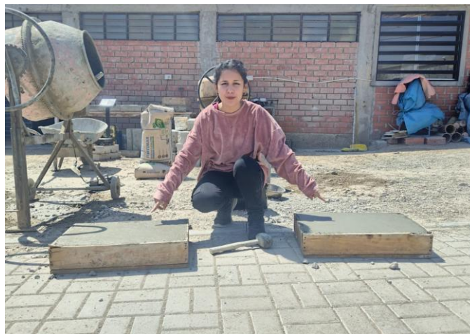
Figura 179: Llenado de los dos moldes a utilizar para el ensayo, con adición.
