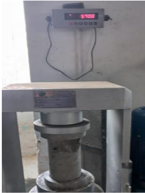
Figura 142: Rotura de una probeta a 1 d del concreto patrón. Fuente: Elaboración Propia.
