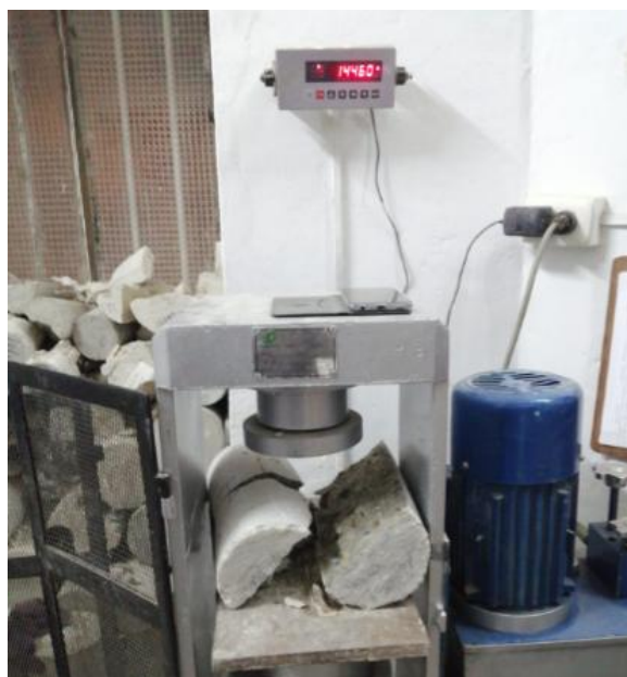
Figura 140: Rotura de un testigo a 14 días para el ensayo de Tracción (concreto patrón). Fuente: Elaboración Propia.
