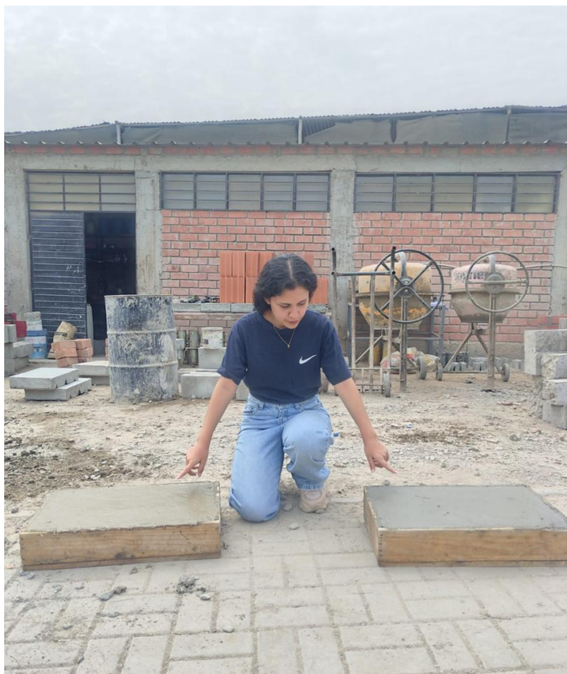
Figura 177: Llenado de los dos moldes a utilizar para el ensayo, concreto patrón.
