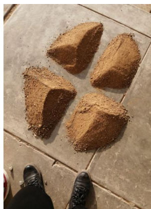
Figura 22: Agregado Fino proveniente de la cantera de “Pátapo”. Fuente: Elaboración Propia.
