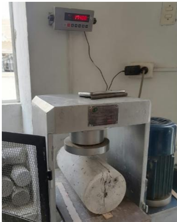
Figura 150: Rotura de una probeta a 14 días para el ensayo de Tracción diametral (1.5% de adición). Fuente: Elaboración Propia.
