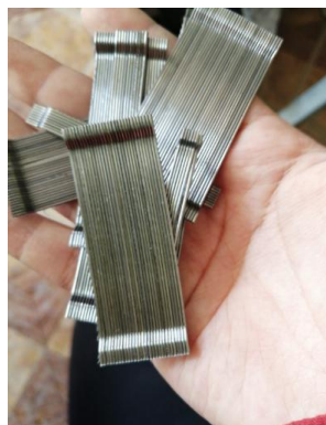
Figura 17: Forma en la que viene la Fibra de acero entrefilado Sika Fiber CHO 80/60 NB. Fuente: Elaboración Propia.
