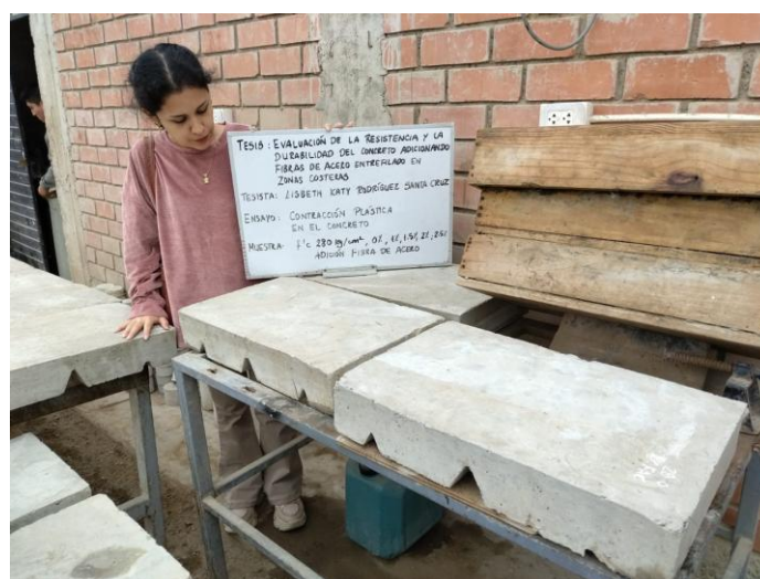
Figura 181: El resto de moldes empleados para el ensayo de fisuración.
