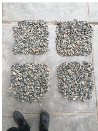
Figura 21: Agregado Grueso proveniente de la cantera “Tres Tomas”. Fuente: Elaboración Propia.
