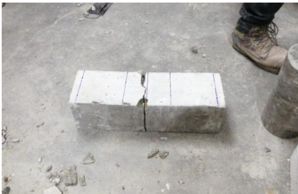
Figura 149: Rotura de una viga ensayada. Fuente: Elaboración Propia.
