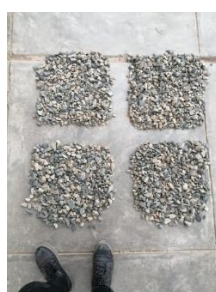
Figura 28: Cuarteo finalizado del agregado grueso, en esta parte se decide cual diagonal ensayar por granulometría. Fuente: Elaboración Propia.
