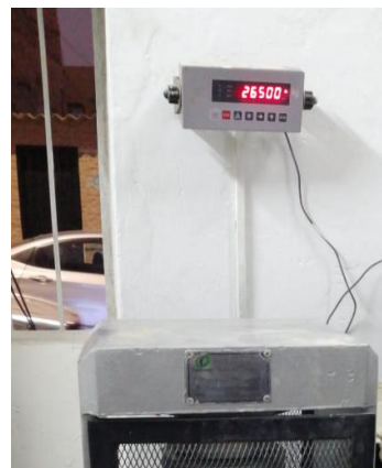
Figura 41: Resultado obtenido de la rotura adicionando un factor de seguridad de 84 kg/cm 2 a un f'_c de diseño de 280 kg/cm 2 . Fuente: Elaboración Propia.
