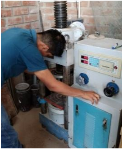
Figura 66: Proceso de rotura a tracción de las probetas ensayadas por Permeabilidad. Fuente: Propia.
