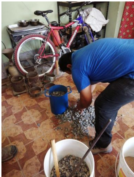
Figura 32: Proceso de llenado del molde. Fuente:
