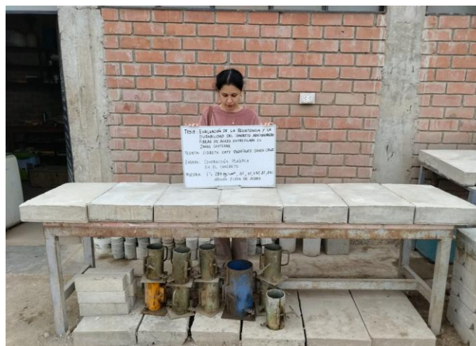
Figura 180: Moldes realizados para el proceso de fisuración.
