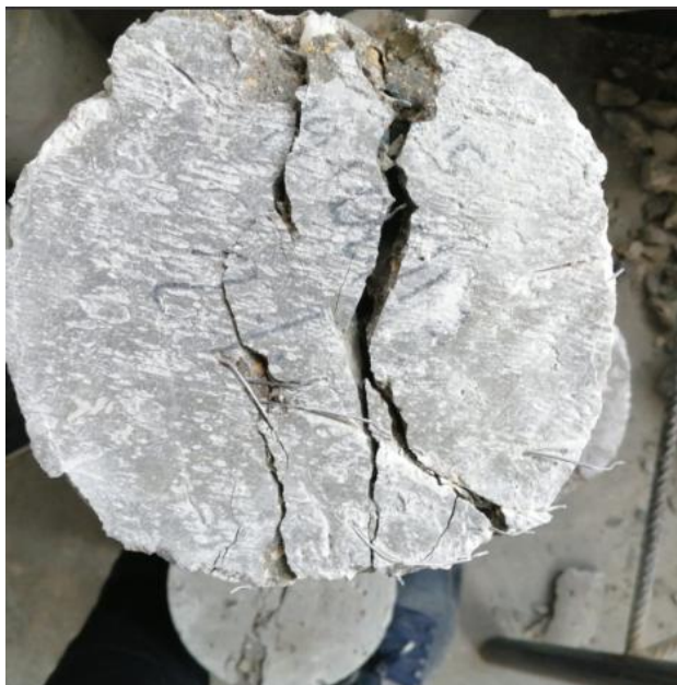
Figura 158: Rotura a Tracción de una probeta a 2% de adición de fibra de acero. Fuente: Elaboración Propia.
