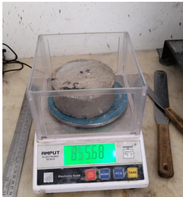
Figura 168: Peso de la probeta patrón para el ensayo de Capilaridad. Fuente: Propia.
