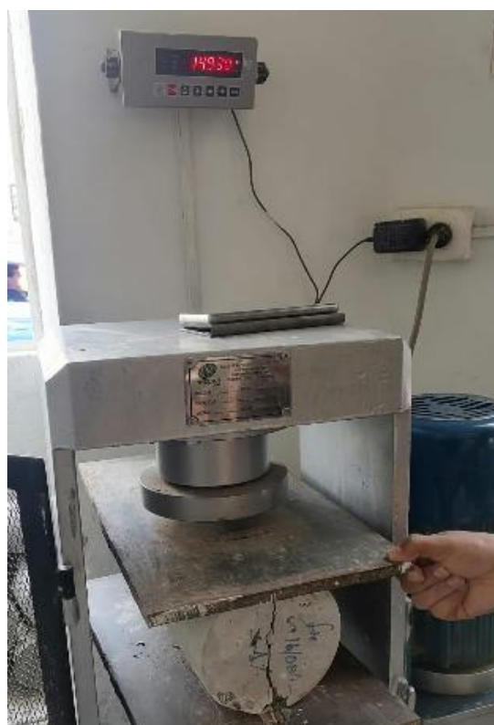
Figura 151: Rotura de una probeta a 14 días para el ensayo de Tracción diametral (1% de adición). Fuente: Elaboración Propia.
