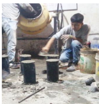
Figura 59: Proceso de vaciado de las probetas para el ensayo de Tracción. Fuente: Elaboración Propia.
