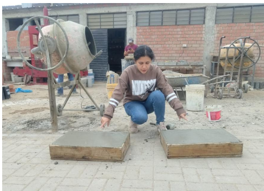
Figura 178: Llenado de los dos moldes a utilizar para el ensayo, concreto 1% de adición.
