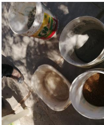
Figura 54: Agregados pesados de acuerdo con las dosificaciones de cada componente para realizar la mezcla de concreto. Fuente: Elaboración Propia.
