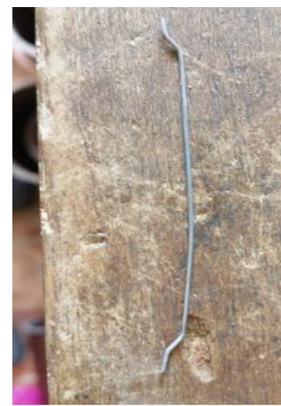
Figura 50: Fibra de acero entrefilado después de pasar por un proceso de inmersión de agua. Fuente: Propia.
