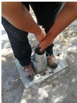
Figura 51: Proceso de realización del ensayo para determinar el Slump en concretos. Fuente: Elaboración Propia.
