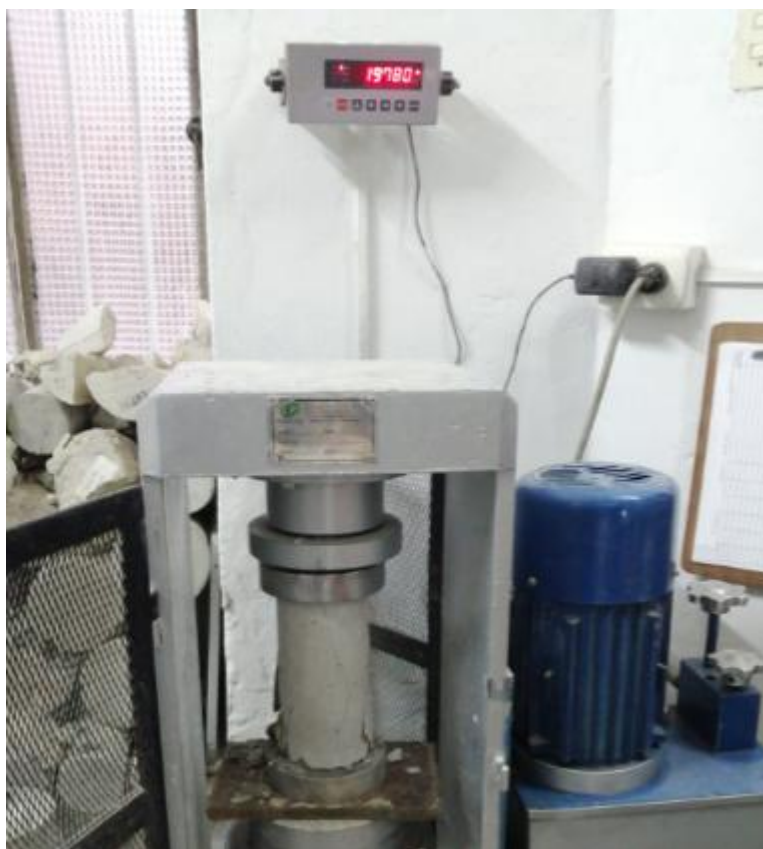
Figura 145: Rotura de una segunda probeta para ensayo Resistencia a la Compresión a 3 días con 1% adición. Fuente: Elaboración Propia.
