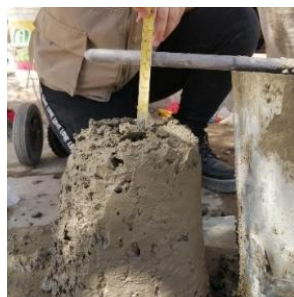
Figura 23: Medida del Slump del concreto Patrón 3''. Fuente: Elaboración Propia.
