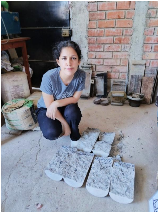
Figura 68: Proceso finalizado de rotura a tracción para el ensayo de Permeabilidad. Fuente: Propia.
