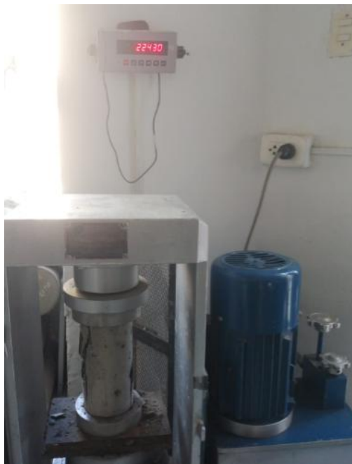
Figura 146: Rotura del concreto patrón a 7 días para el ensayo de Resistencia a la Compresión. Fuente: Elaboración Propia.
