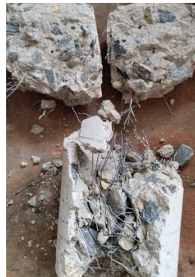
Figura 74: Proceso de rotura 2.5%. Fuente: Propia.
