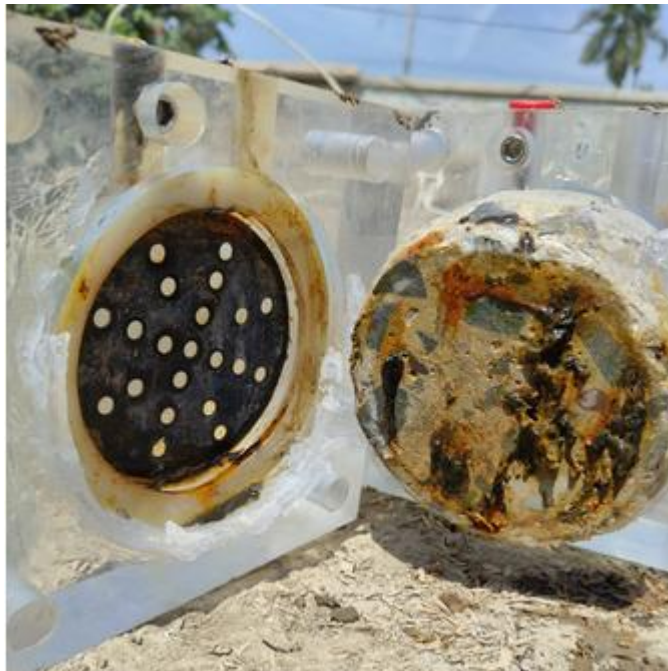
Figura 91: Reacción de la probeta al ensayo de penetración de ion de cloruros, 2% de adición. Fuente: propia.
