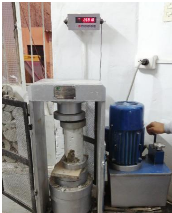
Figura 154: Rotura de una tercera probeta a 21 días para el ensayo de Resistencia a la Compresión (1% de adición). Fuente: Elaboración Propia.
