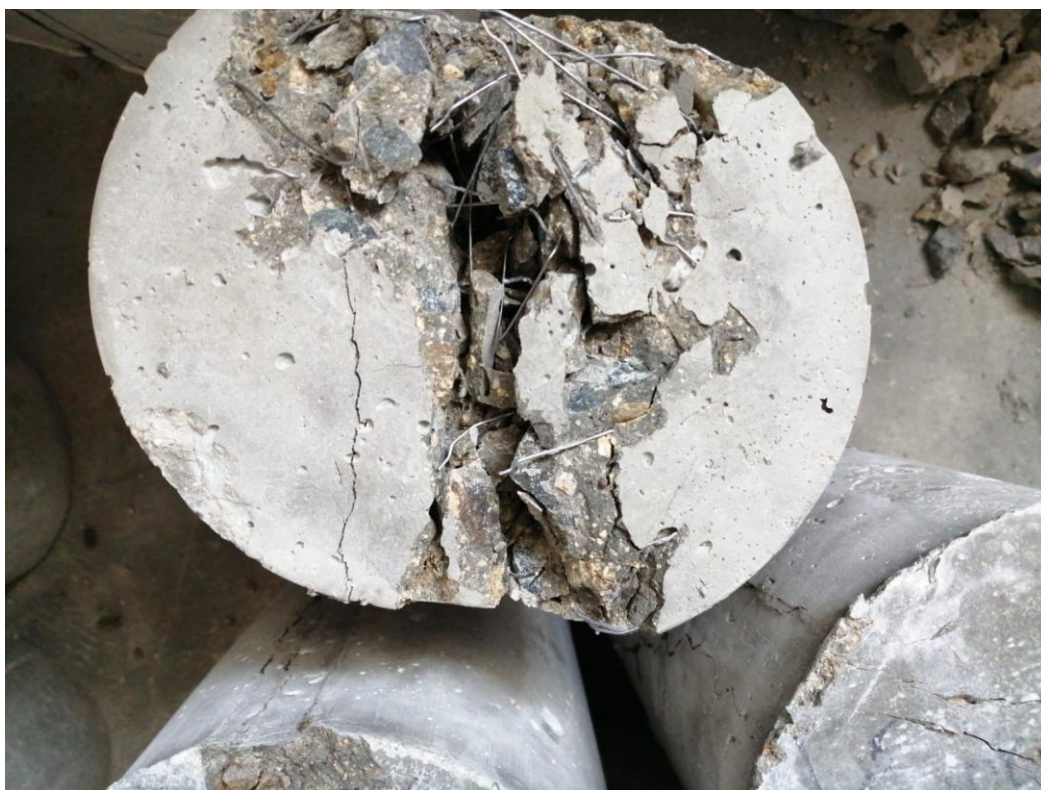
Figura 159: Rotura a Tracción de una probeta a 2.5% de adición de fibra de acero. Fuente: Elaboración Propia.
