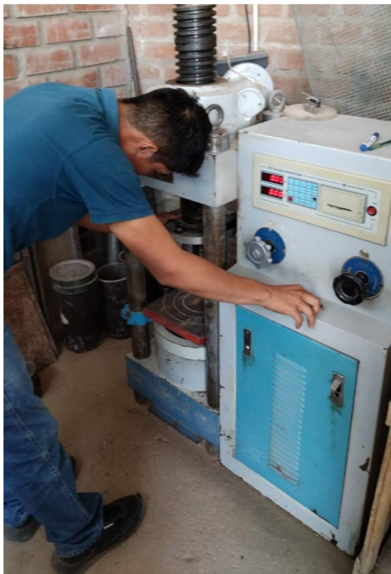
Figura 160: Proceso de rotura a tracción de las probetas ensayadas por Permeabilidad. Fuente: Propia.
