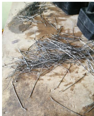
Figura 49: La fibra de acero después de estar en el agua de mezclado y ser retirada. Fuente:
