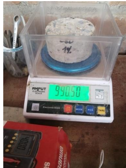
Figura 76: Proceso de pesado de las probetas con silicona, probeta de 1%. Fuente: Propia.
