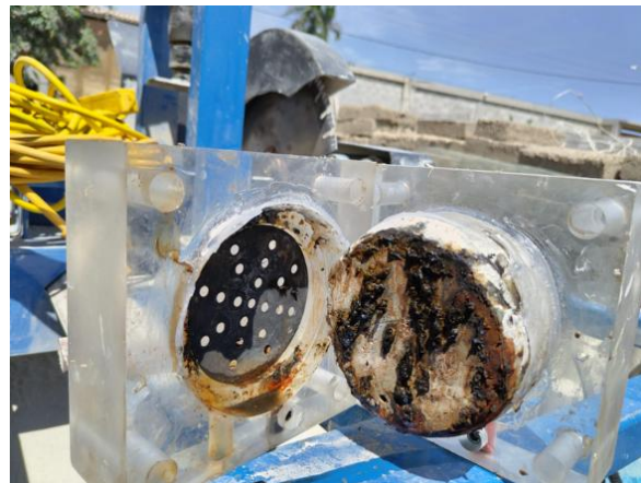
Figura 90: Reacción de la probeta al ensayo de penetración de ion de cloruros, 2.5% de adición.
