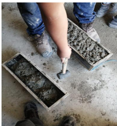
Figura 56: Proceso de llenado de las vigas. Fuente: Elaboración Propia.
