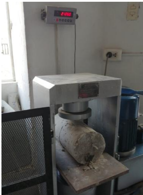
Figura 156: Segunda probeta cilíndrica con adición de 2.5% de fibra de acero para el ensayo de Tracción Diametral. Fuente: Elaboración Propia.
