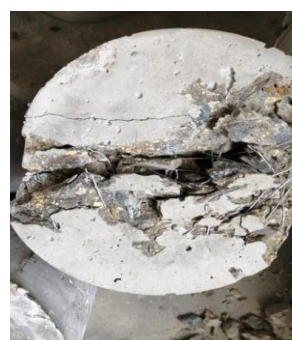
Figura 61: Falla de una probeta ensayada por flexión en la dosificación de 2.5%. Fuente: Elaboración Propia.
