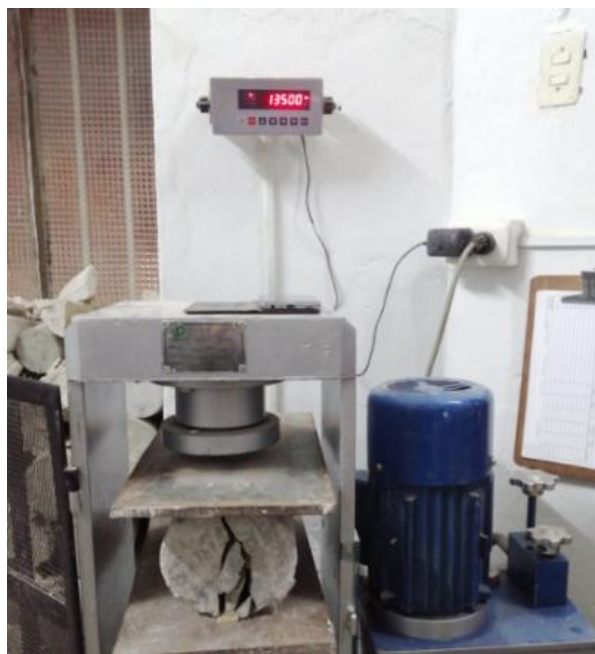
Figura 141: Rotura de un segundo testigo a 14 días para el ensayo de Tracción (concreto patrón). Fuente: Elaboración Propia.
