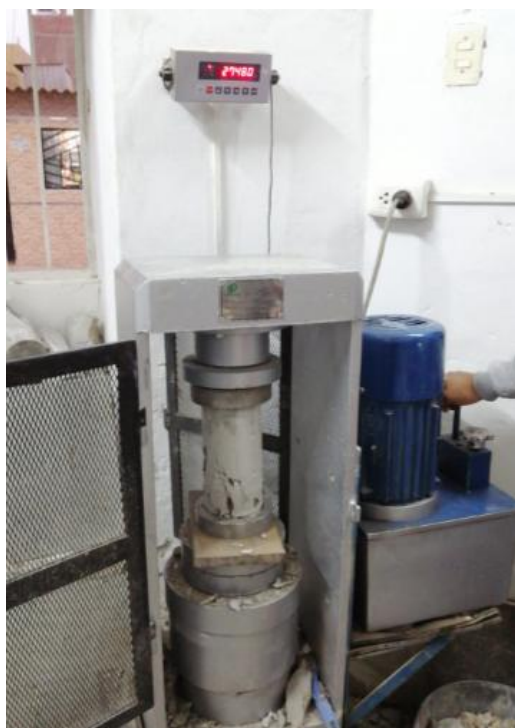
Figura 153: Rotura de una segunda probeta a 21 días para el ensayo de Resistencia a la Compresión (1% de adición). Fuente: Elaboración Propia.
