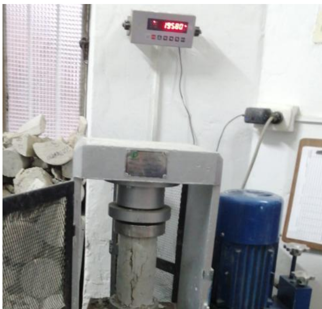
Figura 144: Rotura de una probeta para ensayo Resistencia a la Compresión a 3 días con 1% adición. Fuente: Elaboración Propia.
