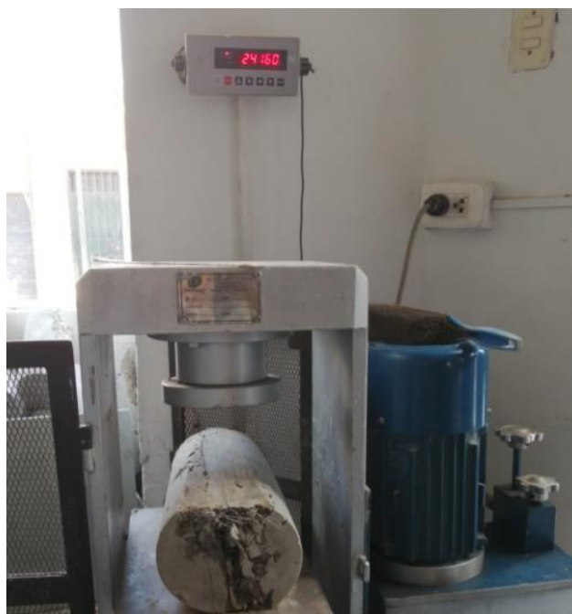
Figura 155: Probeta cilíndrica con adición de 2.5% de fibra de acero para el ensayo de Tracción Diametral. Fuente: Elaboración Propia.
