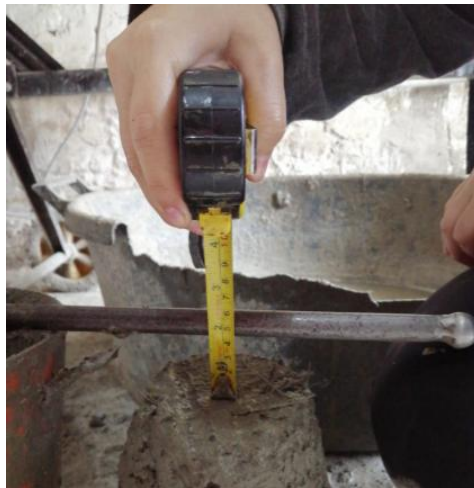
Figura 138: Ensayo de Slump para 1.5% de adición de Sika Fiber CHO 80/60 NB. Fuente: Elaboración Propia.
