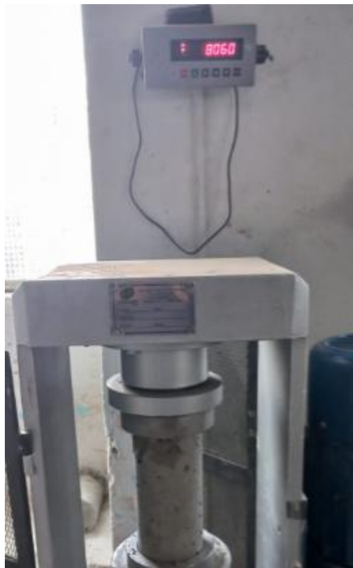
Figura 143: Rotura de una segunda probeta a 1 d del concreto patrón. Fuente: Elaboración Propia.
