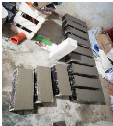
Figura 57: Llenado de vigas de concreto a diferentes porcentajes de adiciones. Fuente: Elaboración Propia.
