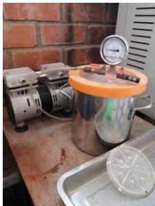
Figura 82: Maquinaria empleada para el proceso de curación por un lapso de 3h de las probetas. Fuente: Propia.
