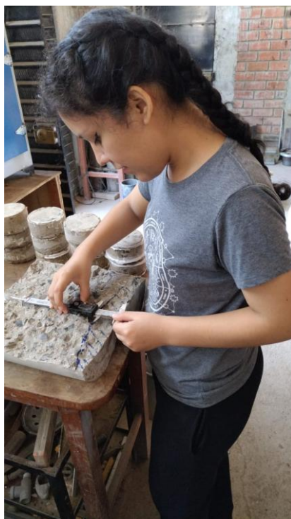
Figura 163: Proceso de medición de las probetas ensayadas para determinar sus valores. Fuente: Propia.
