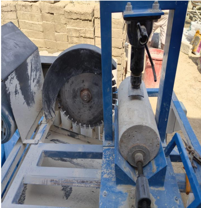
Figura 62: Proceso de pulido de una cara de las probetas para Permeabilidad. Fuente: Propia.
