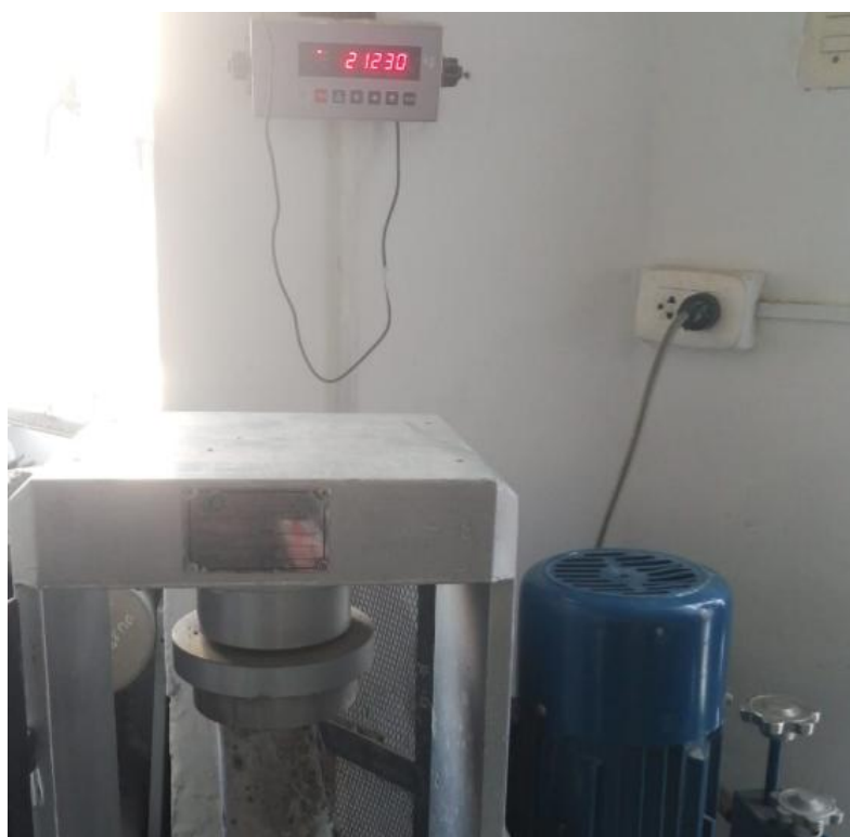
Figura 147: Rotura de un segundo testigo de concreto patrón a 7 días para el ensayo de Resistencia a la Compresión. Fuente: Elaboración Propia.
