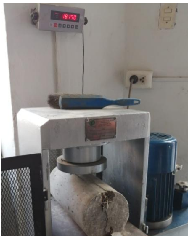
Figura 157: Probeta cilíndrica con adición de 2% de fibra de acero para el ensayo de Tracción Diametral. Fuente: Elaboración Propia.
