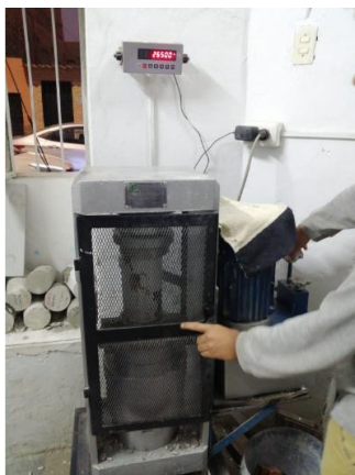
Figura 40: Rotura de un diseño de mezcla a 28 días con un factor de seguridad de 84 kg/cm 2 . Fuente: Elaboración Propia.
