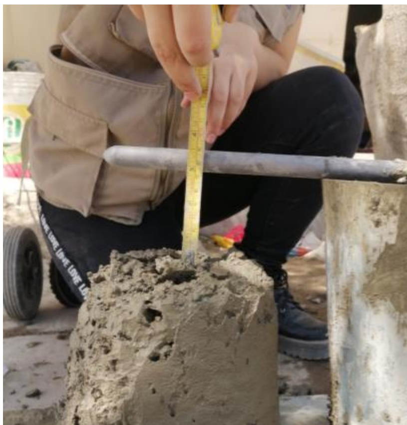
Figura 136: Ensayo de Slump para un concreto patrón 280 kg/cm 2 . Fuente: Elaboración Propia.
