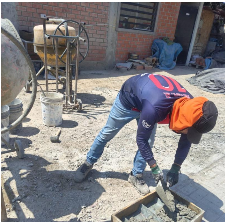
Figura 174: Proceso de llenado de moldes para el ensayo de fisuración.
