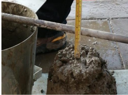
Figura 137: Ensayo de Slump para 1% de adición de Sika Fiber CHO 80/60 NB. Fuente: Elaboración Propia.
