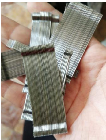
Figura 48: Forma en la que viene la fibra de acero por la condición de ser entrefilado.
