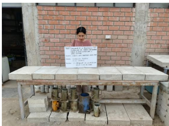
Figura 105: Primeras 7 losas obtenidas para ser evaluadas mediante el ensayo de fisuración.
