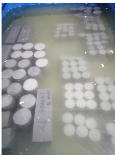
Figura 109: Proceso de curado de los especímenes de concreto (Probetas y Vigas). Fuente: Elaboración Propia.
