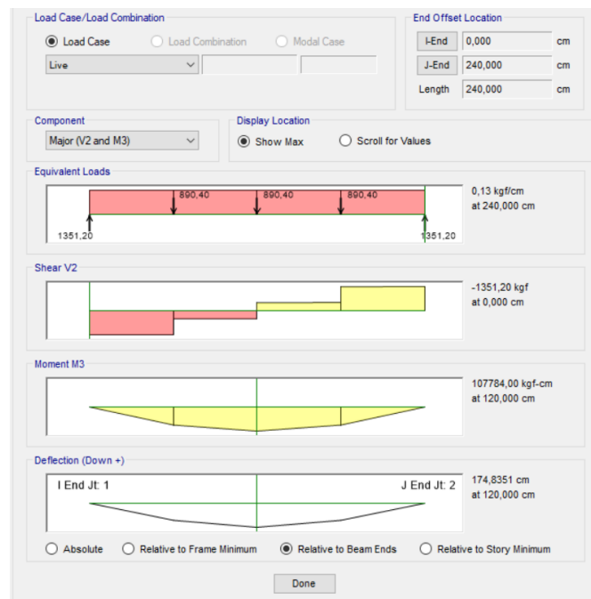
Figura 112: Análisis de viga mediante el programa Etabs.
