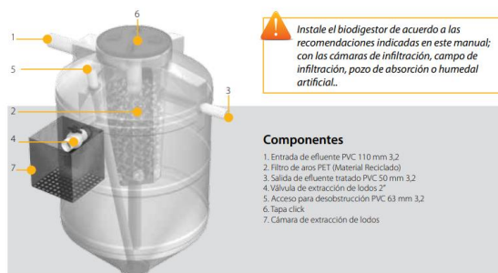
Figura 55: Componentes de tanque séptico.
