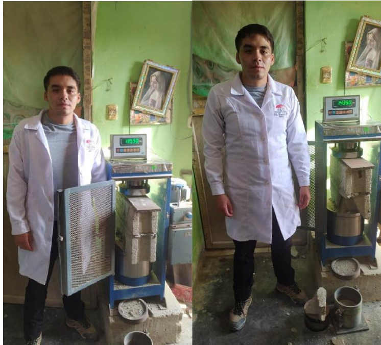
Anexo 20. Ensayo de resistencia a la compresión diagonal de muretes.
