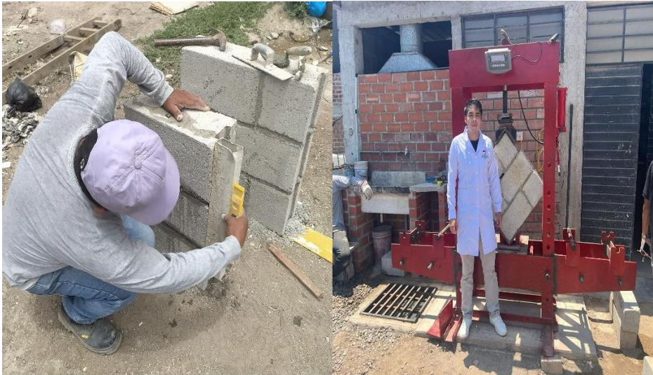
Anexo 20. Ensayo de resistencia a la compresión diagonal de muretes.
