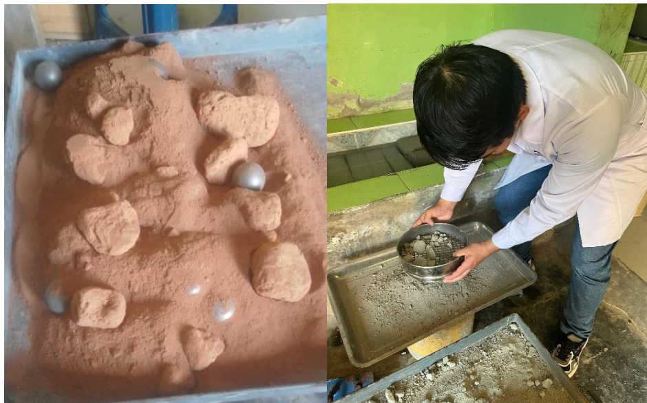
Anexo 05. Obtención de agregados reciclados y polvo de ladrillo reciclado.
