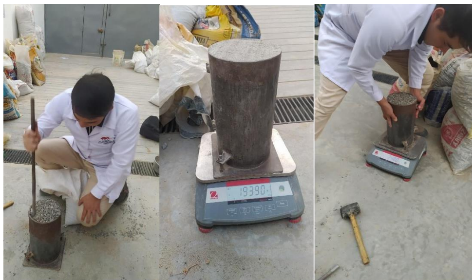
Anexo 10. Ensayo de peso unitario suelto y compactado para los agregados naturales y reciclados.
