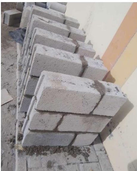
Figura 20. Fabricación de muretes.
