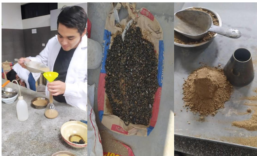
Anexo 09. Ensayo de peso específico y absorción para los agregados naturales y reciclados.
