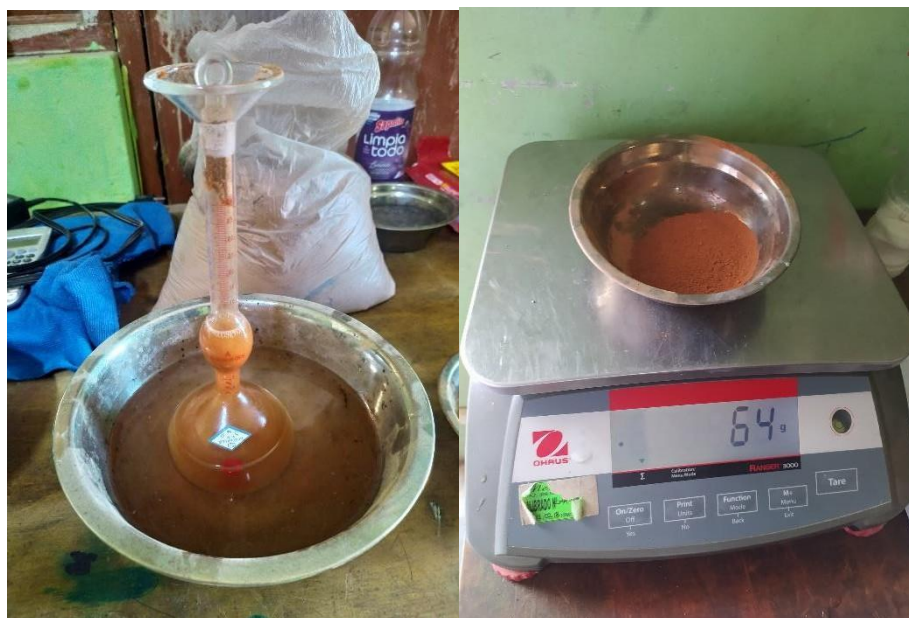
Anexo 06. Ensayo de densidad del polvo de ladrillo reciclado.
