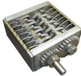
Figura N°: 8 Cámara de molienda [14]
