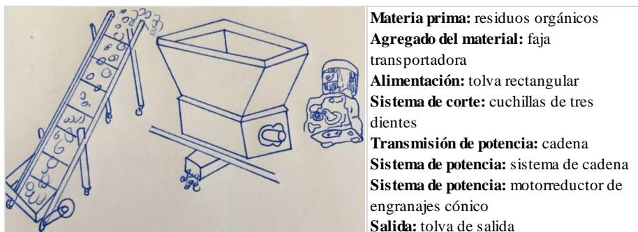
Figura N°: 24 Especificación de la solución 4
