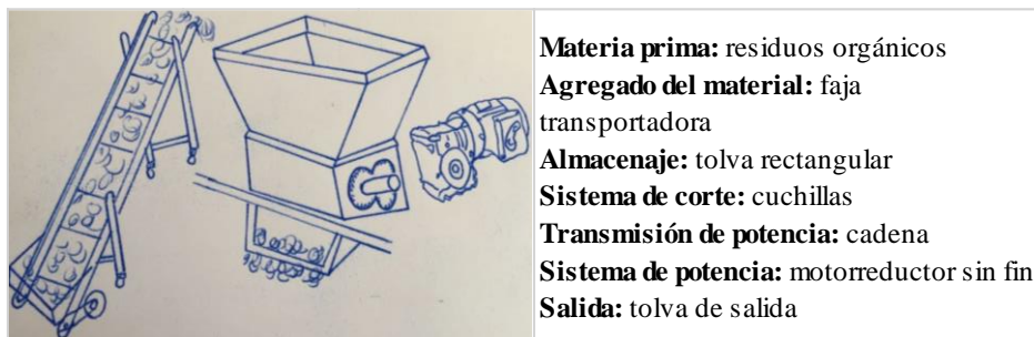
Figura N°: 28 Especificación de la solución 8
