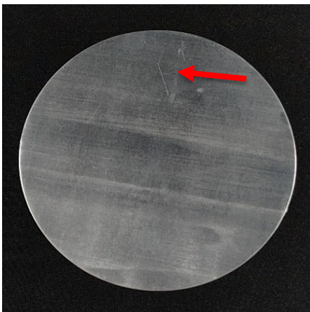
Fig. 10. Disco de buena calidad con rayaduras
