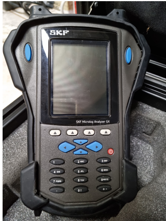
Figura A.3: Analizador de vibraciones SKF Microlog® Analyzer GX.
