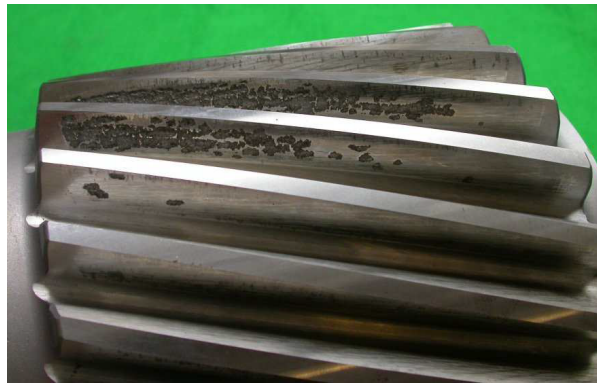
Figura 2.5: Macropicaduras de origen de superficie puntual en piñón de accionamiento helicoidal cementado
