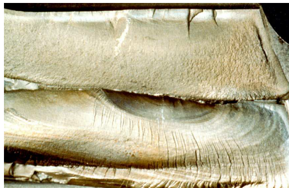
Figura 2.8: Fatiga por flexión de dos dientes helicoidales
