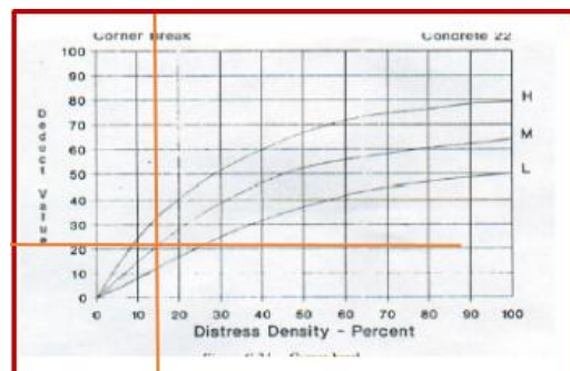
Ilustración 198. Grafica Grietas de Esquina
