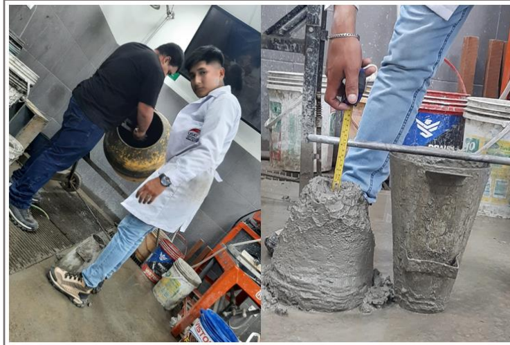
Ilustración 13: Procedimiento para revenimiento del concreto
