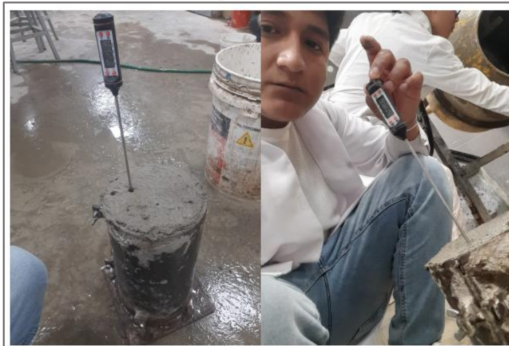
Ilustración 14: Toma de la temperatura del concreto en su estado fresco
