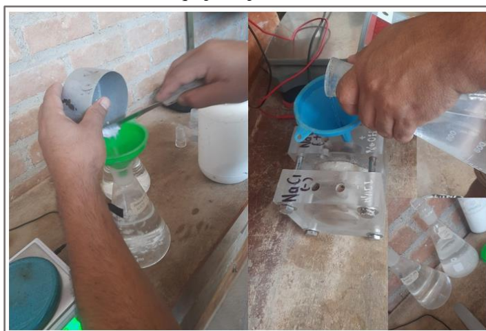
Ilustración 21: Llenado del equipo experimental con las soluciones de sodio
