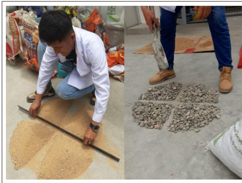
Ilustración 9: Procedimiento para ensayo de peso específico del ag. fino
