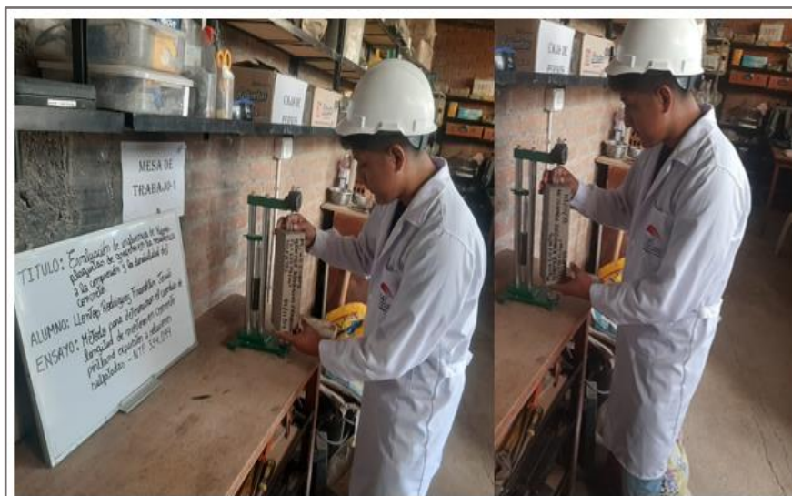
Ilustración 25: Toma de medidas con el comparador de longitud
