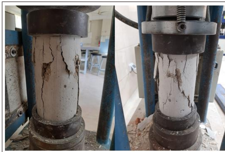
Ilustración 17: Identificación de los tipos de fracturas generadas
