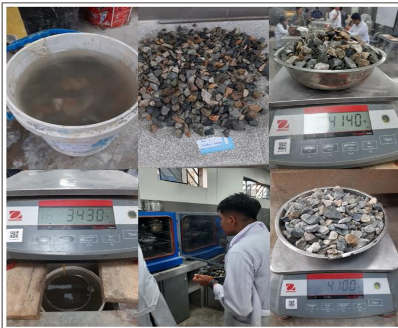
Ilustración 10: Procedimiento para ensayo de peso específico del ag. grueso
