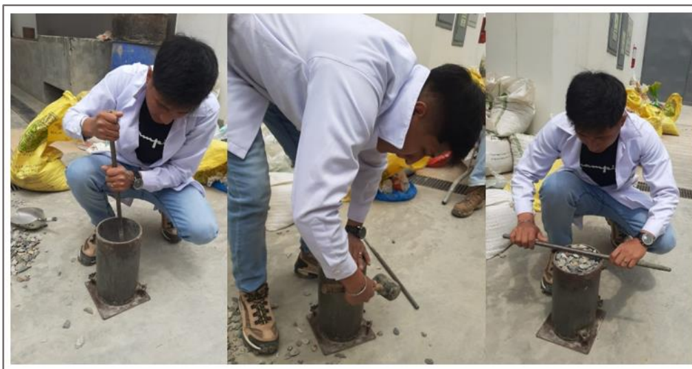
Ilustración 7: Procedimiento para hallar el peso unitario compactado del ag. grueso
