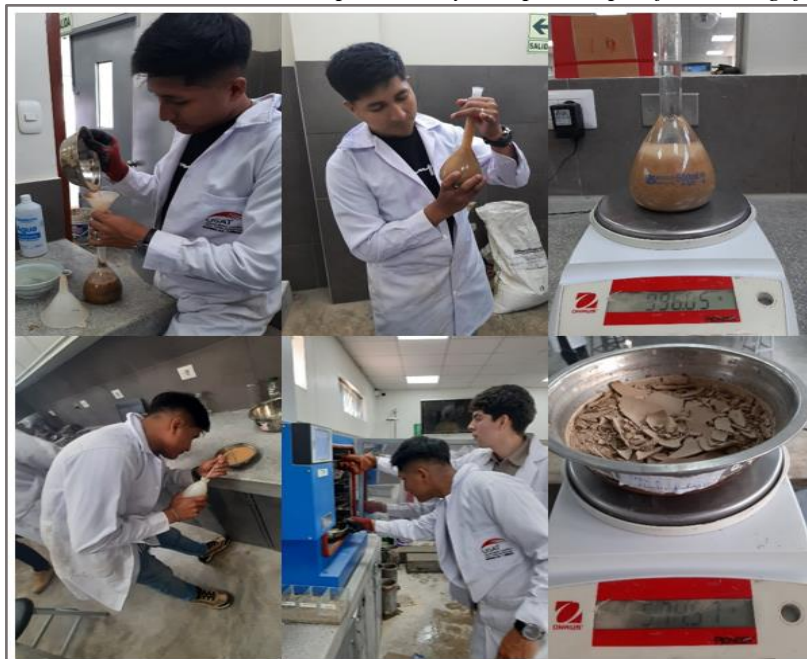
Ilustración 9: Procedimiento para ensayo de peso específico del ag. fino
