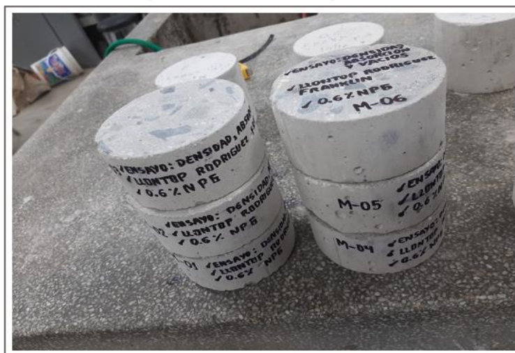
Ilustración 19: Preparación de muestras para ensayo de densidad
