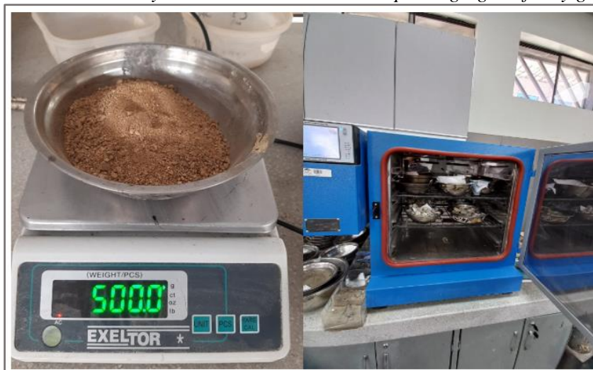
Ilustración 11: Ensayo de contenido de humedad para agregado fino y grueso
