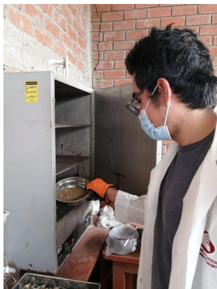
FIGURA 12: ENSAYO DEL PORCENTAJE DE HUMEDAD DEL AGREGADO FINO EN LABORATORIO
