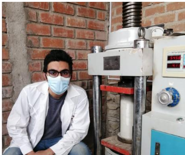
FIGURA 18: PRENSA HIDRÁULICA ENSAYANDO TESTIGOS DE CONCRETO
