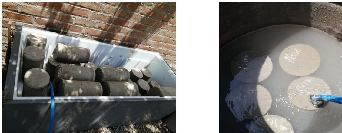
FIGURA 17: CURADO DE TESTIGOS DE CONCRETO
