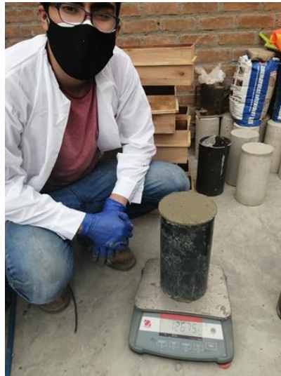
FIGURA 21: VERIFICACIÓN DEL PESO UNITARIO DEL CONCRETO FRESCO
