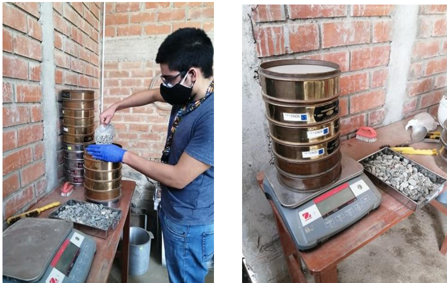
FIGURA 14: ANÁLISIS GRANULOMÉTRICO EN LABORATORIO-AGREGADO GRUESO
