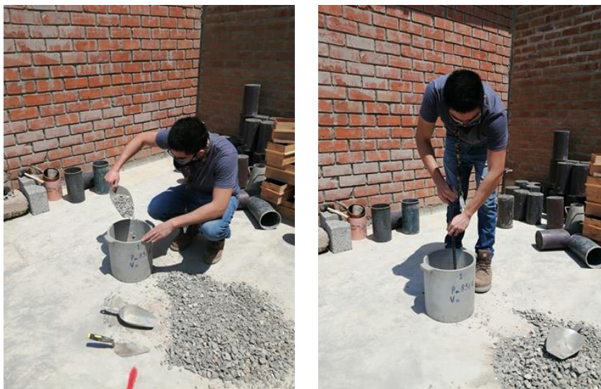
FIGURA 16: ENSAYO DE PESO UNITARIO DEL AGREGADO GRUESO EN LABORATORIO
