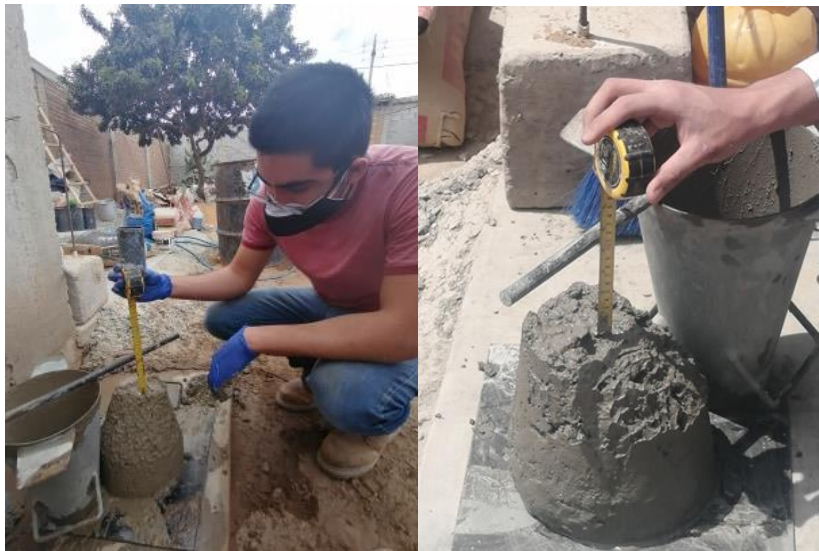
FIGURA 20: VERIFICACIÓN DEL SLUMP EN EL CONCRETO ( 210 \text{ KG/CM}^2 Y 280 \text{ KG/CM}^2 )
