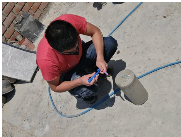
FIGURA 22: COLOCACIÓN DE MARCA A TESTIGOS DE CONCRETO
