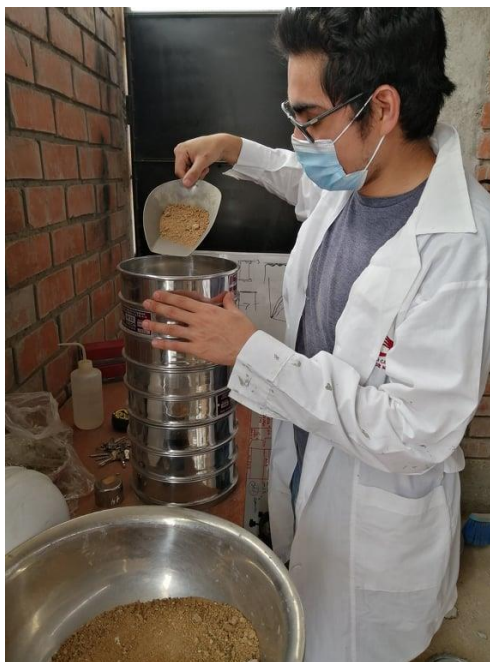
FIGURA 10: ENSAYO DEL ANÁLISIS GRANULOMÉTRICO DEL AGREGADO FINO EN LABORATORIO
