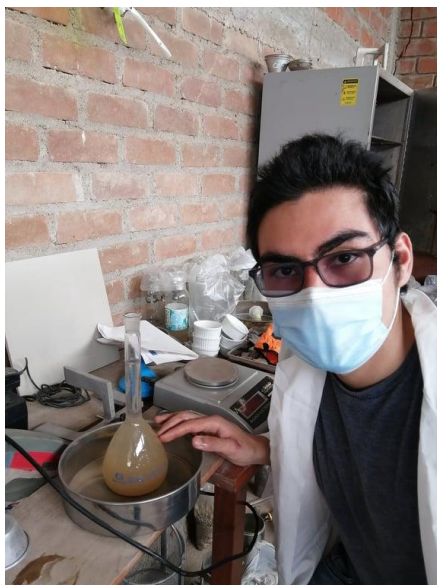
FIGURA 11: ENSAYO DE GRAVEDAD ESPECÍFICA Y ABSORCIÓN DEL AGREGADO FINO EN LABORATORIO
