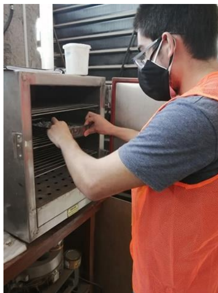
FIGURA 15: COLOCACIÓN DEL AGREGADO GRUESO EN EL HORNO PARA SECADO
