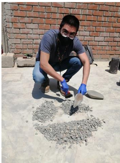
FIGURA 8: CUARTEO IN SITU DEL AGREGADO GRUESO
