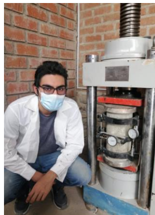
FIGURA 23: ENSAYO DE MÓDULO DE ELASTICIDAD EN PROBETAS DE CONCRETO SIMPLE
