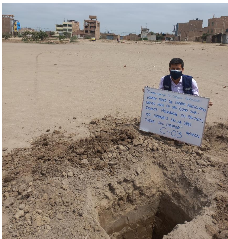
Ilustración 24: Zona de extracción de calicata N° 03 en Urb. Ciudad del Chofer
