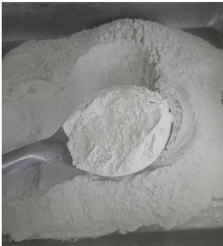
Ilustración 33: Vidrio triturado de tamaño entre 75 \mu\text{m} – 300 \mu\text{m}
