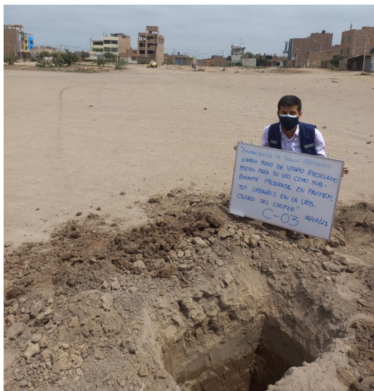
Extracción de muestra de suelo de calicata N° 03 en Urb. Ciudad del Chofer
