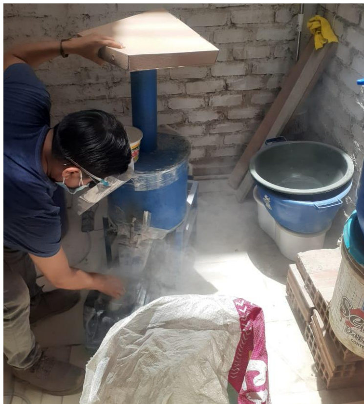
Ilustración 29: Triturado de vidrio usando un molino artesanal eléctrico Fuente: propia
