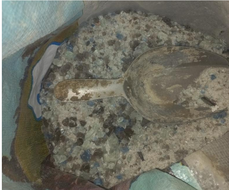
Residuos de vidrio reducidos de manera manual a tamaños de entre 2 a 3 pulgadas
