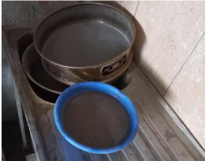
Lavado de la parte fina del suelo para ensayo de granulometría por tamizado
