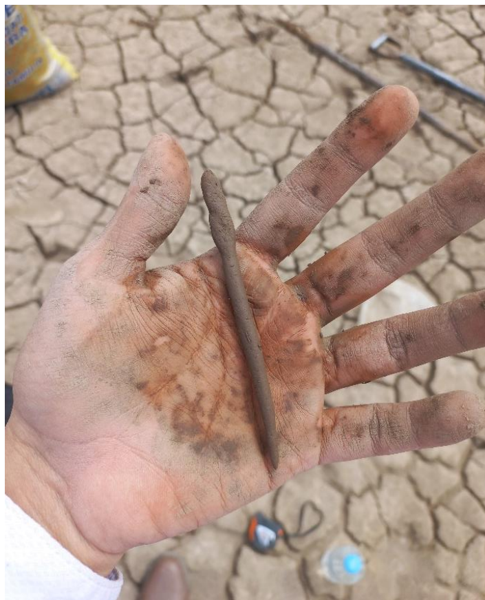
Manipulación de suelo in situ para reconocimiento previo de características físicas del suelo
