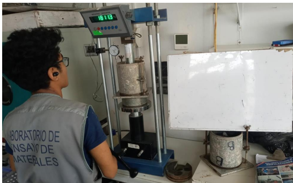
Proceso de penetración de la muestra de suelo adicionada luego de ser sumergida por 96 horas en agua
