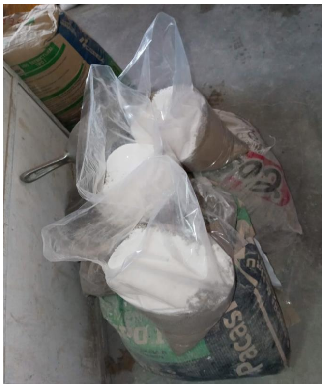
Ilustración 34: Dosificaciones de suelo arcilloso seco y vidrio molido previo a su mezclado
