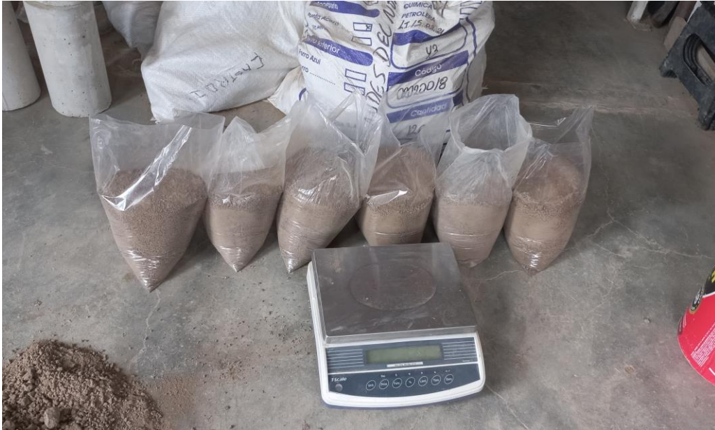
Proceso de pesado de muestras de suelo en bolsas para su posterior mezclado con vidrio en polvo
