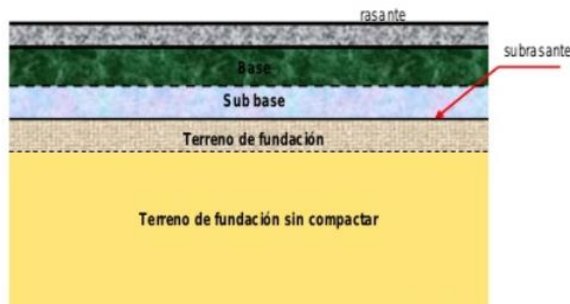
Ilustración 16: Estructura típica de pavimentos asfálticos [32]
