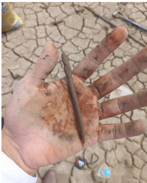
Ilustración 21: Consistencia del suelo encontrado durante la exploración geotécnica
