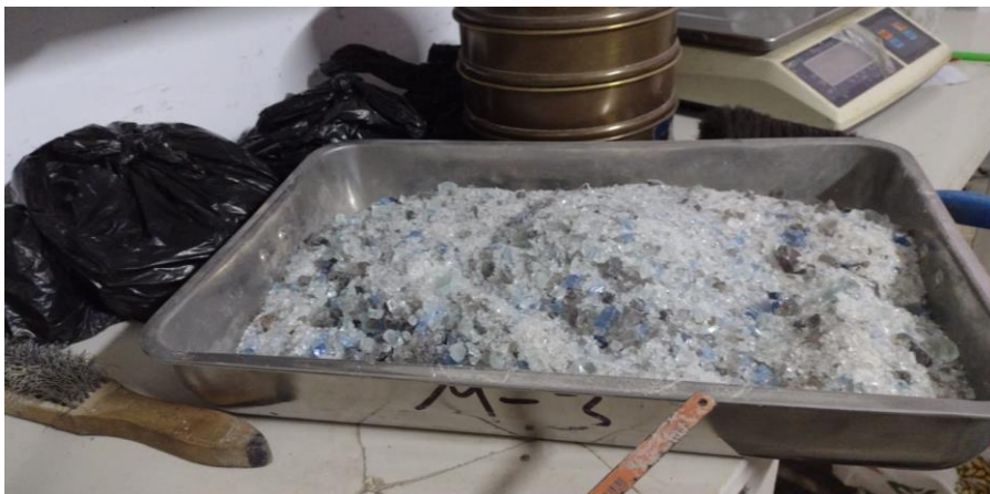
Vidrio triturado por primera vez con molino artesanal eléctrico
