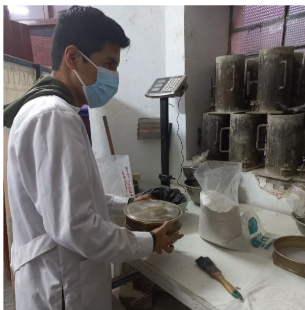
Ilustración 32: Proceso de tamizado del vidrio triturado usando la malla N° 50 y N° 200
