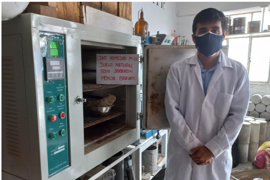
Muestras de suelo natural después de ser secadas durante 24 h en horno.
