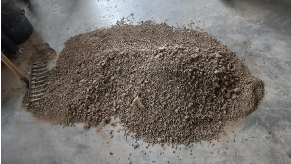
Muestra de suelo natural sometida a proceso de cuarteo previo chancado con mortero
