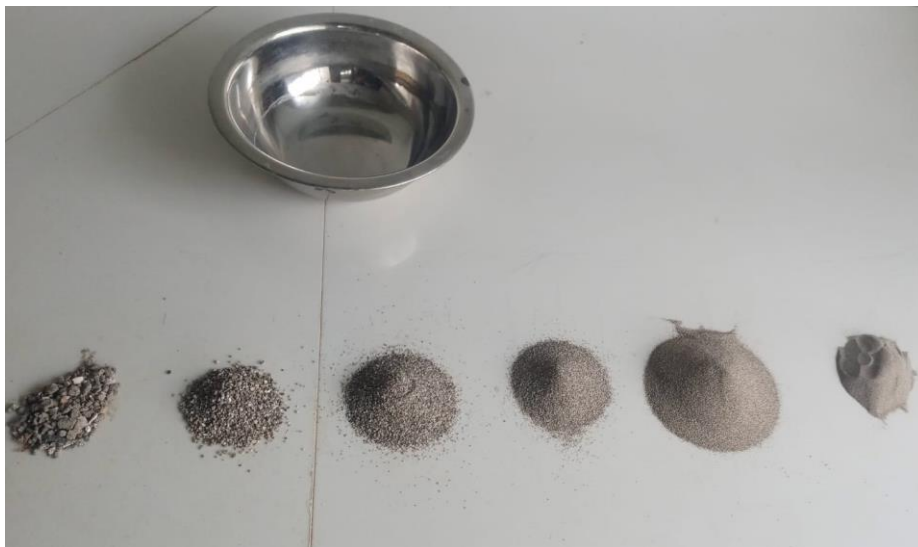
Distribución granulométrica de la fracción gruesa del suelo natural
