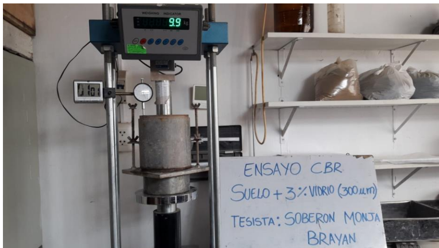
Proceso de penetración de la muestra de suelo adicionada luego de ser sumergida por 96 horas en agua
