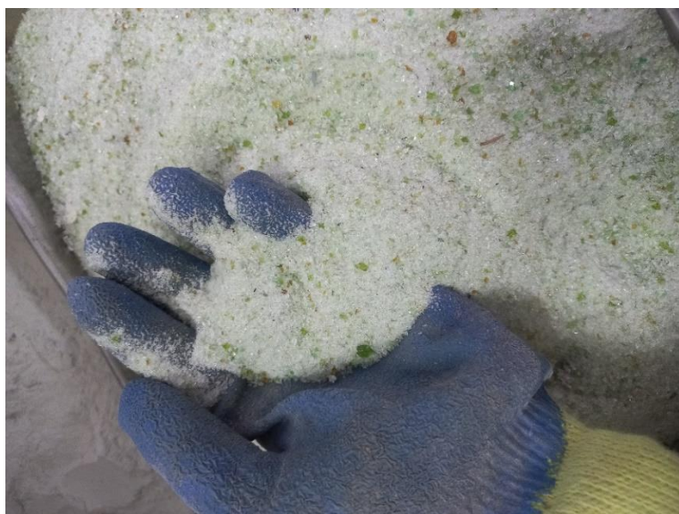
Ilustración 31: Vidrio triturado por vez con molino artesanal eléctrico Fuente: propia
