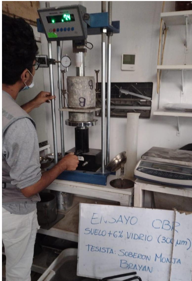
Proceso de penetración de la muestra de suelo adicionada luego de ser sumergida por 96 horas en agua
