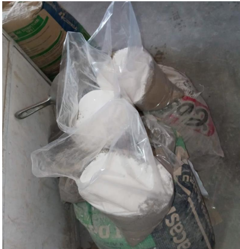
Dosificaciones de suelo arcilloso seco y vidrio molido previo a su mezclado
