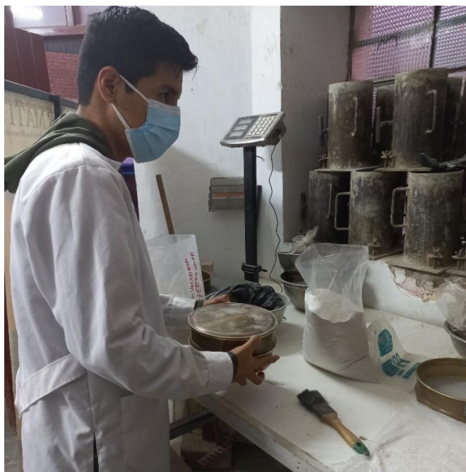
Proceso de tamizado del vidrio triturado usando la malla N° 50 y N° 200
