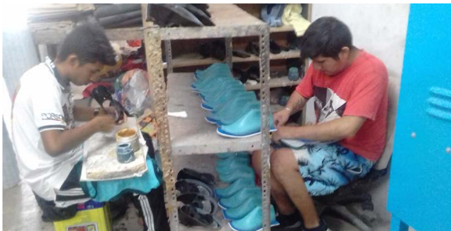
Figura 11. Operación de Montado
