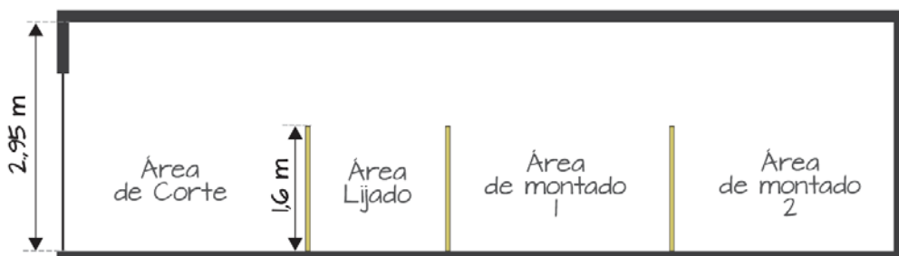
Figura 253. Vista vertical de la pared que separa cada puesto de trabajo
