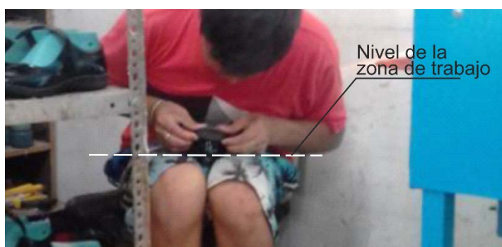
Figura 182. Posición de montaje de horma y suela
