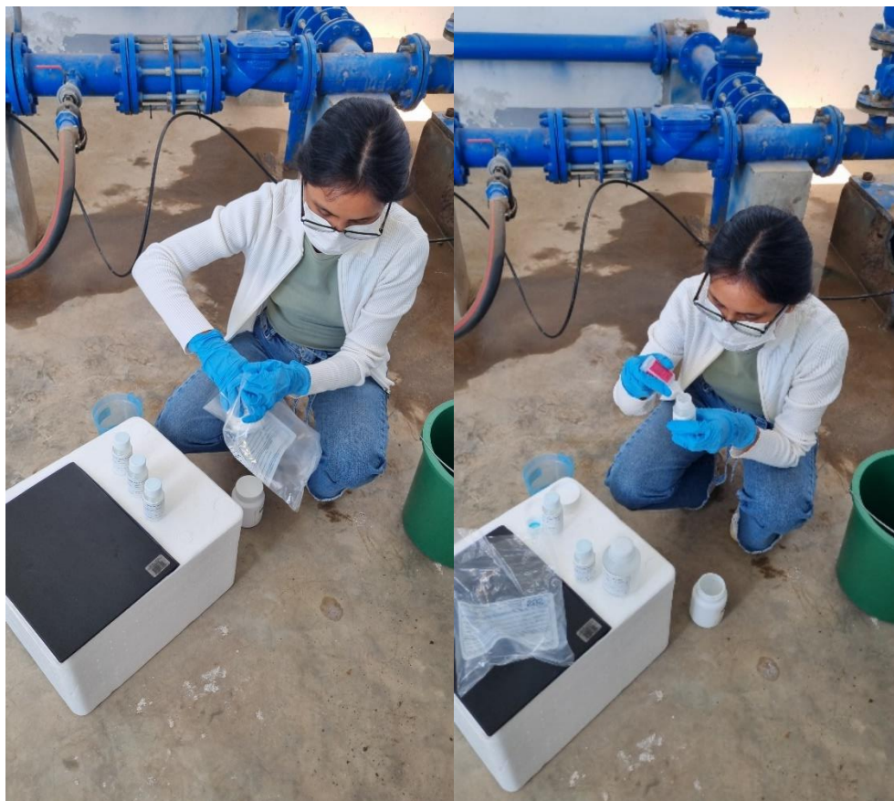
Figura 5: Toma de muestras y preservación.
