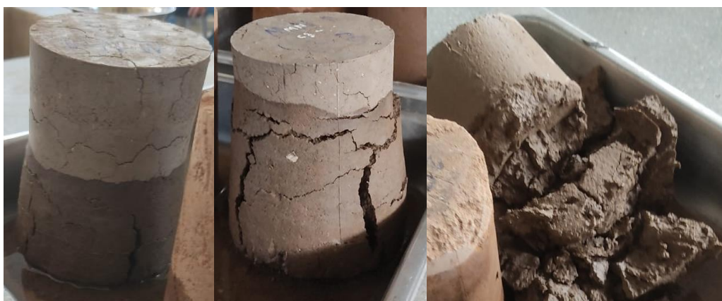
Ilustración 36: Fractura e hinchamiento de Muestra natural.
