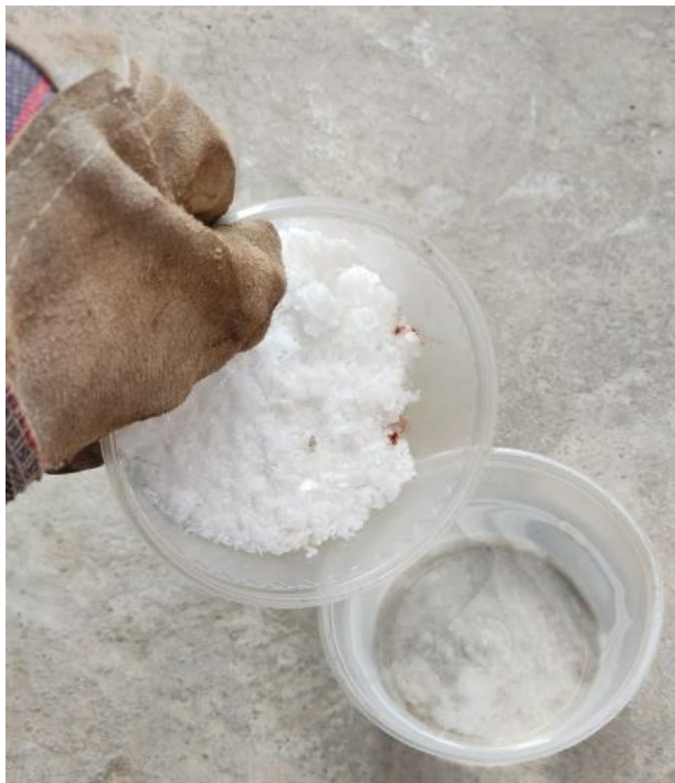
Ilustración 24: Preparación de solución alcalina.
