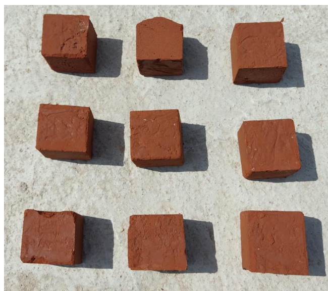
Ilustración 27: Muestras cúbicas de geo polímero elaborado de cerámica.
