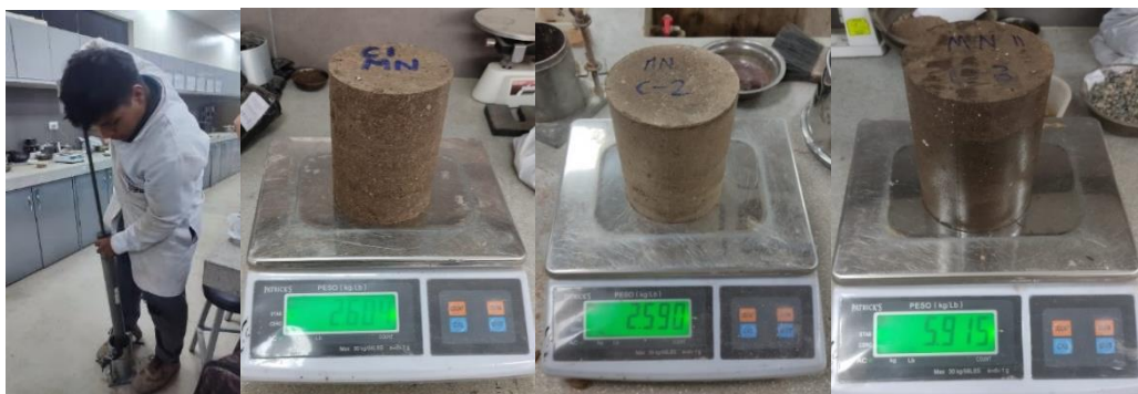
Ilustración 33: Compactación de probetas suelo natural.
