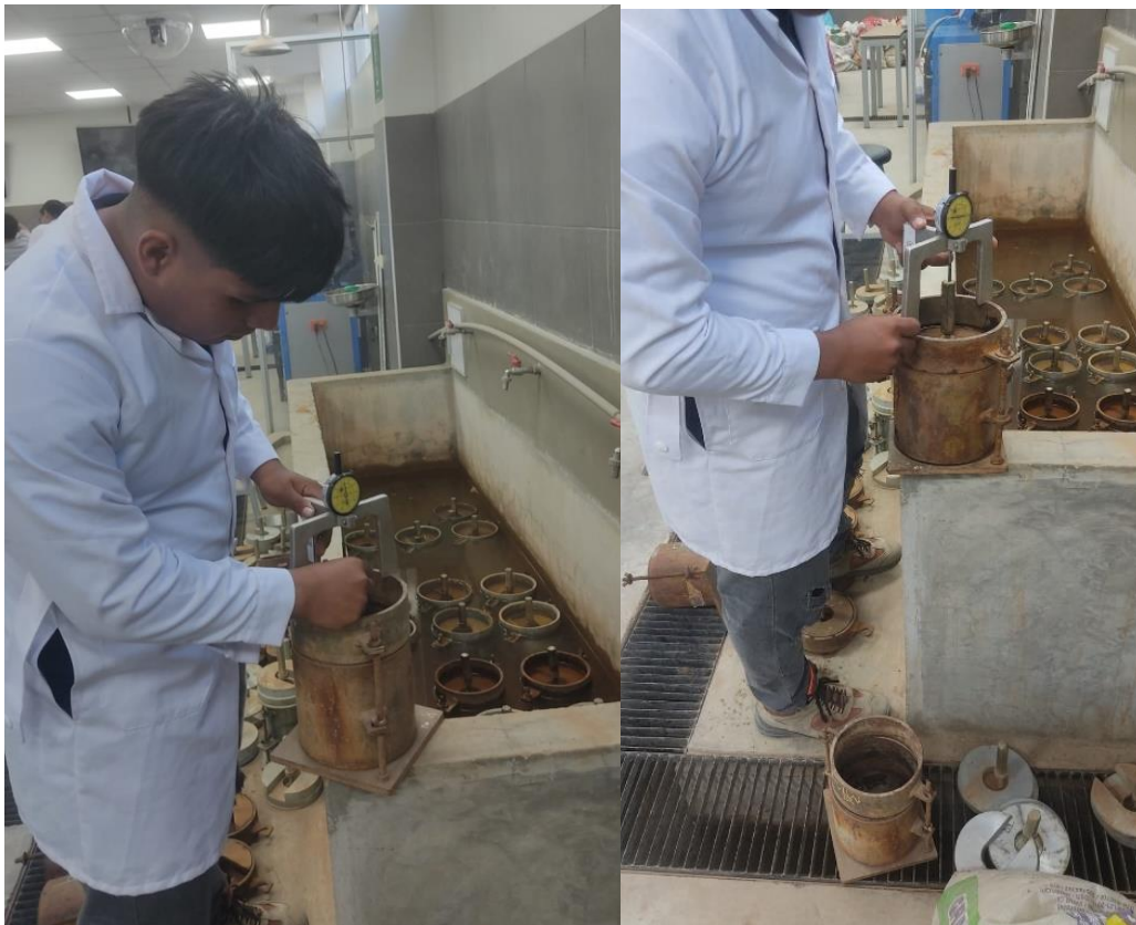
Medición de expansión ensayo de C.B.R.
