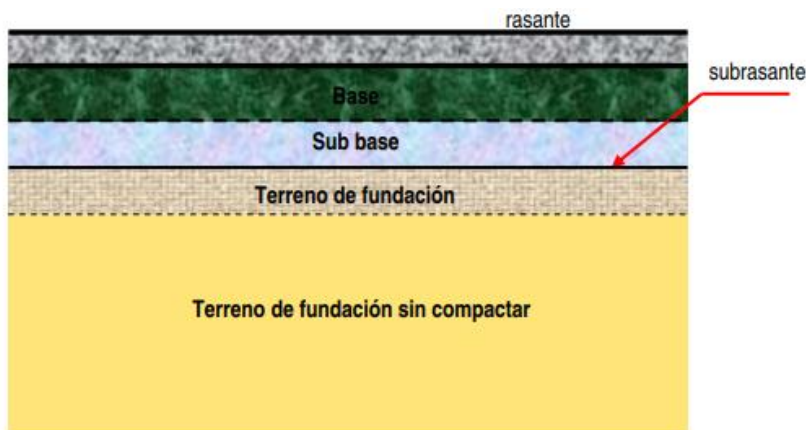
Ilustración 6: Composición de pavimentos asfálticos [28].
