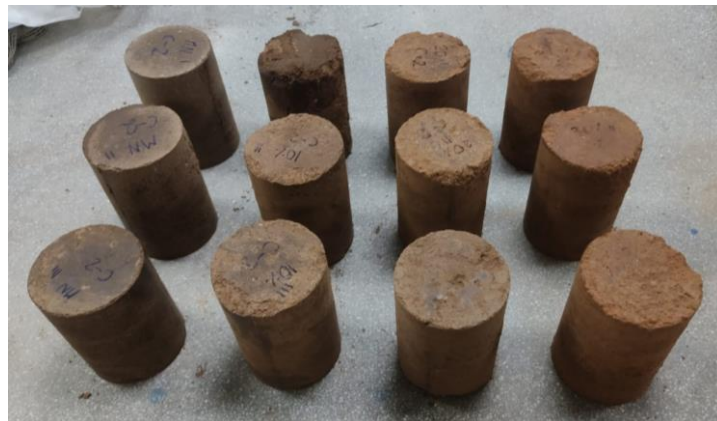
Ilustración 38: Ensayo de compresión- geo polímero de cerámica.
