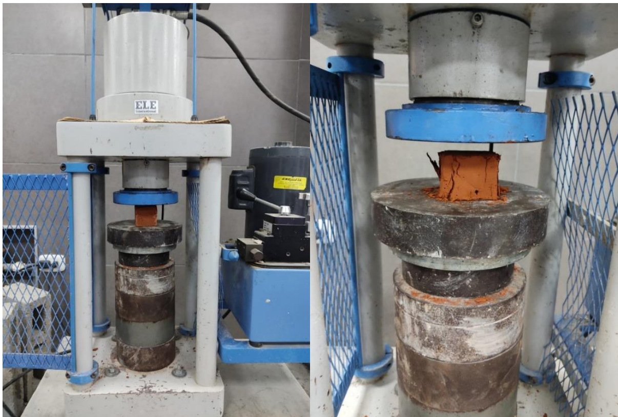
Ilustración 28: Ensayo de probetas cúbicas en máquina de compresión.
