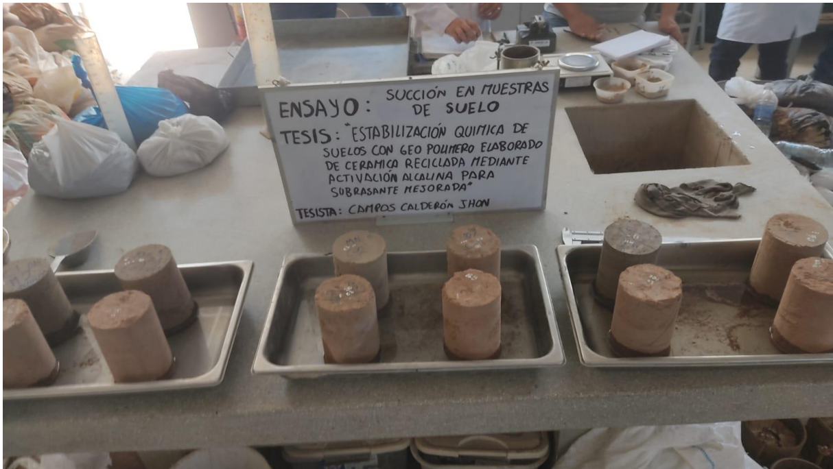
Ensayo de succión muestras de suelo-geo polimero.
