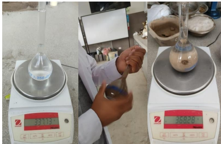
Ilustración 13: Procedimiento ensayo de gravedad específica.
