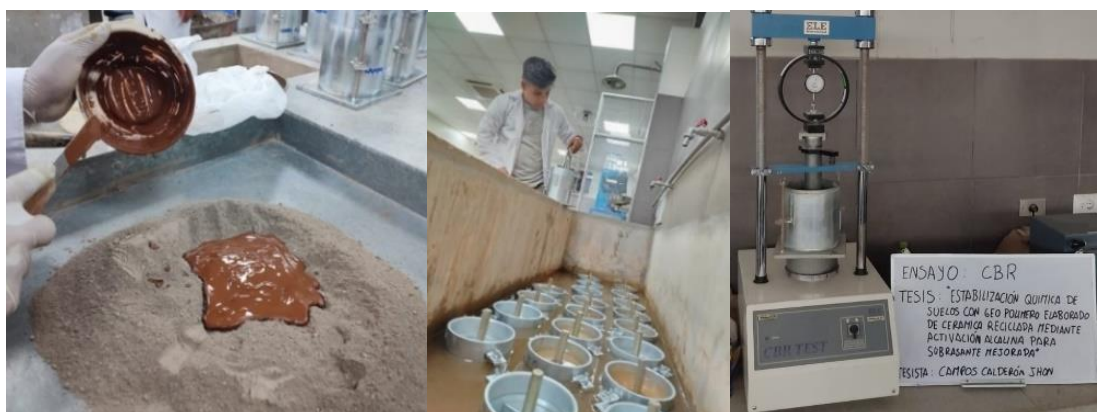
Ilustración 32: Procedimiento ensayo de CBR Suelo-Geo polímero de cerámica.
