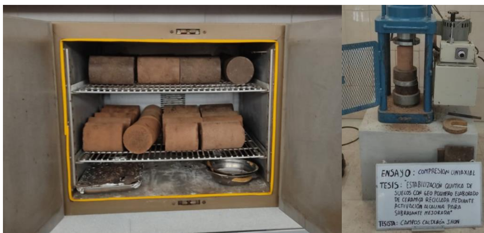
Ilustración 39: Ensayo de compresión probetas Suelo-geo polímero de cerámica.
