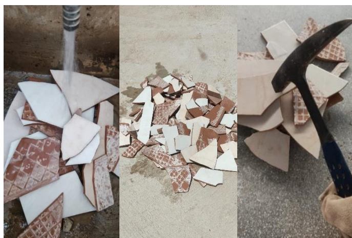
Ilustración 16: Proceso de adecuación de la cerámica reciclada. Lavado, secado y triturado manual.
