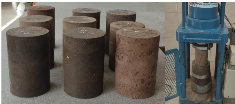
Ilustración 34: Ensayo de compresión de probetas suelo natural.
