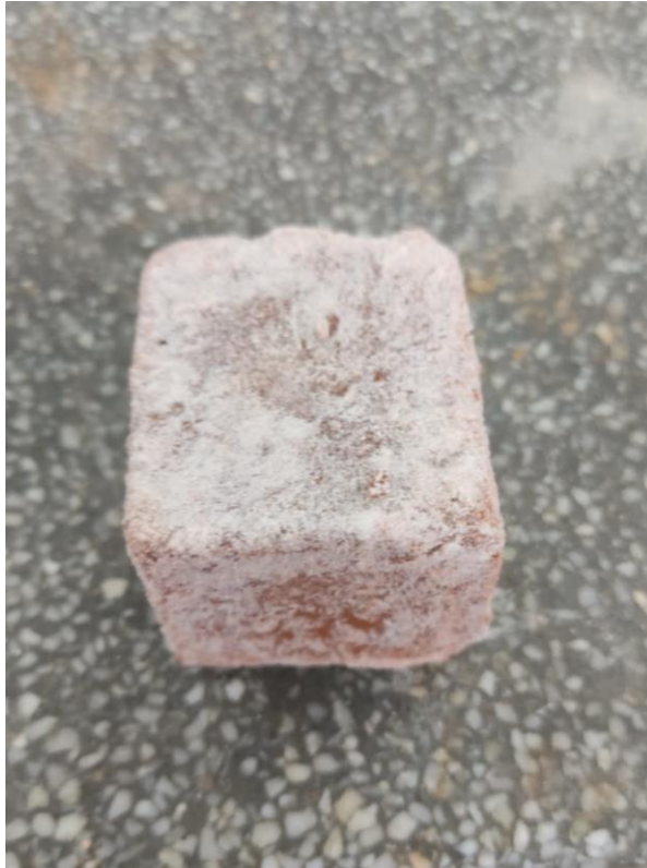
Probeta cubica, cristalización superficial.
