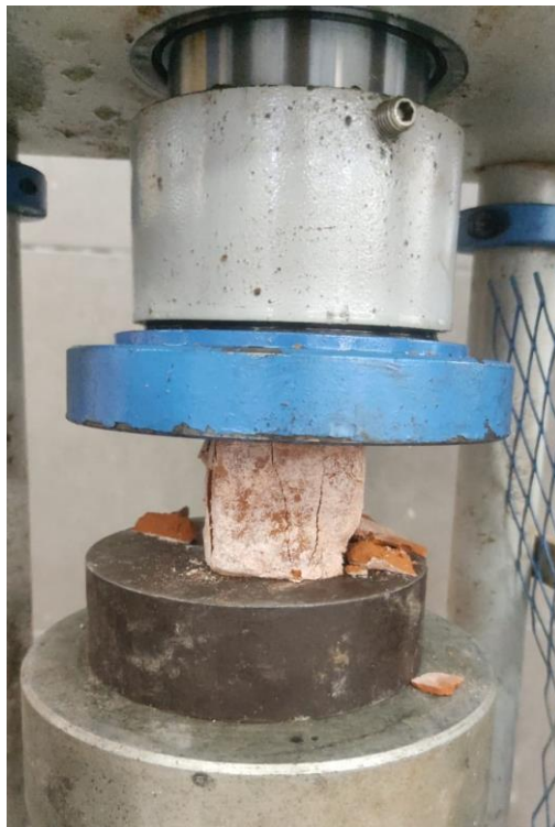
Ensayo de compresión en prensa a probetas cubicas de geo polímero.
