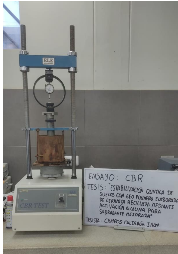
Penetración ensayo de C.B.R.
