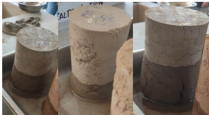
Ilustración 35: Procedimiento ensayo de succión muestras de suelo natural.
