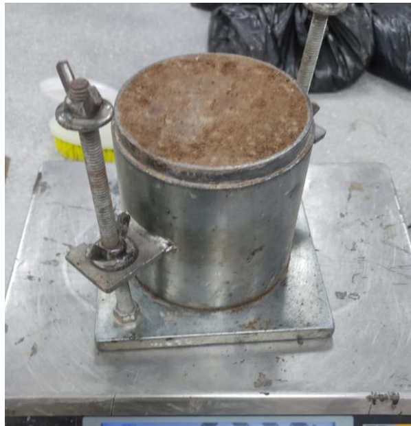
Molde compactado ensayo de Proctor.
