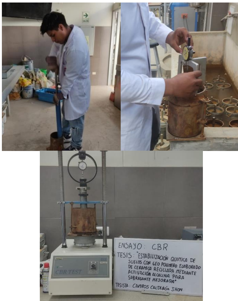
Ilustración 14: Moldes de C.B.R. Compactación, medición, sumersión y penetración.
