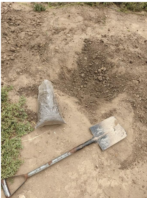
Elaboración de calicatas y muestreo de suelo.
