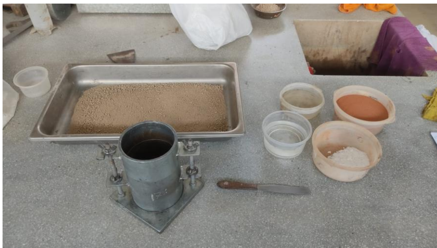
Ensayo de proctor, suelo- geopolimero de ceramica.
