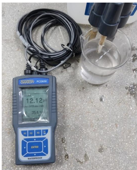
Ilustración 22: Medición de pH, mediante medidor multiparámetro.
