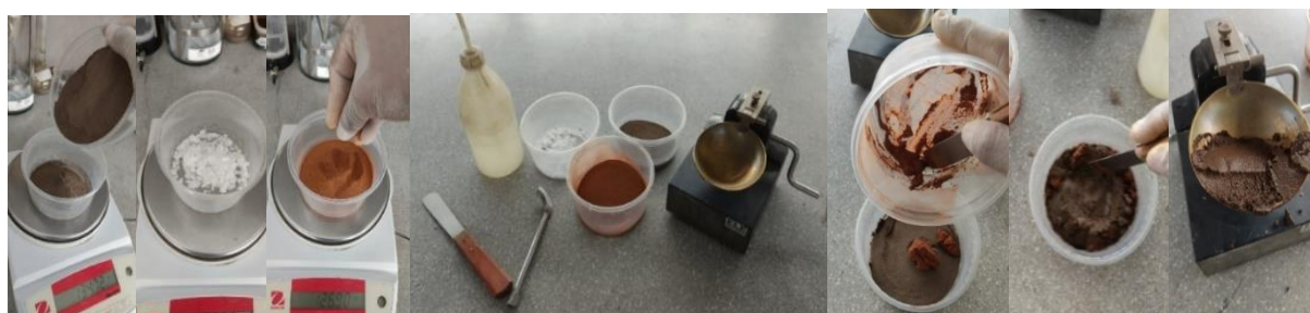
Ilustración 30: Preparación de la muestra para el ensayo de Límites de Atterberg.
