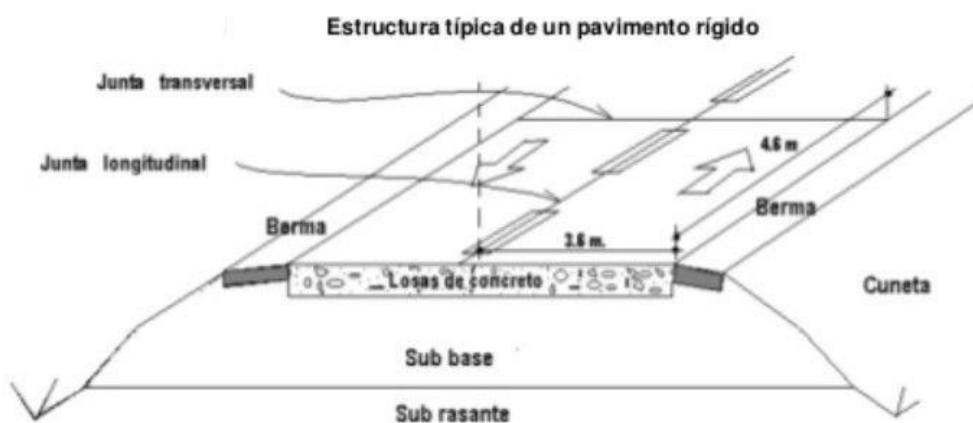
Ilustración 9: Estructura típica de un pavimento rígido [29].
