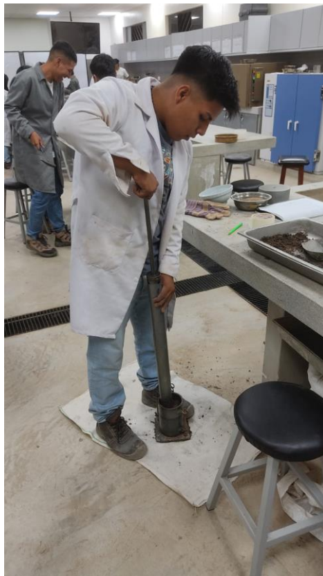
Ensayo de Proctor.
