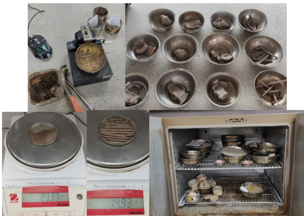
Ilustración 12: Realización del ensayo de límites de Atterberg para muestra natural por calicata.
