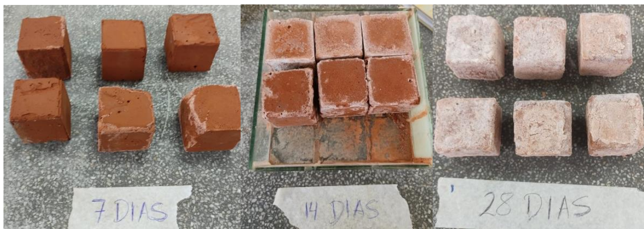
Ilustración 29: Aspecto de muestras de geo polímero según tiempo de curado.
