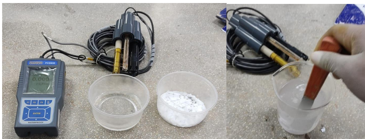
Ilustración 21: Preparación de la muestra para evaluación de pH.
