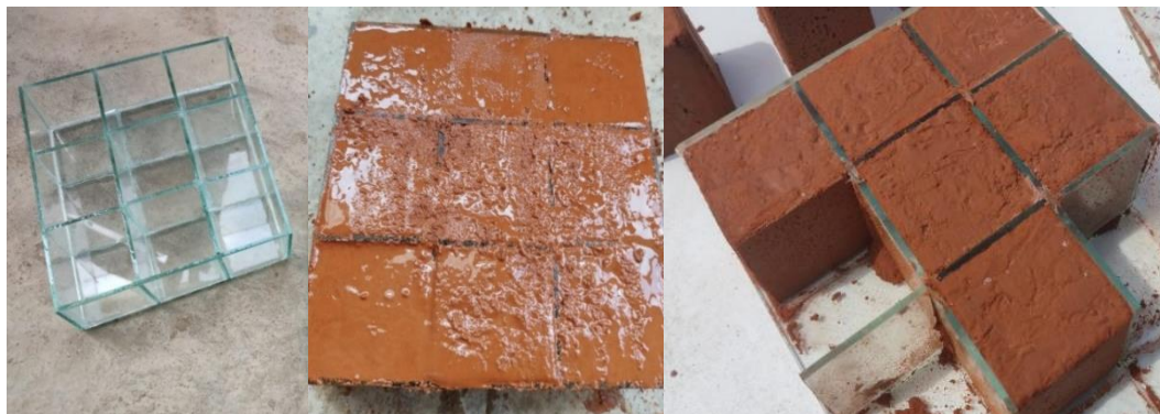
Ilustración 26: Llenado, desmoldado de probetas cúbicas.
