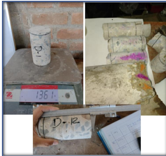
Figura 19: Muestras de núcleos diamantinos extraídos de la I.E. 11025
