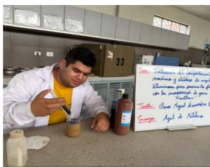
Fig 11. Ensayo de azul de metileno
