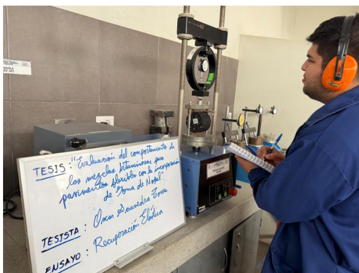
Fig 28. Ensayo Recuperación elástica
