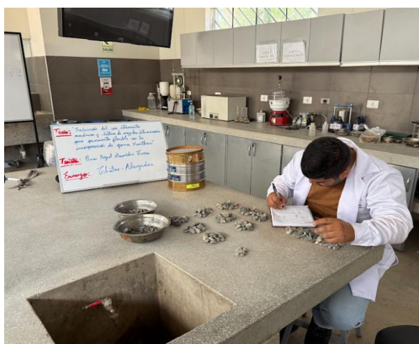
Fig 5. Ensayo las partículas chatas y alargadas del agregado grueso
