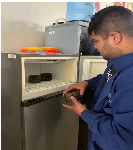
Fig 27. Ensayo Lottman Modificado
