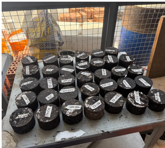
Fig 21. Briquetas de la mezcla patrón y mezcla con adición de goma nopal
