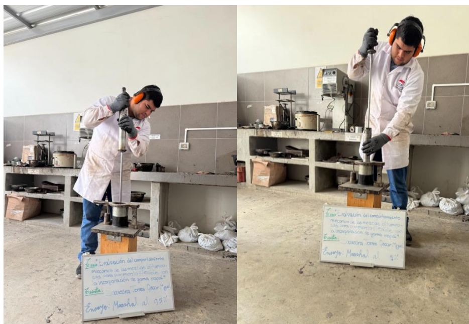
Fig 18. Ensayo Marshall al 0.5% y 1% de goma nopal
