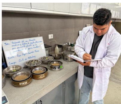
Fig 9. Ensayo de límites de atterberg
