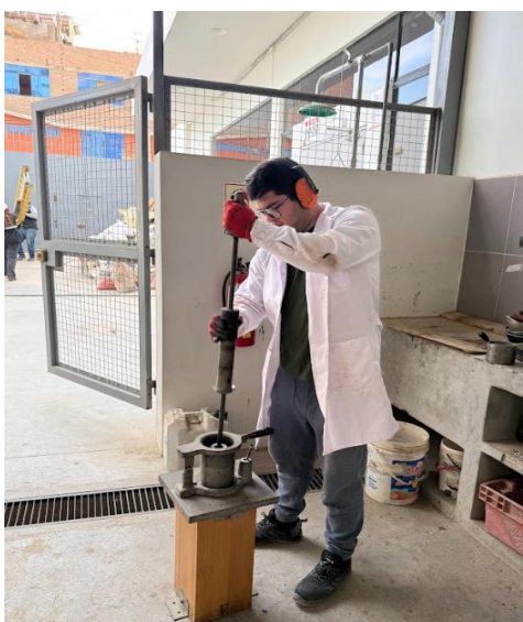
Fig 16. Compactación de briquetas
