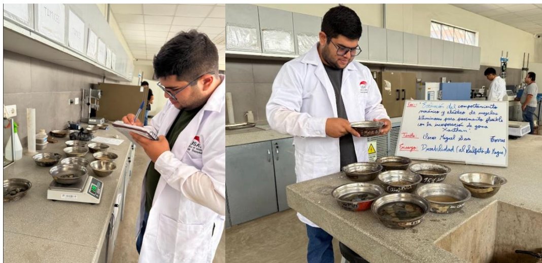
Fig 4. Ensayo de durabilidad al sulfato de magnesio
