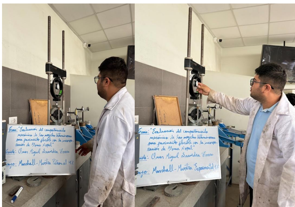
Fig 23. Ensayo de Estabilidad y Flujo de las briquetas.
