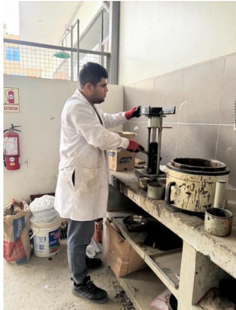
Fig 17. Desmoldado de las briquetas
