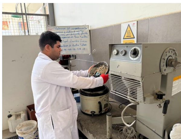
Fig 14. Homogenización de mezcla asfáltica
