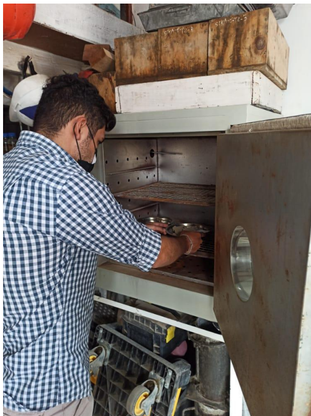
Fotografía 23 Ensayo de contenido de humedad
