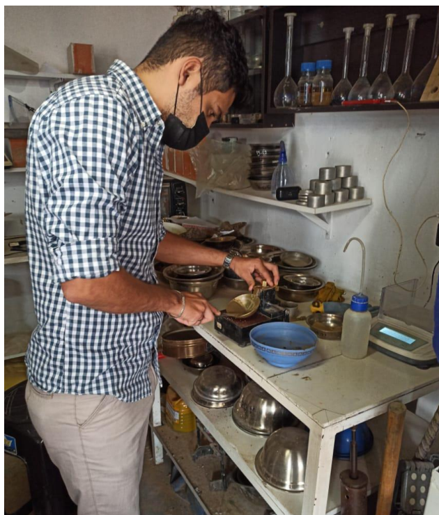
Fotografía 24 Ensayo de limite liquido
