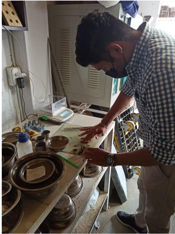
Fotografía 25 Ensayo de Limite Plástico
