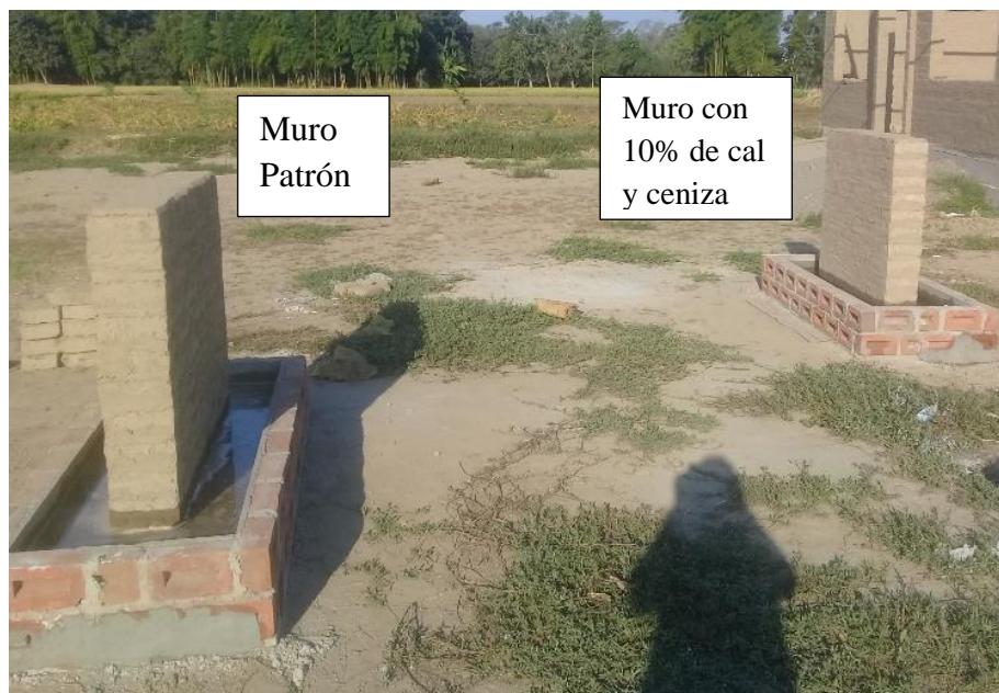
Fig. 118: Inundación de ambos canales o pozas
