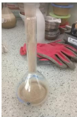
Fig. 65: Colocación de suelo en la fiola
