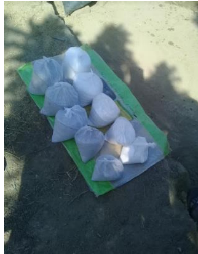
Fig. 69: Dosificaciones de cal y ceniza para la fabricación de Adobes Se dejó reposar el barro por 24 horas y se procedió a la elaboración 5 unidades de adobe de cada dosificación.
