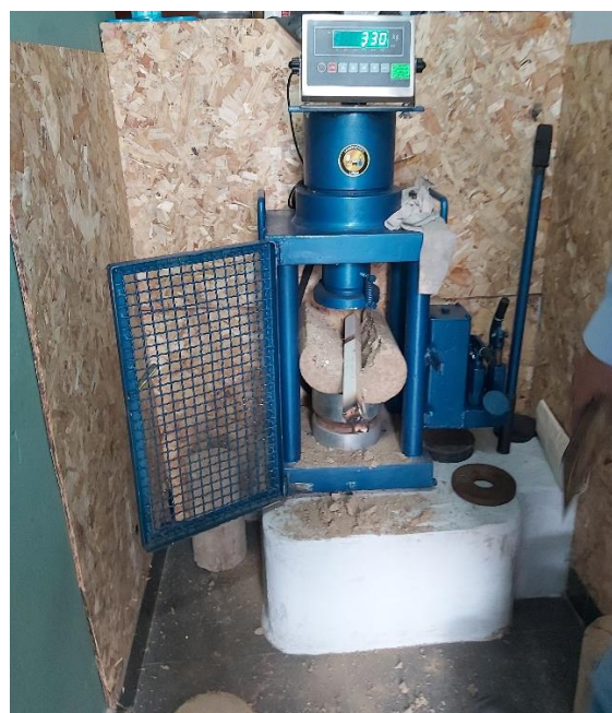
Fig. 103: Muestra de adobe ensayada a tracción
