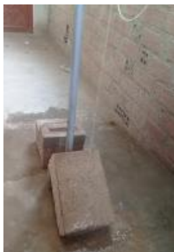
Fig. 83: Ensayo de Erosión Acelerada
