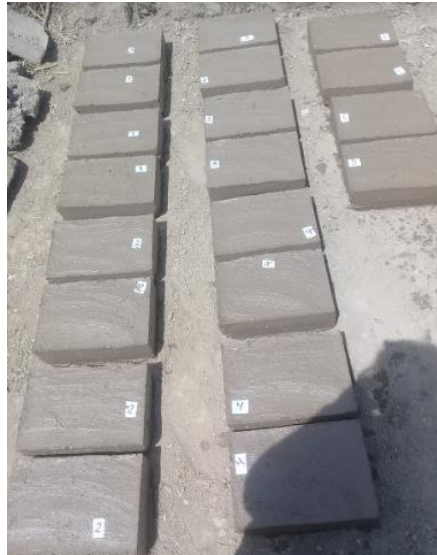
Fig. 72: Almacenamiento de las unidades de adobe
