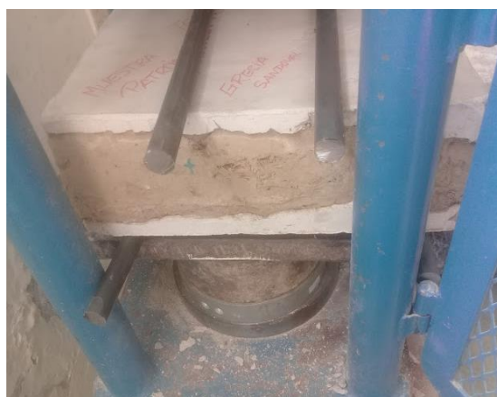
Fig. 89: Mecanismo para simular el sistema de cargas aplicado
