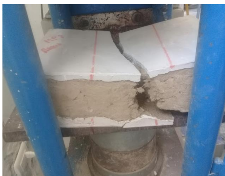
Fig. 90: Falla producida por la aplicación de la carga
