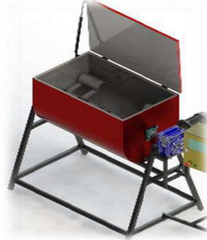
Figura 7: Máquina fermentadora de cacao 80kg.
