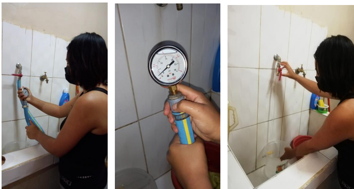
Figura 52: Presión y caudal en vivienda del Sector
