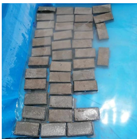
Figura 30: Curado de adoquines
