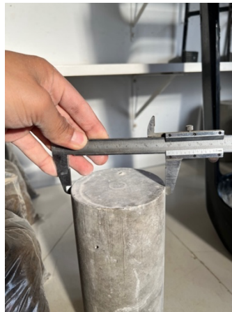
Ilustración 25: Diámetro de probeta
