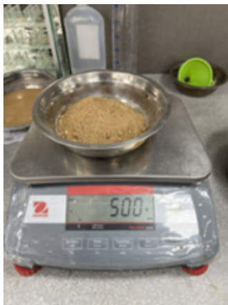
Ilustración 3: Peso agregado fino húmedo
