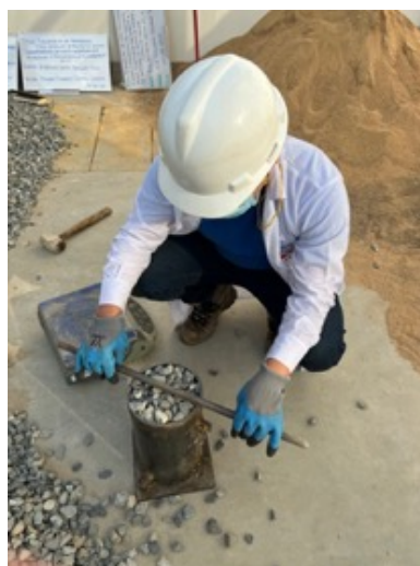
Ilustración 21: Varillado de agregado grueso
