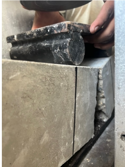
Ilustración 29: Rotura de viga ensayada a flexión
