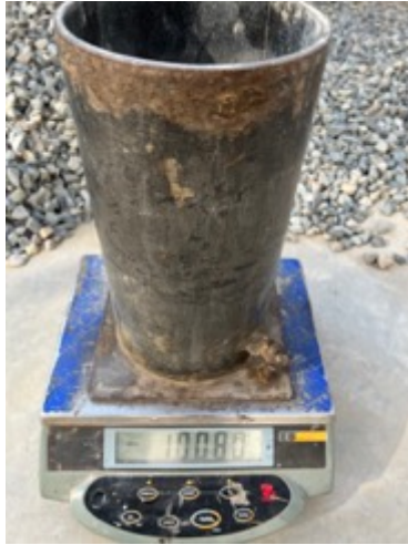
Ilustración 19: Peso de molde vacío
