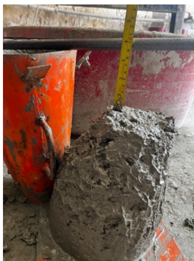
Ilustración 24: Asentamiento concreto con fibras de acero y microsilice
