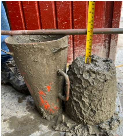
Ilustración 22: Asentamiento de concreto patrón
