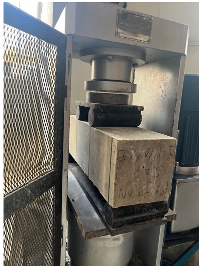
Ilustración 30: Viga sometida a flexión
