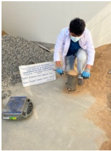
Ilustración 17: Varillado de agregado fino
