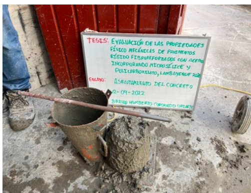
Ilustración 23: Asentamiento patrón 4 pulgadas
