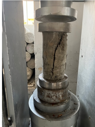
Ilustración 26: Probeta sometida a compresión
