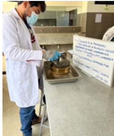
Ilustración 4: Tamizado agregado fino
