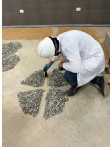
Ilustración 6: Cuarteo de agregado grueso
