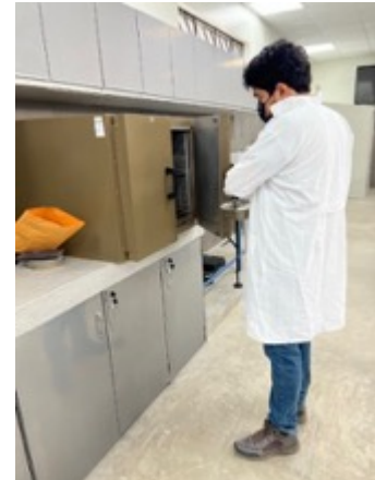
Ilustración 5: Colación horno agregado fino
