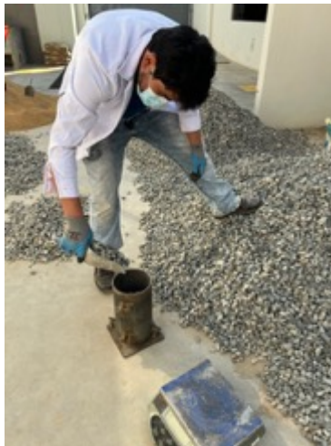
Ilustración 18: Vaciado de agregado grueso a molde
