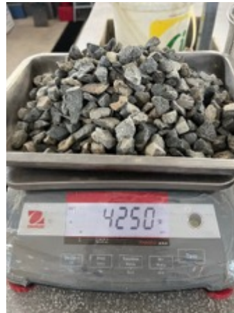
Ilustración 8: Peso húmedo agregado grueso
