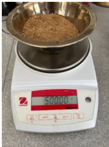
Ilustración 10: Peso agregado fino para peso específico
