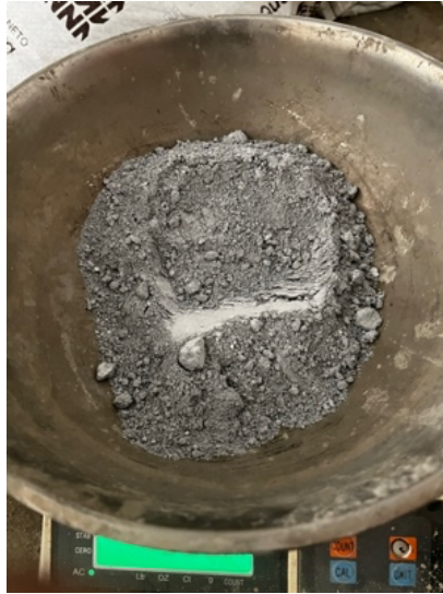
Ilustración 32: Micro sílice en balanza
