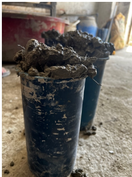
Ilustración 31: Llenado de probeta con adiciones
