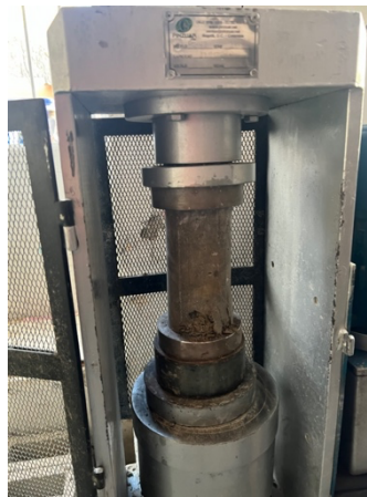
Ilustración 27: Probeta ensayada a compresión
