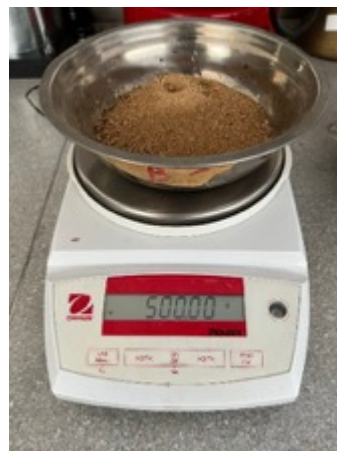
Ilustración 9: Peso húmedo de la arena
