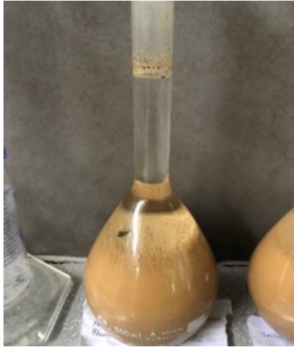
Ilustración 14: Fiola con agregado fino
