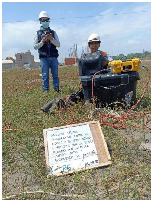
FOTOGRAFÍA 01: Adquisición de datos del RS-1, con el sismógrafo SEISMEX 24.
