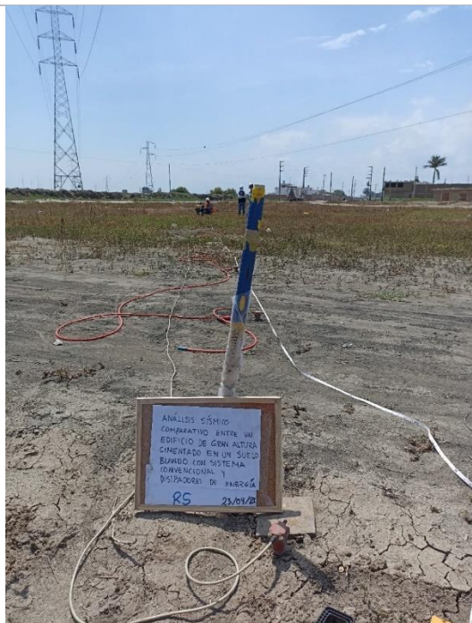
FOTOGRAFÍA 05: Tendido del cable sísmico y el triger.
