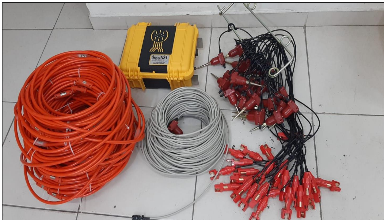
Figura 9. Equipos empleados en la Refracción Sísmica, GEODE24. Fuente: Equipo Propio
