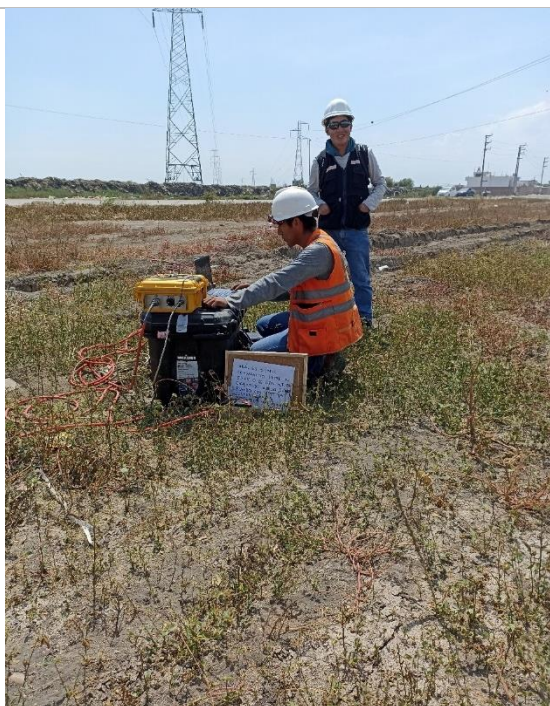
FOTOGRAFÍA 07: Adquisición de datos del MASW-1, con el sismógrafo SEISMEX 24.
