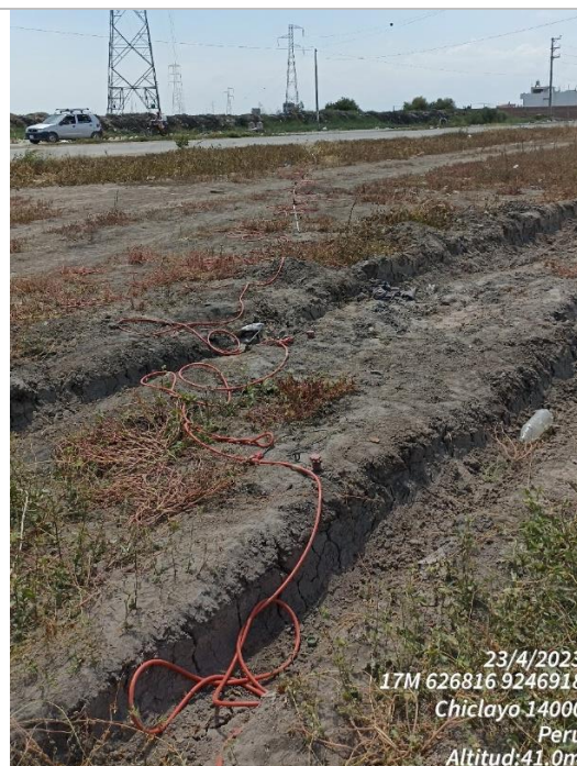
FOTOGRAFÍA 04: Geófonos conectados al cable sísmico.
