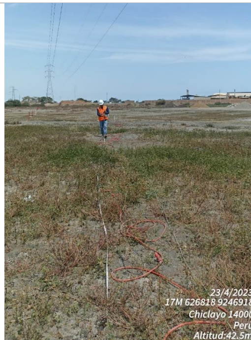
FOTOGRAFÍA 06: Personal de campo tendiendo el cable sísmico y colocando los geófonos.
