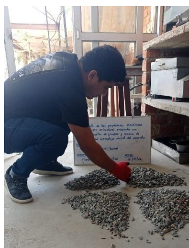
Figura N°6. Cuarteo de agregado grueso. Fuente: Propia
