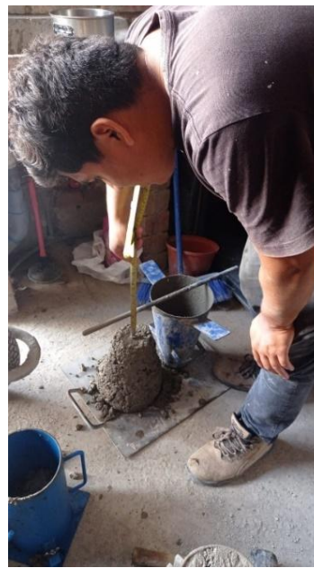
Figura N°16. Medición de Slump- concreto patrón. Fuente: Propia
