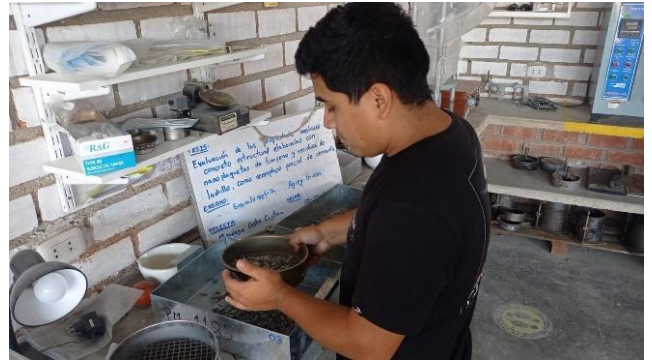
Figura N°8. Granulometría agregado grueso. Fuente: Propia
