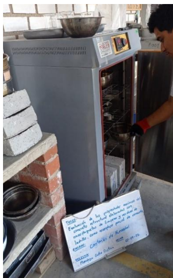
Figura N°11. Colocación de muestras en horno- contenido de humedad-absorción. Fuente: Propia
