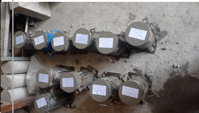
Anexo 5.2: Moldeado de concreto patrón f'c: 210
