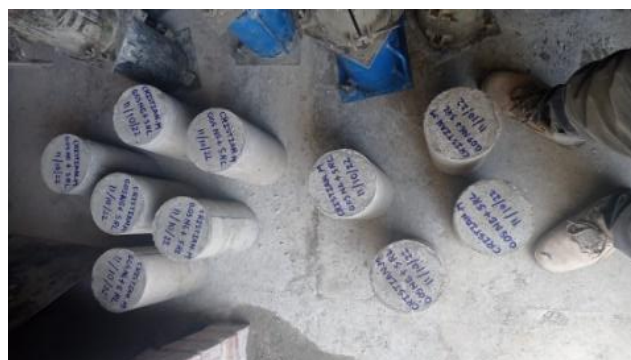
Figura N°19. Desencofrado de probetas Fuente: Propia
