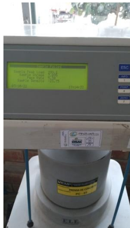
Anexo9.1: Carga de ensayo a los 28 días – muestra Patrón.
