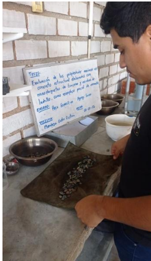
Anexo 4.11: Peso específico del agregado grueso-condición saturada superficialmente seca.
