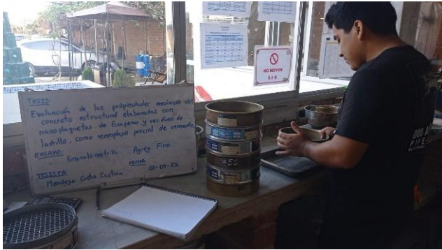
Figura N°7. Granulometría agregado fino. Fuente: Propia
