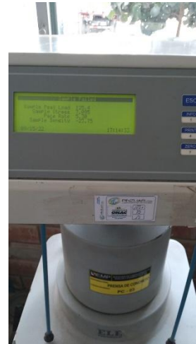
Anexo9.7: Carga de ensayo a los 28 días – muestra experimental 0.1%NG+3%RL
