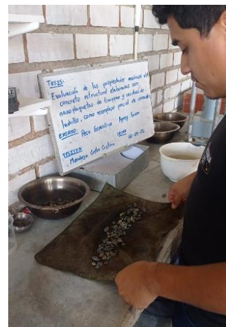
Figura N°10. Peso específico agregado grueso. Fuente: Propia
