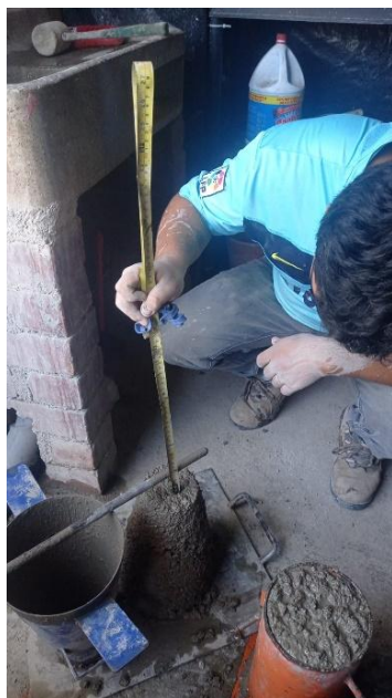
Figura N°15. Medición de Slump. Fuente: Propia
