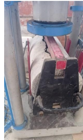
Figura N°22. Ensayo de resistencia a la tracción. Fuente: Propia
