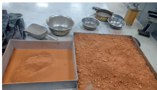
Figura N°4. Tamizado de Residuo de ladrillo. Fuente: Propia
