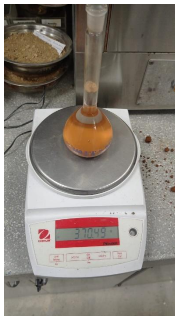
Figura N°14. Peso específico del residuo de ladrillo en polvo. Fuente: Propia
