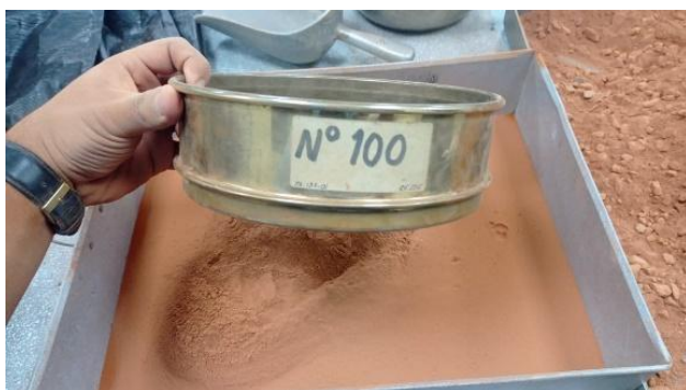
Figura N°3. Tamiz por el que se pasó lo. residuos de ladrillo. Fuente: Propia
