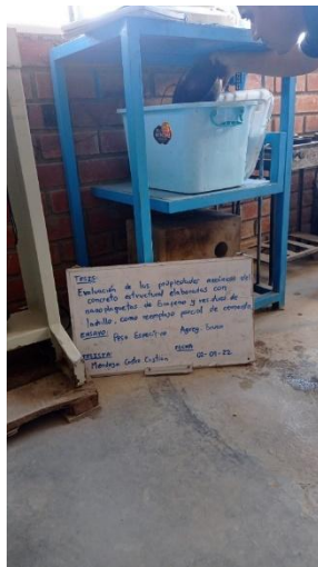
Anexo 4.13: Peso específico del agregado grueso-agregado sumergido en la canastilla.
