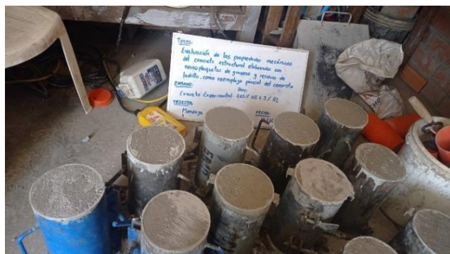
Figura N°18. Testigos para el concreto experimental. Fuente: Propia
