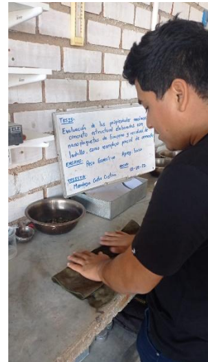
Anexo 4.12: Peso específico del agregado grueso-condición saturada superficialmente seca.
