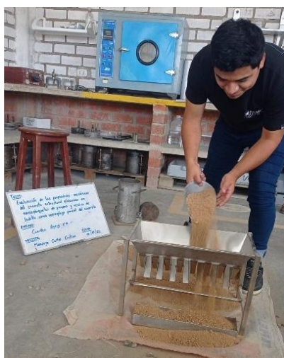
Figura N5. Cuarteo de agregado fino. Fuente: Propia
