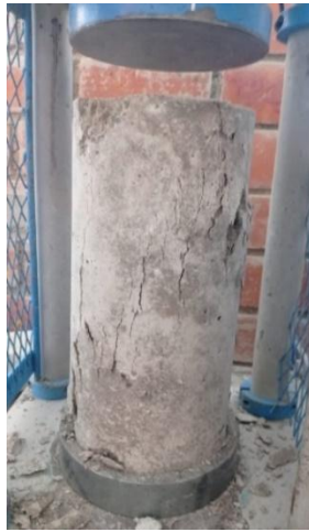
Figura N°21. Ensayo de resistencia a la compresión. Fuente: Propia
