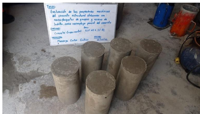
Anexo 5.4: Desmoldeo de testigos de concreto experimental.
