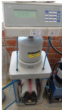
Anexo9.5: Carga de ensayo a los 28 días – muestra experimental 0.05%NG+5%RL
