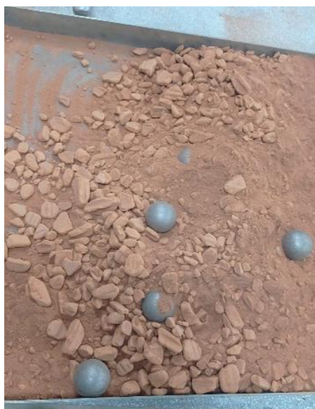
Figura N°2. Residuos de ladrillo sacados de la máquina de los Ángeles. Fuente: Propia
