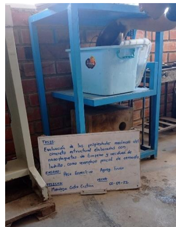
Figura N°12. Sumergimiento de canastilla para obtención de peso específico de agregado grueso. Fuente: Propia
