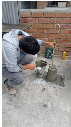
Anexo 6.1: Slump 3" – Concreto Patrón
