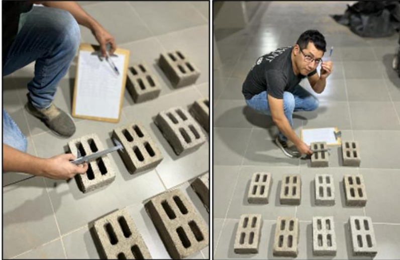
Ilustración 12: Ensayo variación D. con Pie de Rey
