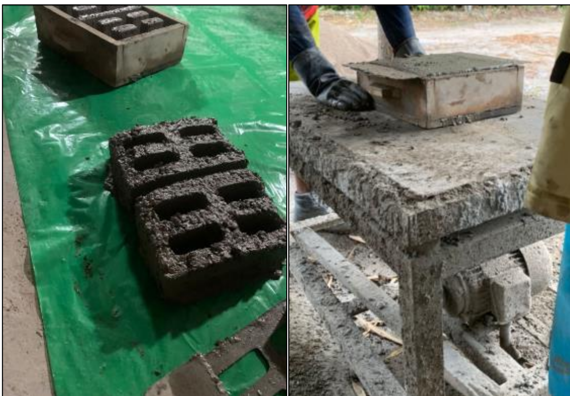
Desmoldaje sin vibración - vibración Unidad de albañilería.
