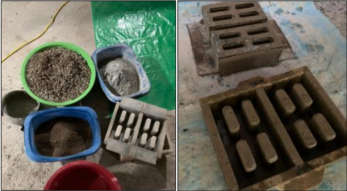
Agregados y desmolde de ladrillo concreto tipo 10
