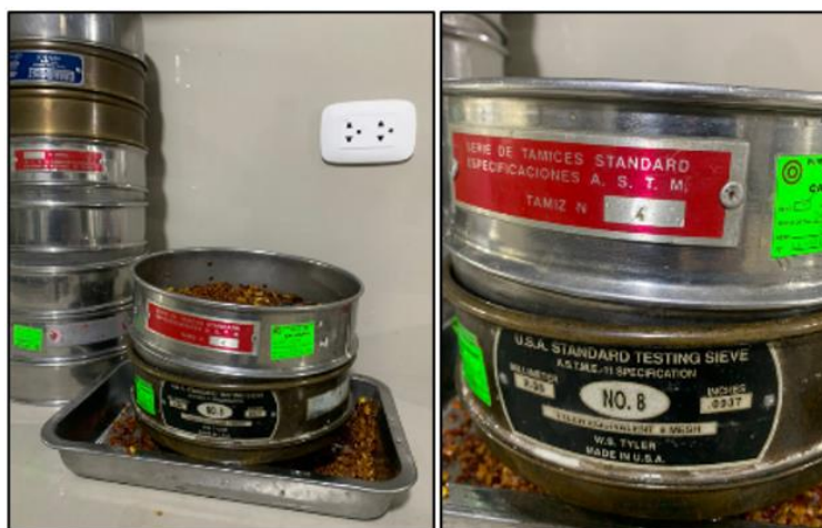
Ilustración 4: Tamizado (n° 04 y 08) de cascara M.F.
