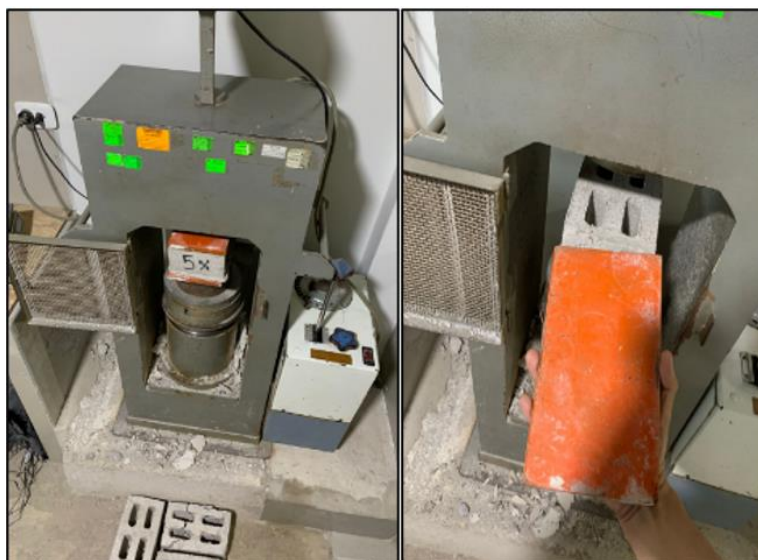
Ilustración 8: Máquina de ensayo a compresión y base metálica
