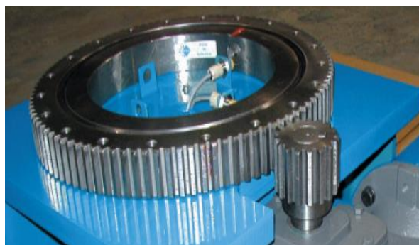
Figura 17. Transmisión Piñón - Corona.
