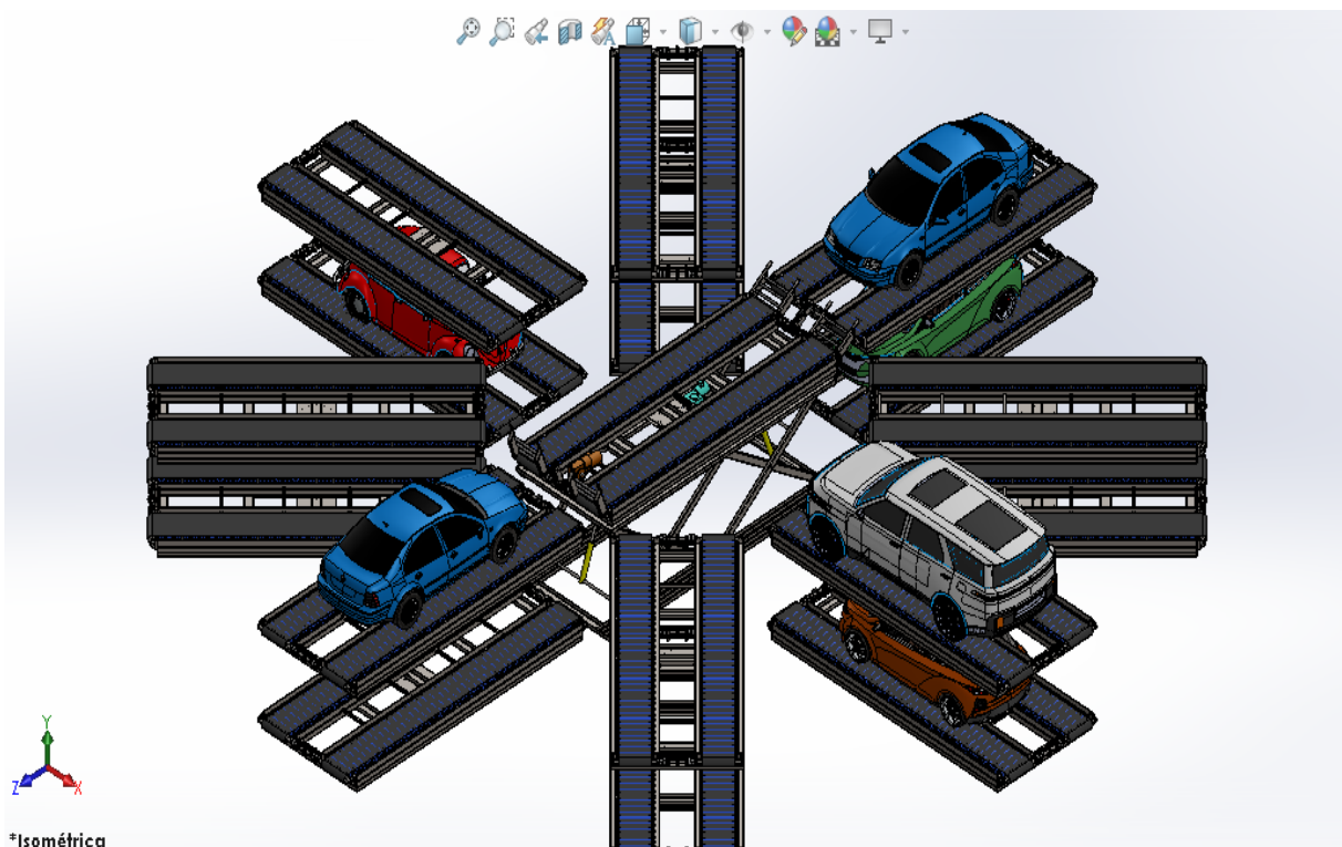
Anexo 39. Retorno de la plataforma principal a su posición inicial en el segundo nivel.
