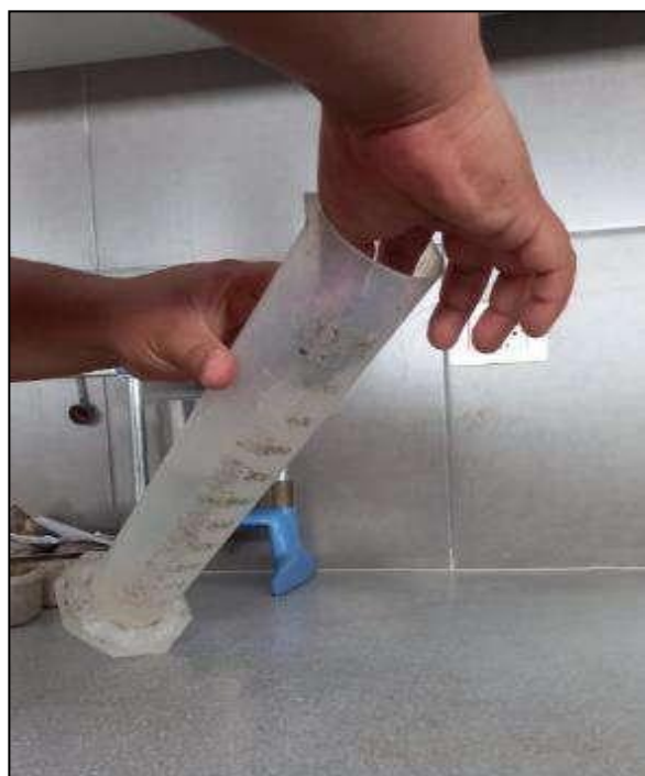
Figura 21. Adición de la muestra para poder calcular la diferencia de volumen. Fuente: Elaboración Propia.
