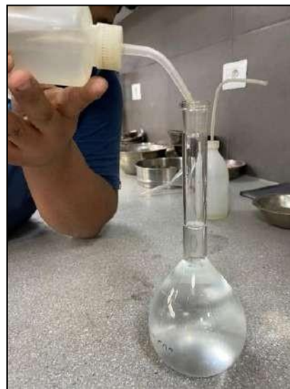
Figura 23. Proceso de llenado de la Fiola. Fuente: Elaboración Propia.
