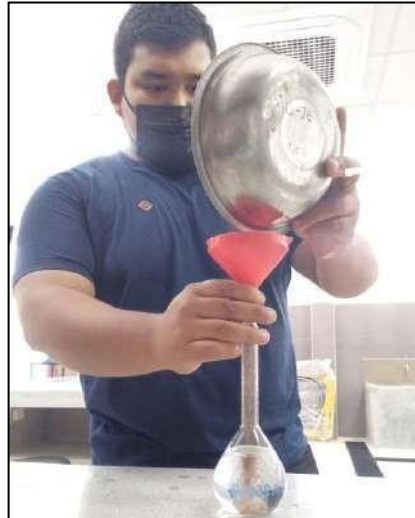
Figura 24. Proceso de llenado de la Fiola con la muestra. Fuente: Elaboración Propia.
