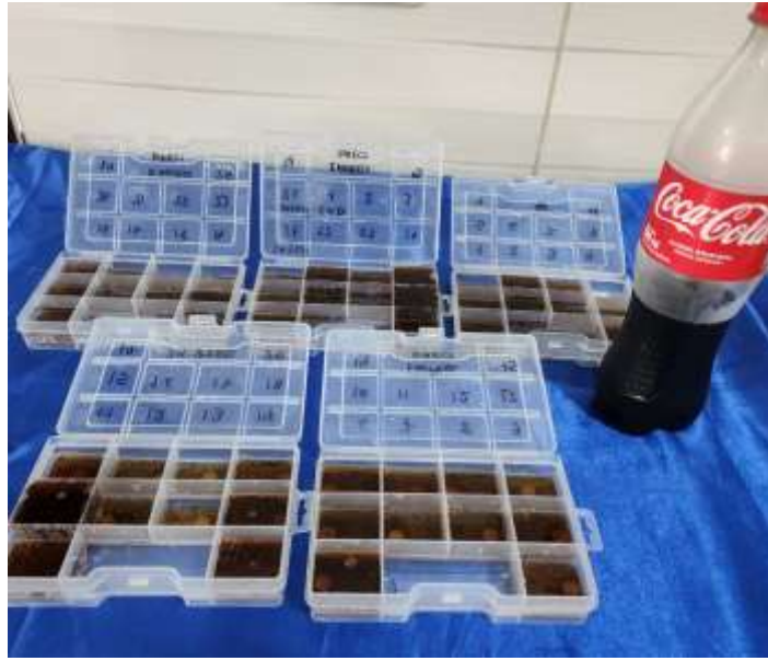
Figura 7: Bloques de resinas, sometidas a bebida carbonatada Coca – Cola.
