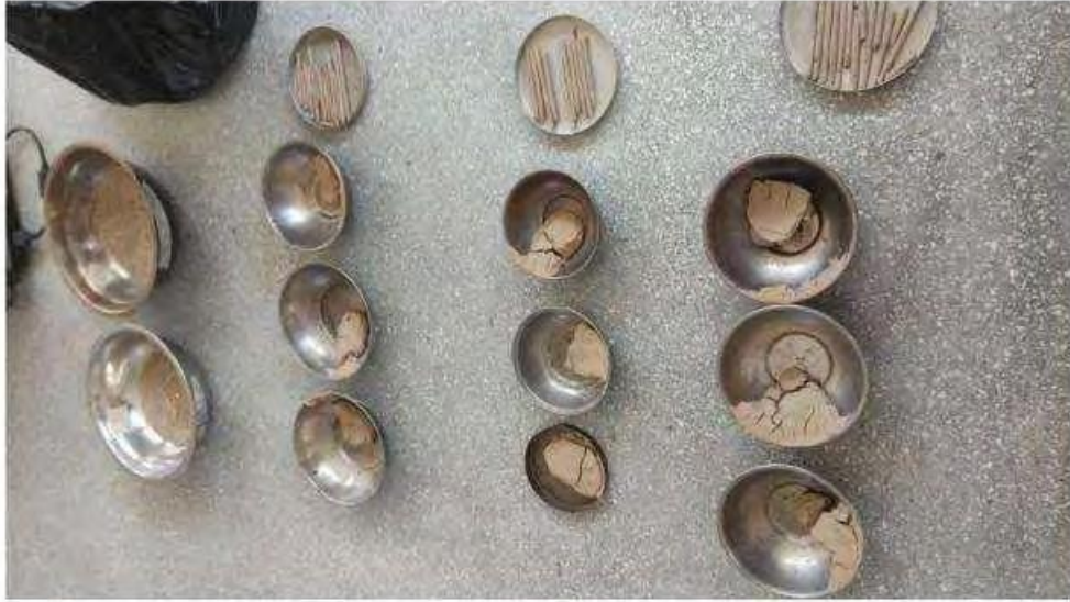
Figura 12: Pesos secos de muestras para límite líquido - límite plástico.
