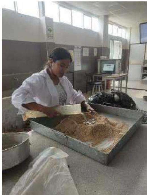
Figura 19: Mezclando muestra natural+arena de mar para CBR
