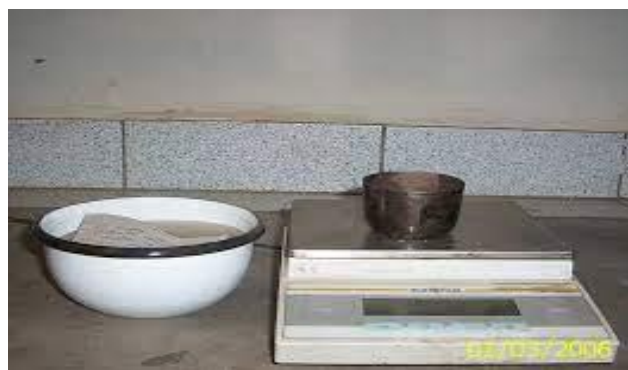
Ilustración 28 Ensayo de Contenido de Humedad del Suelo
