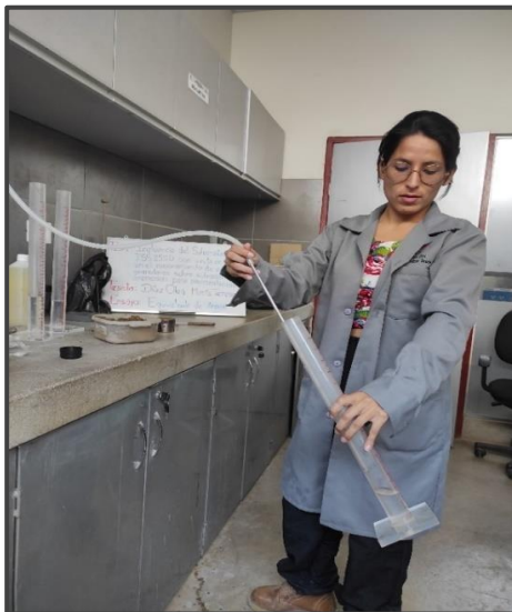
Ilustración 29: Llenado con agua desionizada
