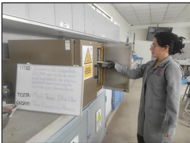
Ilustración 25: Ingreso de la muestra de afirmado al horno
