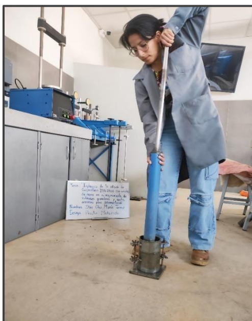
Ilustración 38: Compactación de las muestras
