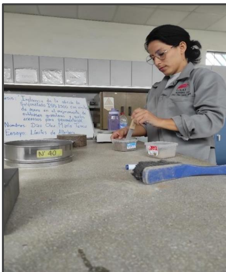
Ilustración 20: Amasado con espátula para consistencia requerida
