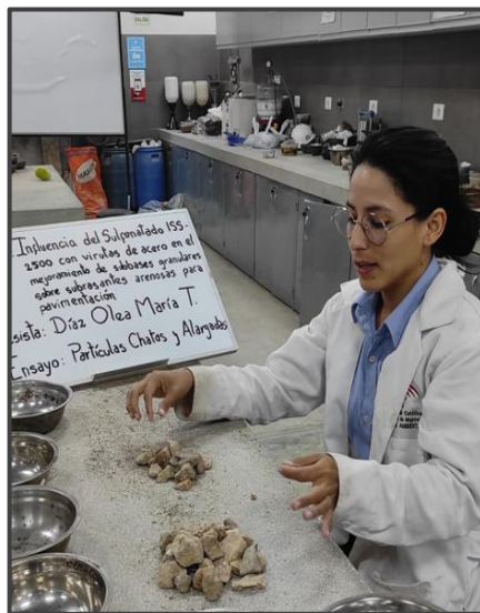
Ilustración 28: Clasificación de partículas chatas y alargadas
