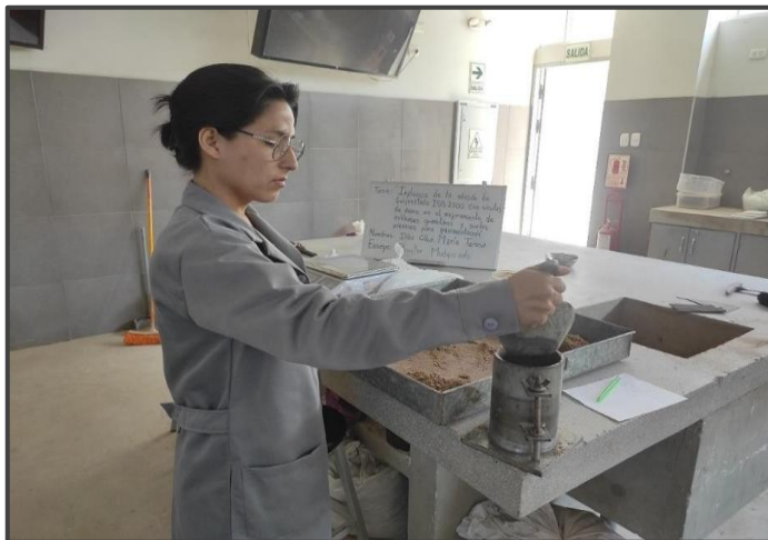
Ilustración 37: Introducción del suelo natural al molde
