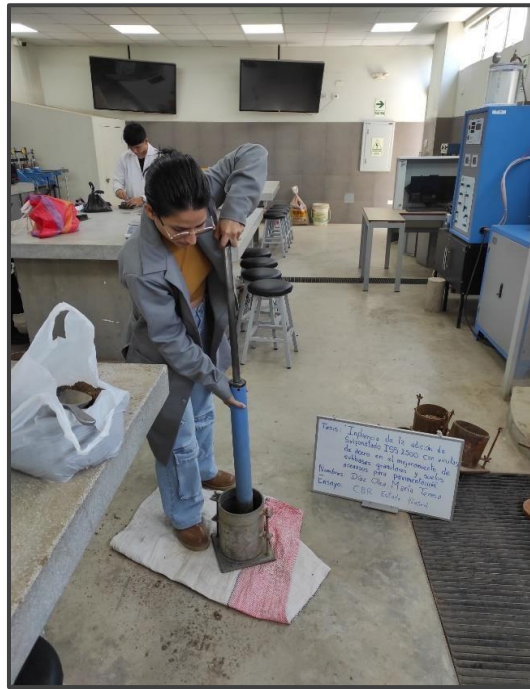
Ilustración 41: Ensayo CBR al suelo natural
