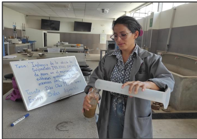
Ilustración 34: Preparación del extracto acuoso
