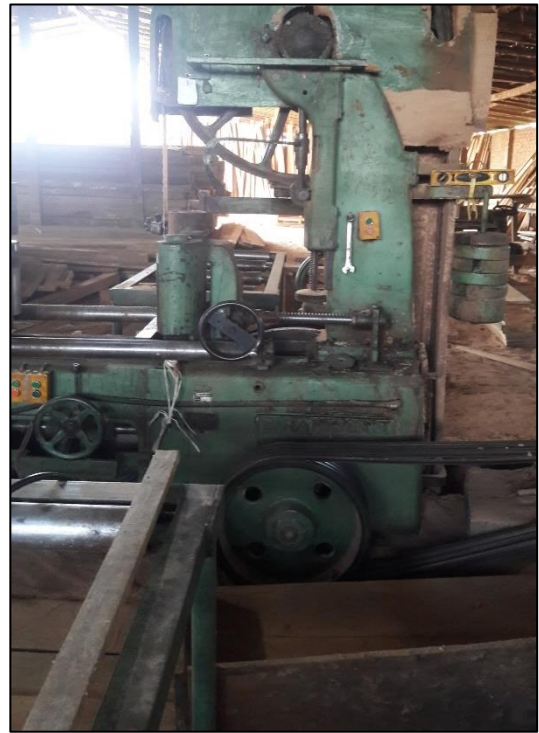
Máquina Cortadora sin guardas de seguridad
