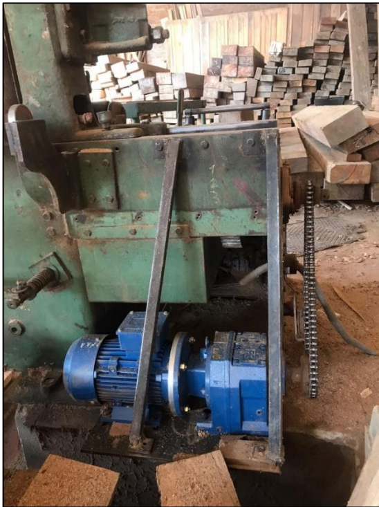
Máquina Cortadora sin guardas de seguridad
