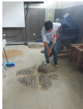
Ilustración:7 Procedimiento del cuarteo de los agregados
