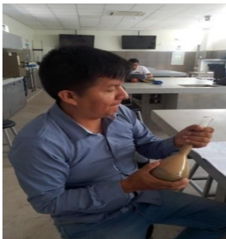
Ilustración 10: Ensayos de absorción y peso específico del agregado fino
