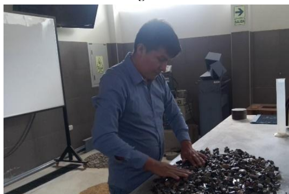
Ilustración 9: Ensayos de absorción y peso específico del agregado
