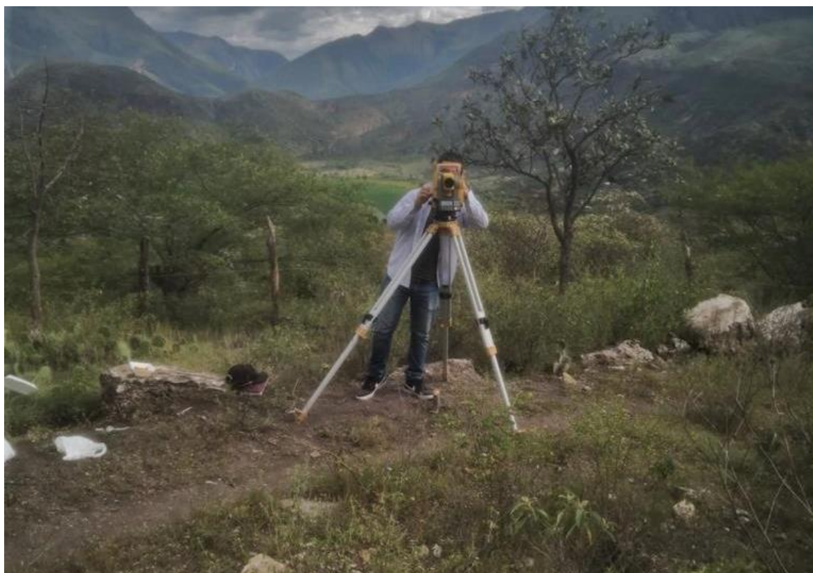
Fotografía 4: Fotografía del levantamiento topográfico con estación total
