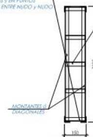
SECCION TRANSVERSAL ARMADURAS 1,5x3 20m
