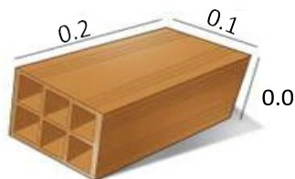
FIGURA N°12: Dimensiones de Ladrillo King Kong 6 Huecos
