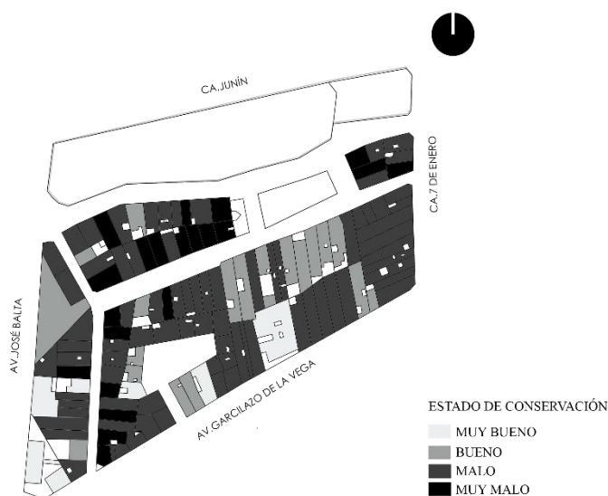
Imagen 9: Estado de conservación Fuente: propia
