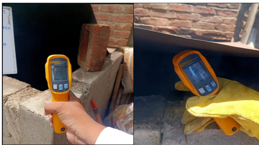
Figura N° 29. Temperatura del quemado de la ceniza de bagazo. Fuente : Propia
