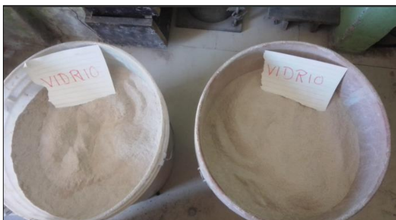
Figura N° 35. Vidrio pulverizado. Fuente : Propia
