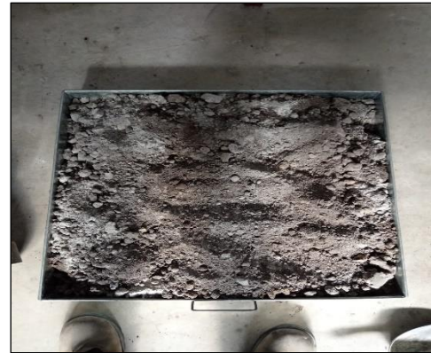
Figura N° 36. Adición del vidrio pulverizado al Suelo Natural. Fuente : Propia
