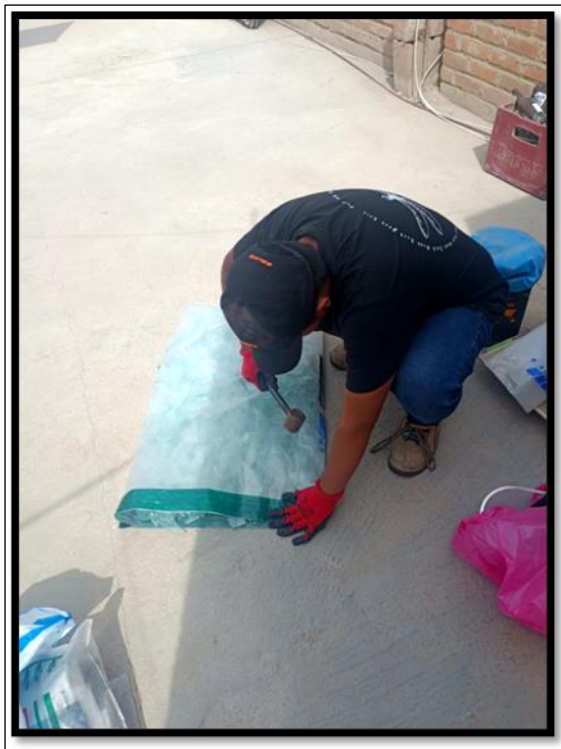
Figura N° 32. Chancado del vidrio obtenido. Fuente: Propia
