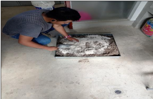
Figura N° 36. Adición del vidrio pulverizado al Suelo Natural. Fuente : Propia
