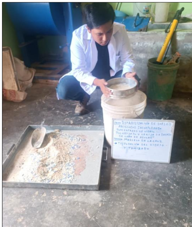
Figura N° 34. Tamizado del vidrio. Fuente : Propia
