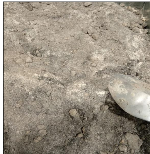
Figura N° 38. Adición del vidrio pulverizado + Ceniza de bagazo al Suelo Natural
