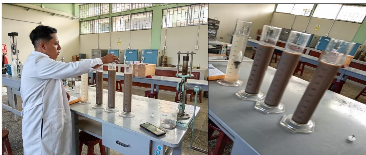
Figura N° 18. Ensayo granulométrico por Hidrómetro. Fuente : Propia
