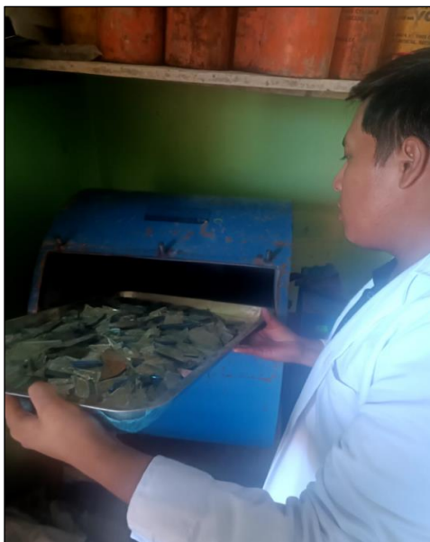
Figura N° 33. Triturado mediante la máquina de abrasión los ángeles. Fuente : Propia
