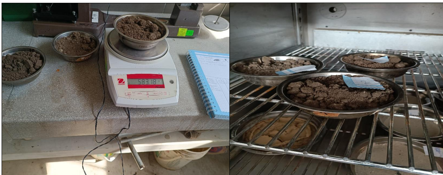
Figura N° 15. Ensayo Contenido de Humedad. Fuente: Propia
