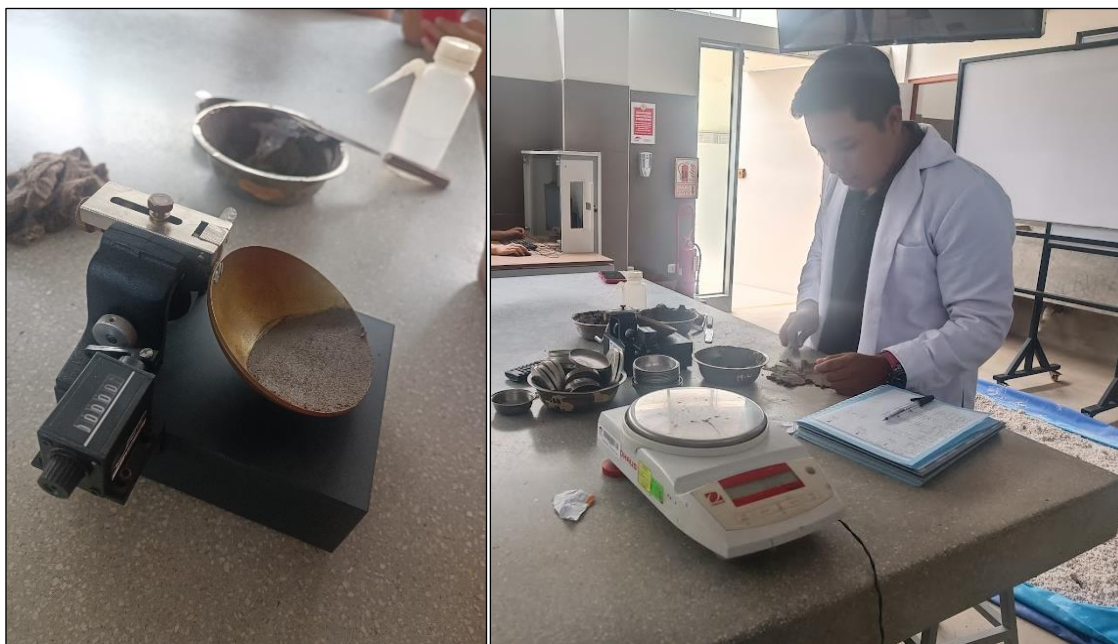
Figura N° 19. Ensayo del Límite Líquido. Fuente Propia
