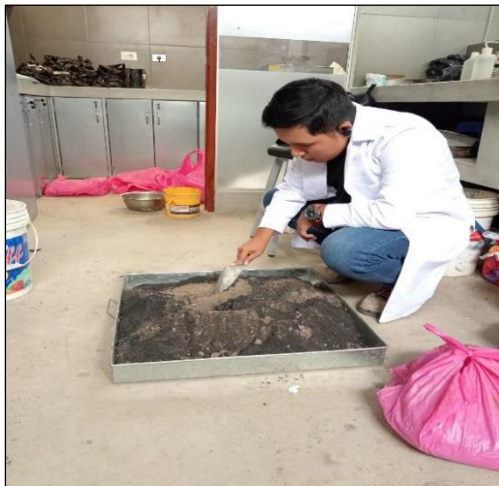
Figura N° 36. Adición del vidrio pulverizado al Suelo Natural. Fuente : Propia
