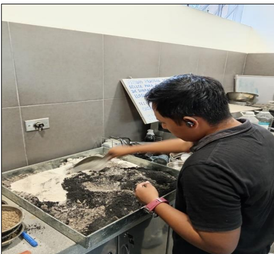
Figura N° 38. Adición del vidrio pulverizado + Ceniza de bagazo al Suelo Natural
