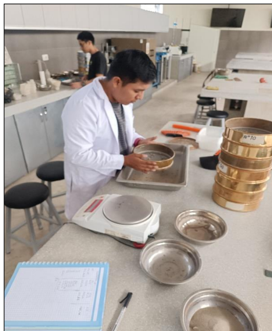
Figura N° 17. Ensayo granulometría por tamizado. Fuente: Propia
