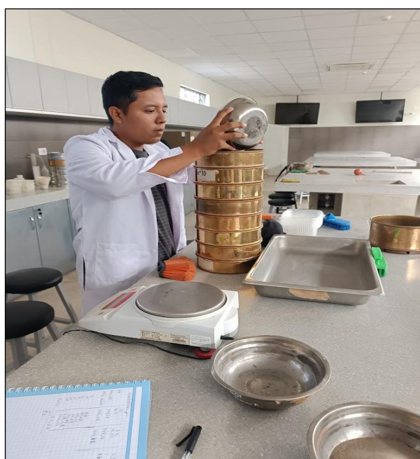
Figura N° 17. Ensayo granulometría por tamizado. Fuente: Propia
