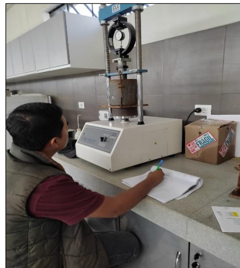
Figura N° 22. Ensayo de CBR. Fuente Propia
