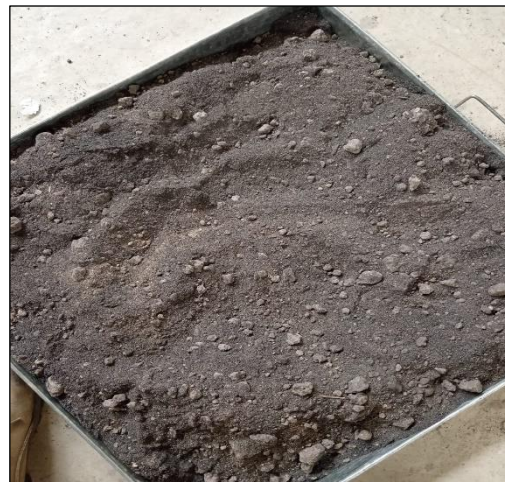
Figura N° 36. Adición del vidrio pulverizado al Suelo Natural. Fuente : Propia
