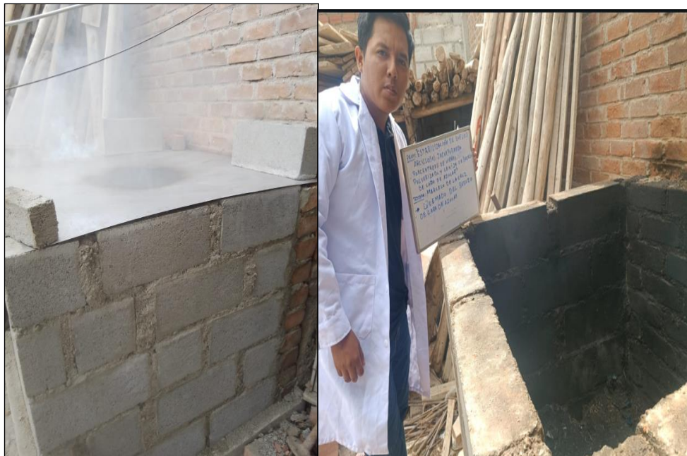
Figura N° 28. Calcinación del bagazo. Fuente : Propia
