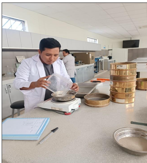
Figura N° 16. Ensayo granulometría, peso de las muestras retenidas. Fuente : Propia
