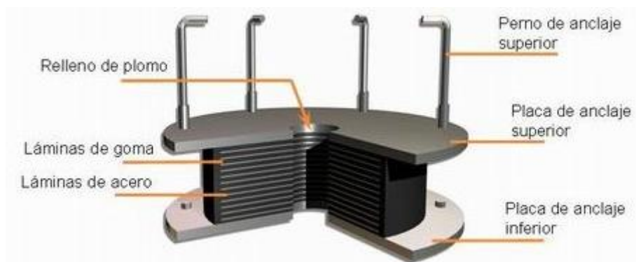
Ilustración 4. Componentes de un aislador elastomérico con núcleo de plomo, LRB
