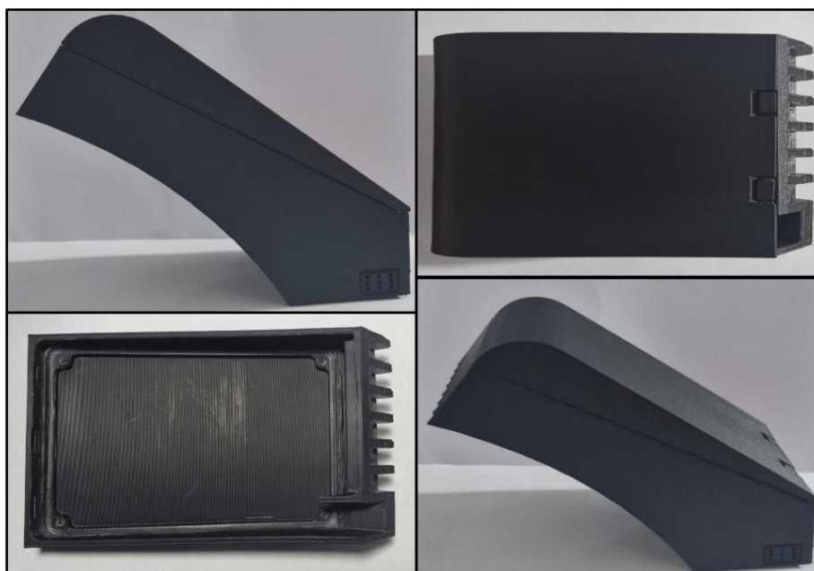
Figura nº39: Cubierta del PCB
