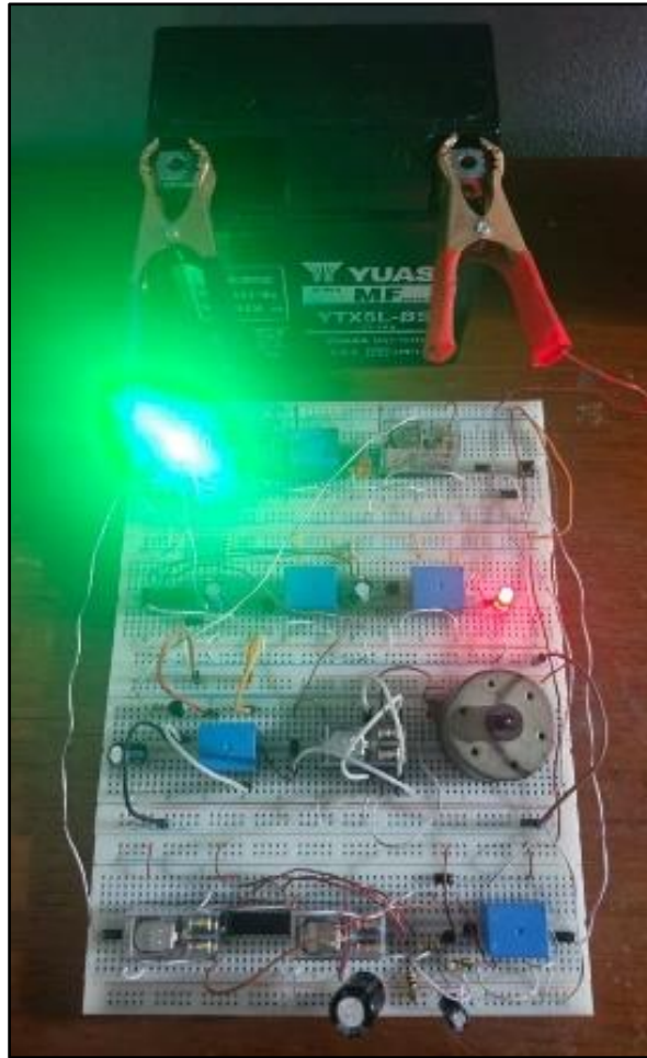
Figura n°27: Prueba del sistema de bloqueo temporal de motor y freno - Encendido
