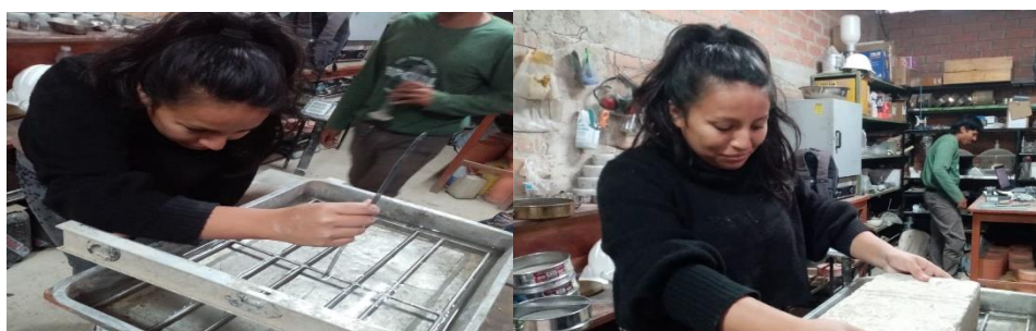
Ilustración 32: Ensayo de succión - nivelación de la bandeja y colocación del bloque en la bandeja con agua
