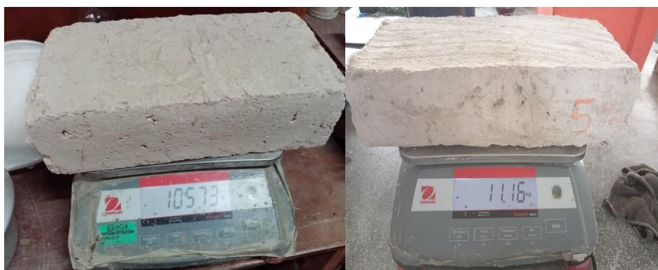
Ilustración 31: Ensayo de succión – peso de los bloques de tierra después de sacar del horno
