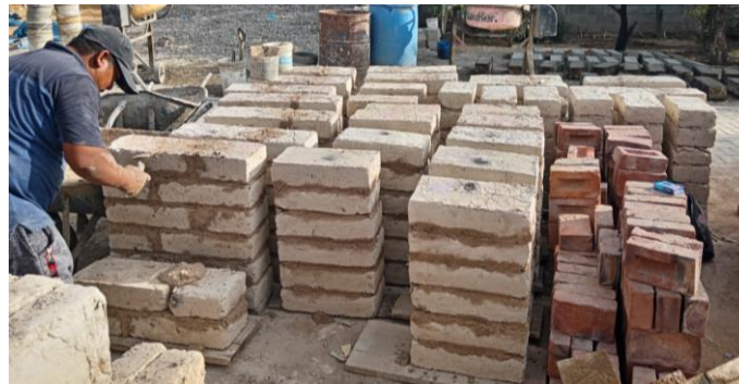
Ilustración 43: Ensayo Resistencia del murete a la compresión – elaboración de pilas
