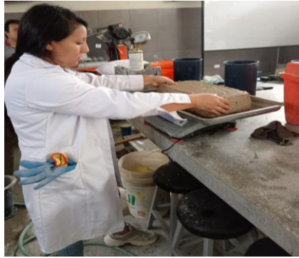
Ilustración 36: Ensayo de absorción - pesado de la muestra después de sacarla del agua
