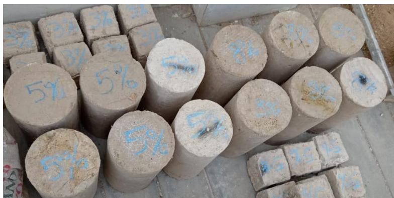
Ilustración 39: Ensayo brasileño de tracción - probetas cilíndricas
