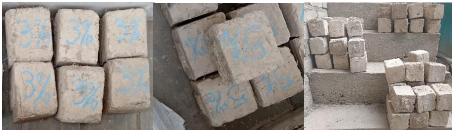
Ilustración 37: Ensayo de compresión del material en cubos - muestras a ensayar
