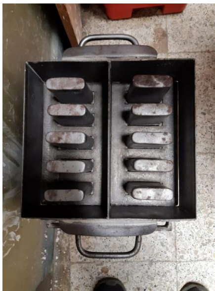
Imagen N° 45 Molde para elaboración de ladrillos de concreto
