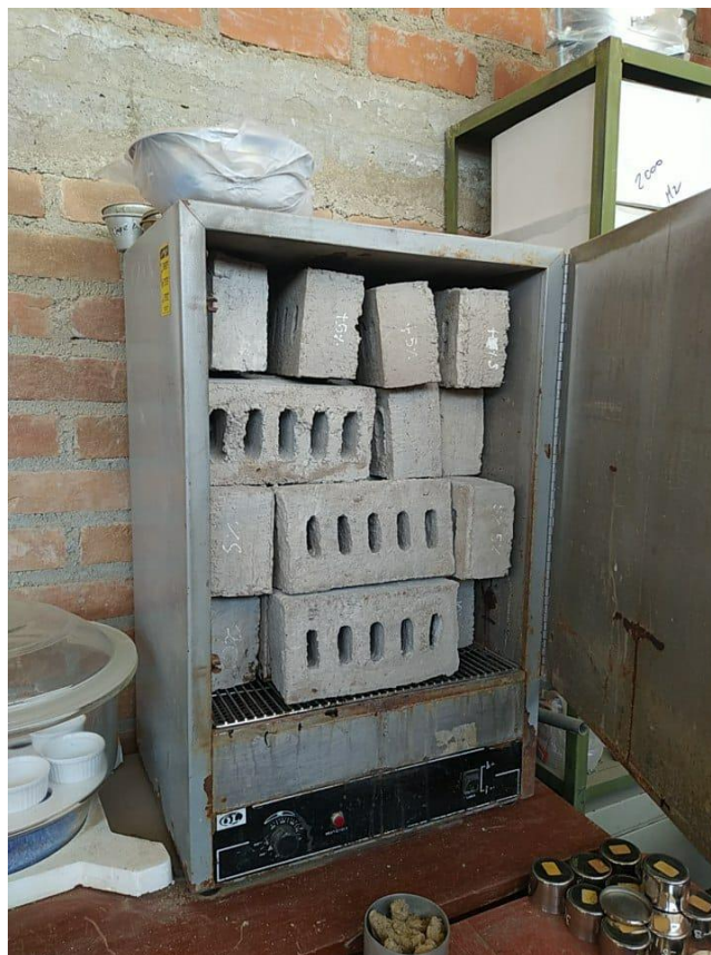
Imagen N° 41 Ladrillo expuesto al calor
